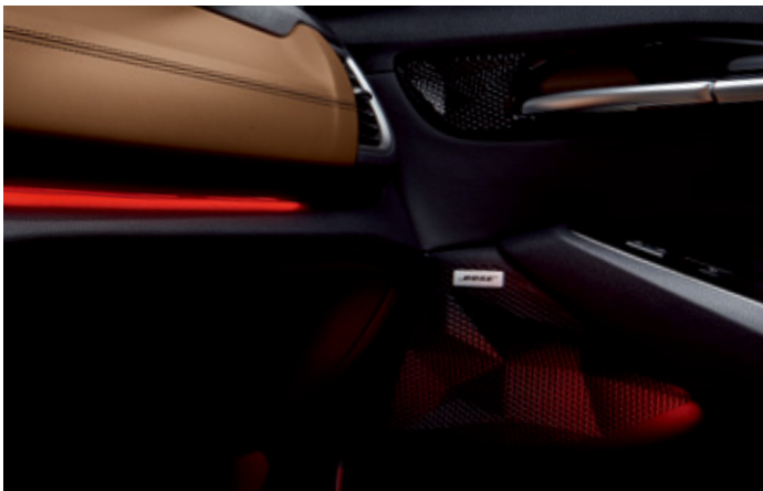
앰비언트 라이트 사운드에 따라 밝기가 변하는 무드 조명을 도어 스피커와 크래쉬 패드 가니쉬에 적용하였습니다.
