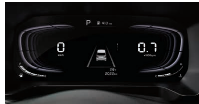
슈퍼비전 클러스터(4.2인치 칼라 TFT LCD)
