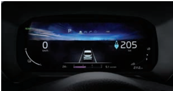
슈퍼비전 클러스터(10.25인치 칼라 TFT LCD)
