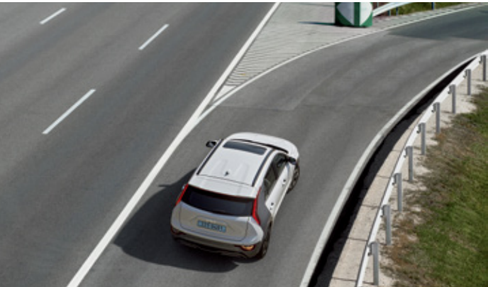
내비게이션 기반 스마트 크루즈 컨트롤 (진출입로) ※ EV 전용 고속도로 및 자동차 전용도로로 진출입로로 주행 시 속도를 적절히 조절하여 안전한 주행을 도와줍니다. 이후 진출입로 구간을 지나면 원래 설정한 속도로 주행합니다.
