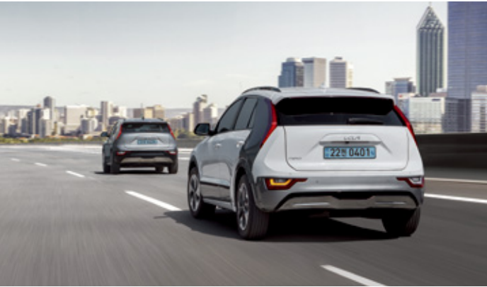
고속도로 주행 보조 2 (차로변경 보조 기능 포함) ※ EV 전용 고속도로 및 자동차 전용도로로 주행 시 앞차와의 거리를 유지하며 운전자가 설정한 속도로 곡선로에서도 차로 중앙을 유지하며 주행하도록 도와줍니다. 주행 중 옆 차량과 가까워지는 경우 위험하지 않도록 차로 내 편향 주행을 합니다. 일정 속도 이상으로 주행 시, 스티어링 휠을 잡고 방향지시등 스위치를 변경하고자 하는 차로 방향으로 움직이면 자동으로 차로를 변경합니다.
