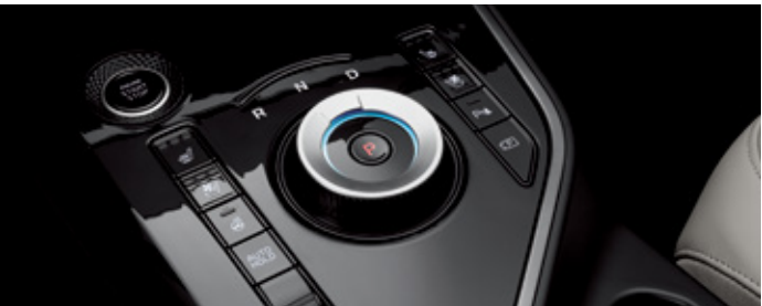
전자식 변속 다이얼 정교한 디테일이 돋보이는 다이얼 타입 전자식 변속기를 적용하여 편안한 그립감과 고급감을 동시에 제공합니다.
