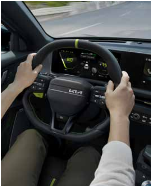
스티어링 휠 그립 감지 운전자가 스티어링 휠을 잡을 때의 전기적 특성을 감지하여 그립 여부를 판단할 수 있는 정전식 센서가 적용되어 더욱 편안한 주행을 경험하실 수 있습니다.
