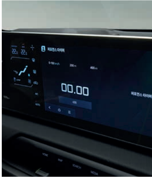
퍼포먼스 타이머 0-100km/h 도달 시간, 200m 돌파 시간, 400m 돌파 시간을 측정할 수 있습니다.
