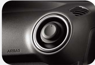
نظام تكييف بوحدات داخل المقصورة قابلة للدوران وتعديل الوجهة بـ 360 درجة
