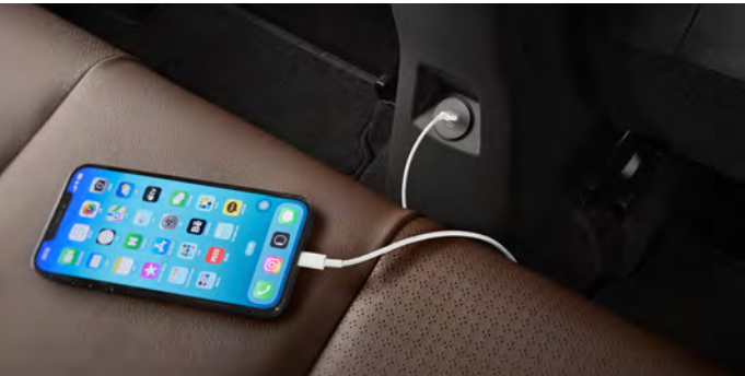
뒷좌석 C타입 USB 단자 (충전용) 슬라이딩 센터 콘솔 암레스트 후면부에 C타입 USB 단자를 적용하여 최신 디바이스와의 호환성을 높였으며, 뒷좌석 탑승객이 편리하게 충전할 수 있도록 하였습니다.
