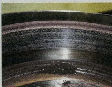
Lewa tylna tarcza hamulcowa: widać, że klocek nie przylegał do niej całą powierzchnią
