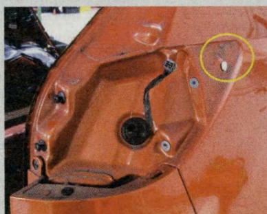
Prawa tylna lampa nie była idealnie spasowana – doszło do niewielkiego uszkodzenia lakieru
