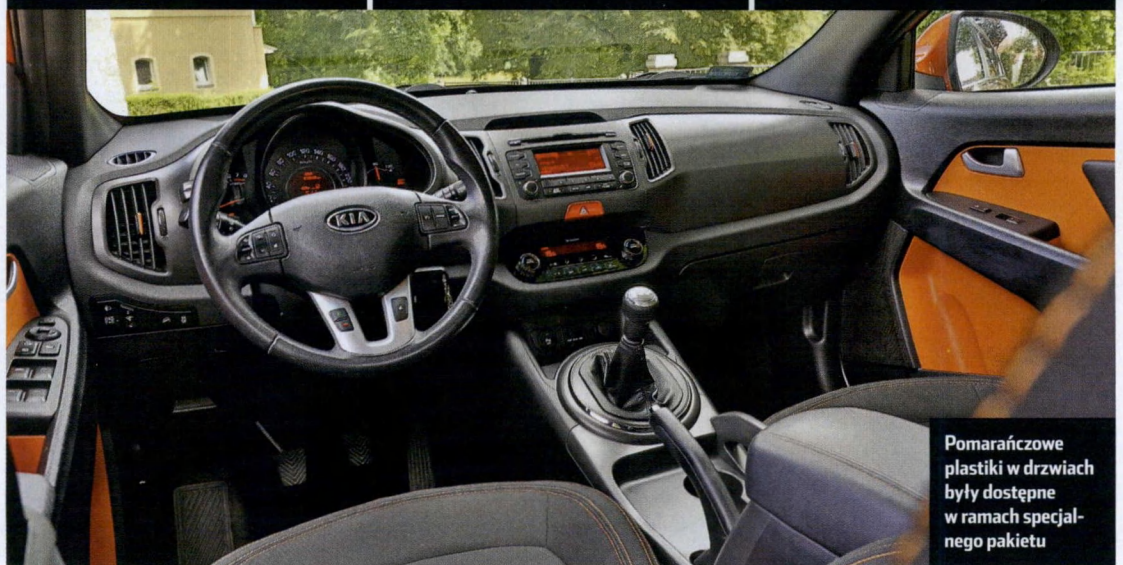
Wyskakujące boczki drzwi to wina zatrzasków, które należy wymienić
