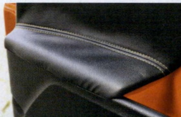
Nawet przy mało intensywnej eksploatacji obicia drzwi mogą się zniekształcać
