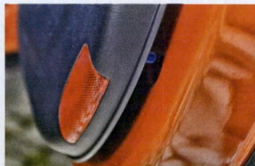
Wyskakujące boczki drzwi to wina zatrzasków, które należy wymienić
