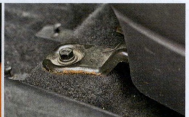
Korozja pojawia się także w kabinie. Najczęściej atakuje mocowania foteli
