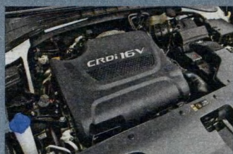
2-litrowa jednostka rozwija 185 KM i 402 Nm przy 1750 obr./min.
