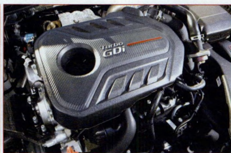
Silnik 2.0 T-GDI ma nie tylko wystarczającą moc (245 KM) ale zapewnia też niskie spalanie
