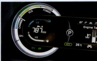
Typowe dla hybryd – zamiast obrotomierza jest wskaźnik gospodarowania energią
