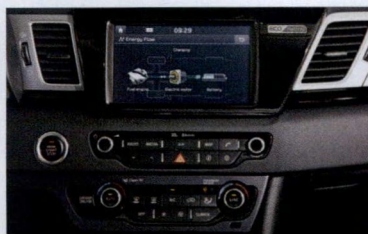
Przepływ energii można oczywiście śledzić na bieżąco podczas jazdy
