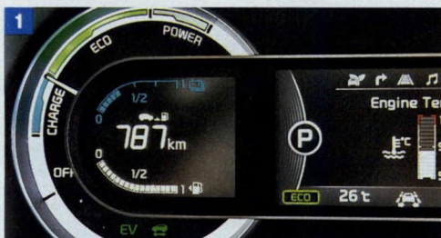
▲ CHARGE, ECO, POWER – na wyświetlaczu widzimy, w jakim stopniu wykorzystujemy napęd hybrydowy.
