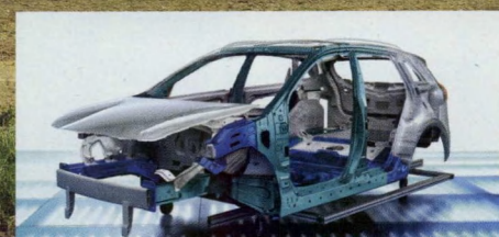
Karoseria Niro korzysta z wysokowytrzymałych stali i aluminium
