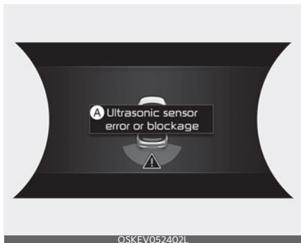
A: Ultrasonisk sensorfeil eller blokkering
