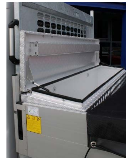
Traanplaat gereedschapskist met schuine klep en dubbele afsluitbare koffer-kruk verbonden met stang.
