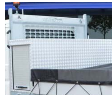
Aluminium tranenplaat opbergkist tussen laadbak en cabine, afsluitbaar d.m.v. aluminium rolluiken met slot.
