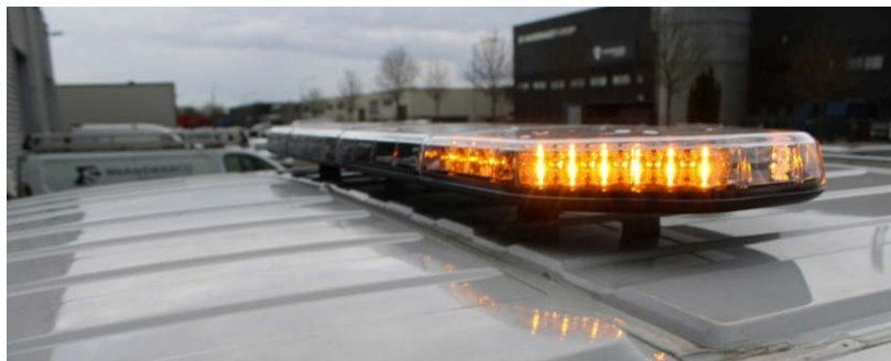
LED-flitslampbalk ECE65 1240mm RWX. 36-LED lampen welke amberkleurig knipperen. Schakelaar op dashboard
