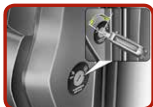
Interruttore ON/OFF air bag frontale del passeggero [3]
