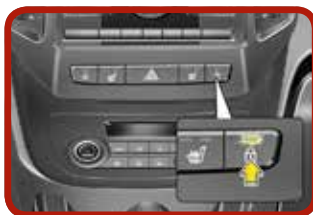
Azionamento delle serrature delle porte dall'interno del veicolo con l'interruttore della chiusura centralizzata [4]
