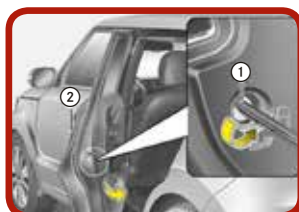
Serratura di sicurezza per bambini sulle porte posteriori [4]
