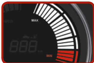
Indicatore stato di carica per batteria ad alta tensione [EV43]
