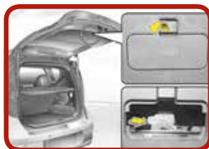
Sistema di sblocco del portellone in caso di emergenza [4]
