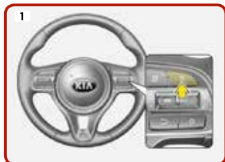
Sistema di regolazione automatica della velocità* [5] Pulsante ON-OFF (CRUISE/RES) per attivare il sistema di regolazione automatica di velocità/Cruise Control
