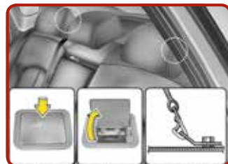
Fissaggio con sistema di "ancoraggio flessibile" [3]
