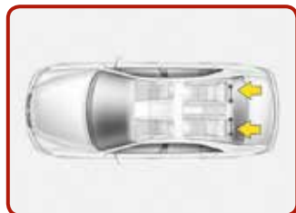
Fissaggio con sistema "ISOFIX" e sistema di "ancoraggio flessibile" [3]
