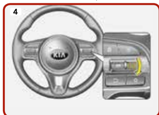
Muovere la leva verso il basso per impostare riduzioni di velocità
