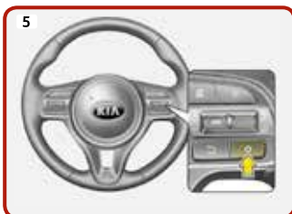
Premere il pulsante di annullamento (CANCEL/O) per ritornare alla velocità di crociera impostata
