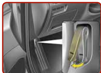
Apertura del cofano [4] Tirare la leva di sblocco per sganciare il cofano.
