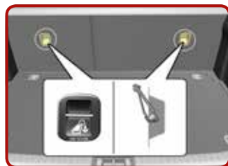
Fissaggio con sistema di "ancoraggio flessibile" [3]
