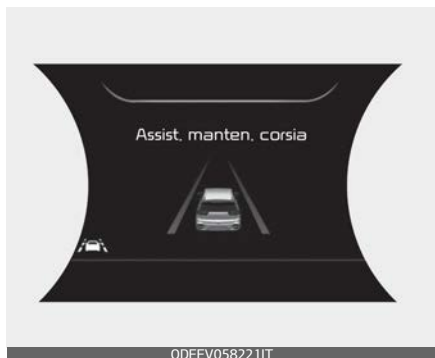
Segnalatore di corsia non rilevato
