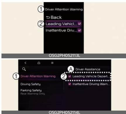
**A: Assistenza conducente****1 Avviso attenzione guidatore****2 Avviso di partenza del veicolo che precede**
