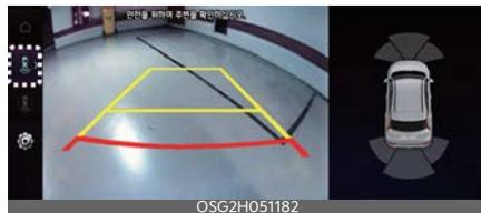
Se **Vista posteriore con guida al parcheggio** è selezionata, le linee guida per il parcheggio della vista posteriore verranno visualizzate sul lato sinistro dello schermo del sistema di infotainment.
