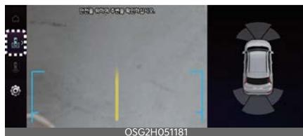
La vista superiore posteriore mostra la vista posteriore superiore del veicolo durante il parcheggio per controllare la distanza tra un oggetto e il veicolo.
