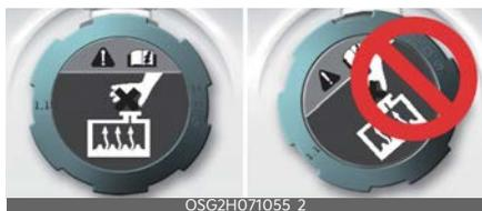
2. Accertarsi che le piccole sporgenze all'interno del tappo del serbatoio liquido refrigerante inverter siano saldamente bloccate.
