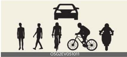
L'illustrazione sopra mostra l'immagine che la telecamera per la visione anteriore e il radar frontale rileverà come veicolo, veicolo a due ruote a motore, pedone e ciclista.
