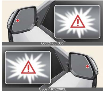
La spia luminosa apparirà nello specchietto retrovisore esterno (specchietto laterale) e sul Head-Up Display (se in dotazione) quando il veicolo su entrambe le corsie viene rilevato dalla parte posteriore.
