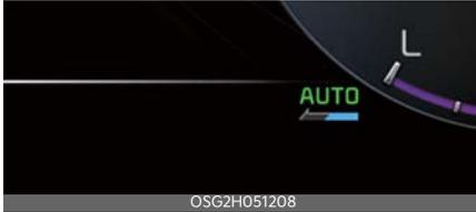
Tuttavia, il livello di frenata rigenerativa del momento si mantiene se il conducente preme il pedale del freno mentre il sistema è in attivazione. Inoltre il sistema si disattiva temporaneamente se si preme il pedale dell'acceleratore.
