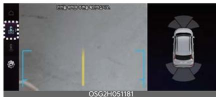
Se **Vista posteriore con guida al parcheggio** è selezionata, le linee guida per il parcheggio della vista dall'alto verranno visualizzate sul lato sinistro dello schermo del sistema di infotainment.
