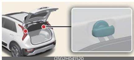
3. Dopo aver tenuto fermo il cavo del copribagagliaio (2), inserirlo nel gancio superiore situato sotto il finestrino posteriore e utilizzarlo per fissarlo.
