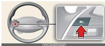
Premere il pulsante di Assistenza alla guida per disattivare il Cruise Control. L'indicatore Cruise (🚗 CRUISE) si disattiverà.
