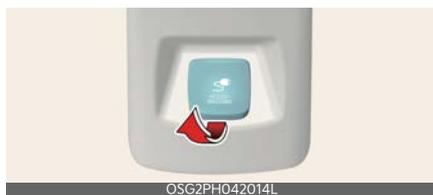
L'inverter AC fornisce 220V/200W o 115V/150W di potenza elettrica per azionare i dispositivi o gli accessori elettrici. Se volete utilizzare l'inverter AC, aprite la copertura dell'inverter e collegatevi una spina. L'inverter CA fornisce corrente elettrica quando il motore è acceso.
