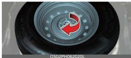
3. Per riporre lo pneumatico procedere in ordine inverso rispetto alla rimozione. Per evitare che la ruota di
