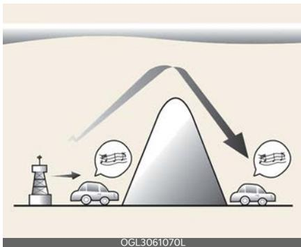
Le trasmissioni in AM si possono ricevere a distanze maggiori rispetto alle trasmissioni in FM. Ciò in quanto le onde radio AM vengono trasmesse in bassa frequenza. Queste onde radio lunghe in bassa frequenza riescono a seguire la curvatura terrestre anziché viaggiare in linea retta nell'atmosfera. Inoltre, aggirando gli ostacoli sono in grado di garantire una migliore copertura del segnale.
