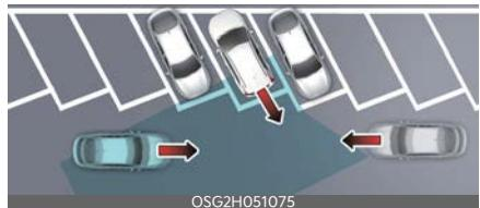
L'Assistenza anti-collisione attraversamento da dietro potrebbe essere limitata quando si arretra in diagonale e potrebbe non rilevare il veicolo in avvicinamento da sinistra o destra. Se questo si verifica, la funzione
