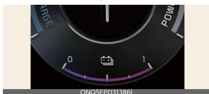
Indica la carica rimanente della batteria del sistema ibrido. Se il SOC è vicino al livello "0 (basso)", il veicolo automaticamente attiva il motore termico per caricare la batteria.
