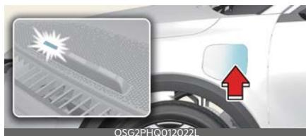
Quando si carica la batteria ad alta tensione, il livello di carica può essere controllato dall'esterno del veicolo.
