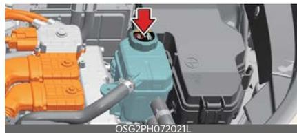
Controllare condizione e collegamenti di tutti i tubi flessibili del sistema di raffreddamento e del riscaldatore. Sostituire ogni tubo flessibile dilatato o deteriorato. Il livello del liquido refrigerante deve trovarsi tra le indicazioni MAX e MIN (F e L) riportate sul lato del serbatoio di espansione, quando il motore è freddo.
