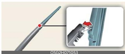
Se la sostituzione è completa, abbassare il braccio del tergicristallo per posizionarlo sul lunotto posteriore e portare il veicolo su ON e azionare i tergicristalli per verificare che la lama sia installata correttamente.
