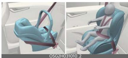
Un seggiolino per bambini rivolto all'indietro svolge la sua funzione di ritenuta avendo la superficie di seduta contro la schiena del bambino. Il sistema d'imbracatura trattiene il bambino in posizione e, in caso d'incidente, agisce in modo da mantenere in posizione il bambino nel seggiolino riducendo le sollecitazioni sul fragile collo e sulla colonna vertebrale del bambino.
