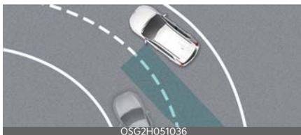
L'Assistenza anti collisione punti ciechi potrebbe non funzionare correttamente percorrendo una strada tortuosa. Il sistema di Assistenza anti collisione punti ciechi potrebbe non rilevare il veicolo nella corsia adiacente.
