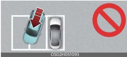
Se si utilizza l'Assistenza di parcheggio intelligente a distanza, quando si parcheggia in un parcheggio con un veicolo solo su un lato, il veicolo può attraversare la linea di parcheggio per evitare il veicolo parcheggiato.
