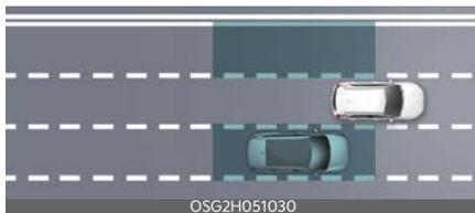
L'Assistenza anti-collisione punti ciechi aiuta a rilevare la presenza di un veicolo nell'angolo cieco e informa il conducente di conseguenza.
