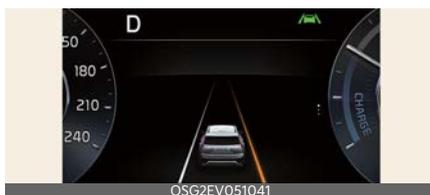
L'Assistenza al mantenimento della corsia invierà un avviso e faciliterà il controllo del veicolo con l'Avviso di uscita di corsia e l'Assistenza al mantenimento della corsia.
