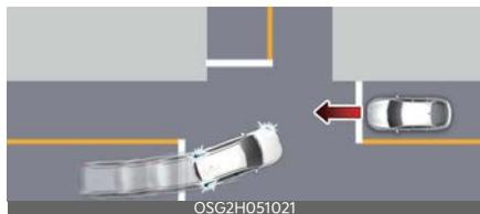
La funzione Svolta a incrocio contribuisce a evitare una collisione con un veicolo in arrivo in una corsia adiacente quando si svolta a sinistra (guida a sinistra) o a destra (guida a destra) in un incrocio con il segnale di svolta acceso, applicando la frenata di emergenza.
