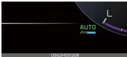
Se il radar frontale riconosce il veicolo davanti, 'AUTO' è visualizzato in verde. Il livello di frenata rigenerativa è controllato in automatico in funzione delle con-
