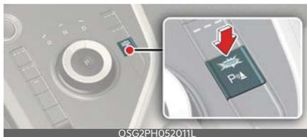
Premere e tenere premuto il pulsante Sicurezza durante il parcheggio (P) per più di 2 secondi, "Assistenza attiva retromarcia" o attivare/disattivare l'Assistenza anti collisione parcheggio.
