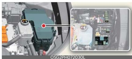
4. Controllare il fusibile rimosso; sostituirlo se è bruciato. I fusibili di scorta si trovano nel pannello fusibili del cruscotto (o in quello del vano motore).
