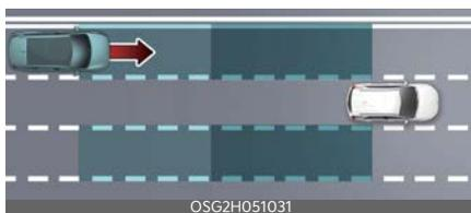
L'Assistenza anti-collisione punti ciechi aiuta a rilevare l'avvicinamento di un ve-
