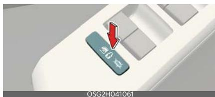
Inoltre, quando il pulsante della serratura di sicurezza per bambini è in posizione LOCK (CHIUSO) e viene individuato un veicolo in avvicinamento dall'area posteriore, il pulsante di bloccaggio di sicurezza delle porte (👤) non si sbloccherà neanche se il guidatore dovesse premere il pulsante, per impedire l'apertura delle porte posteriori.
