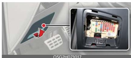
3. Estrarre il fusibile sospetto tenendolo dritto. Usare l'attrezzo estrattore (1) presente sul pannello fusibili vano motore.
