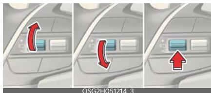
Per riattivare l'Assistente limite di velocità manuale dopo che la funzione è stata messa in pausa, azionare l'interruttore (+), (-), (⏏).
