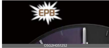
Se l'indicatore di malfunzionamento dell'EPB rimane acceso, appare durante la guida o non appare quando il veicolo è in posizione ON, ciò indica che l'EPB potrebbe non funzionare correttamente. Far ispezionare il veicolo da un'officina specializzata il prima possibile. Kia consiglia di rivolgersi a un concessionario/centro di assistenza partner autorizzato Kia.
