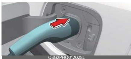
Inserire il caricabatterie nell'entrata di ricarica sino a udire il suono di uno scatto. Una connessione non corretta tra connettore e terminali di carica costituisce un rischio d'incendio.
