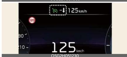
Se il limite di velocità della strada cambia mentre è attivo l'Assistente limite di velocità manuale o lo Smart Cruise Control (Cruise Control intelligente), viene visualizzata una freccia verso l'alto o verso il basso per informare il conducente che la velocità impostata deve essere modificata. Il conducente può quindi modificare la velocità impostata in conformità
