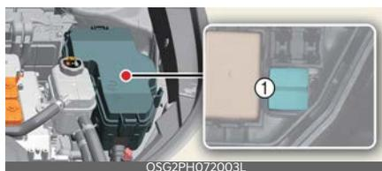
3. Controllare il fusibile rimosso; sostituirlo se è bruciato. Per rimuovere o inserire il fusibile, usare l'estrattore per fusibili che si trova nel pannello fusibili vano motore.
