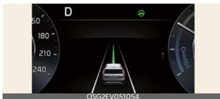
Se viene rilevato il veicolo che precede e/o entrambe le marcature di corsia e la velocità del veicolo è inferiore a 160 km/h (90 mph), la spia verde (ⓐ) appare sul quadro strumenti e la funzione Assistenza centraggio corsia aiuta a centrare il veicolo nella corsia controllando il volante.
