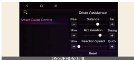
Con il veicolo acceso, toccare **Impostazioni** → **Assistenza conducente** → **Comfort di guida** → **Modalità SCC** sul quadro strumenti, oppure **Impostazioni** → **Veicolo** → **Assistenza conducente** → **Comfort di guida** → **Modalità SCC** sul sistema infotainment per impostare distanza, accelerazione e velocità di reazione.
