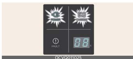
9. Controllare se l'indicatore luminoso di carica della batteria ad alta tensione (🔌) nel quadro strumenti è acceso. La carica non viene eseguita se l'indicatore luminoso (🔌) è spento. Se il connettore di carica non è collegato correttamente, ricollegare il cavo di carica per eseguire nuovamente la carica.
