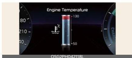
Indica la temperatura del refrigerante a motore in funzione.
