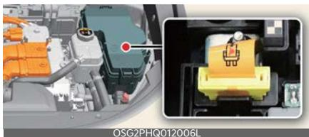
In caso di emergenza, abbassare la leva gialla nel connettore di interblocco di servizio per isolare l'alta tensione della batteria. Connettore di interblocco di servizio non rimosso completamente.
