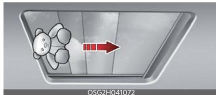
Se il tetto apribile rileva un ostacolo durante la chiusura automatica, invertirà la direzione di movimento e si fermerà in una determinata posizione.
