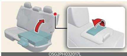
1. Tirando la leva di ripiegamento dello schienale, sollevare e tirare indietro lo schienale. Tirare con forza lo schienale fino a innestarlo a fine corsa.
