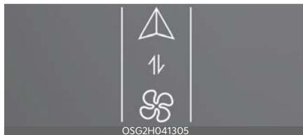
Premere il pulsante sul controllore commutabile per passare dal sistema di infotainment al pannello di controllo della climatizzazione.
