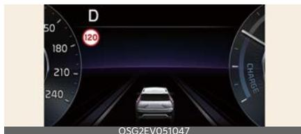
Quando si procede ad una velocità superiore rispetto a quella del limite di velocità visualizzato, apparirà l'indicatore rosso del limite di velocità.
