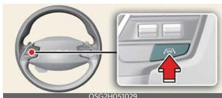
Con il veicolo acceso, premere brevemente il pulsante dell'Assistenza alla guida in corsia sul volante per attivare l'Assistenza al centraggio della corsia. La spia grigia o verde (ⓐ) apparirà sul quadro comandi.
