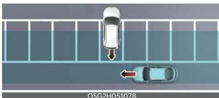
Assistenza anti collisione attraversamento posteriore potrebbe rilevare veicoli che passano dietro al proprio veicolo quando si parcheggia in retromarcia in un parcheggio. Se questo si verifica, la funzione potrebbe avvisare il conducente senza necessità e controllare i freni.
