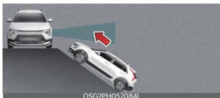
L'Assistenza anti-collisione attraversamento da dietro potrebbe essere limitata quando il veicolo si trova su una pendenza in salita o in discesa e potrebbe non rilevare il veicolo in avvicinamento da sinistra o destra. Se questo si verifica, la funzione potrebbe non avvisare il conducente o controllare i freni quando necessario. Controllare sempre l'area circostante durante la retromarcia.
