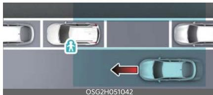
Dopo l'arresto del veicolo, quando viene rilevato un veicolo in avvicinamento dall'area posteriore dopo che un passeggero ha aperto una porta, Avviso per l'uscita sicura dal veicolo avvisa il conducente con un messaggio di avviso e con un messaggio acustico per contribuire a prevenire una collisione.
