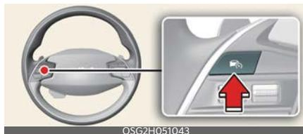
Premere il pulsante dell'Assistenza alla guida (⏏) per disattivare l'Assistente limite di velocità manuale. L'indicatore del limite di velocità (LIMIT) si spegne.
