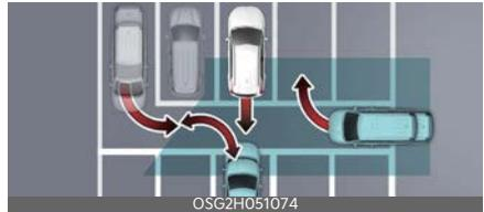
In alcuni casi, Assistenza anti collisione attraversamento posteriore potrebbe non essere in grado di rilevare veicoli che stanno entrando o uscendo dal parcheggio a fianco (ad es. un veicolo che parte dietro al proprio veicolo, un veicolo che entra o esce dal parcheggio nell'area posteriore, che si avvicina svoltando, ecc.).
