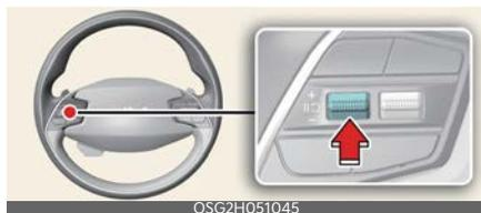
Premere il pulsante (⏏) per mettere temporaneamente in pausa il limite di velocità impostato. Il limite di velocità impostato si disattiverà, ma l'indicatore del limite di velocità (LIMIT) rimarrà acceso.
