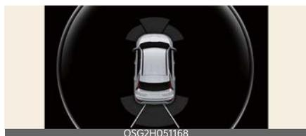
Quando si attiva l'Assistenza anti-collisione parcheggio, una linea appare dietro l'immagine del veicolo nel quadro strumenti.
