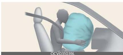
I moduli airbag sono situati sia nel centro del volante che nel pannello lato passeggero anteriore, al disopra del cassetto plancia. Quando la SRSCM rileva un impatto frontale sufficientemente violento, farà automaticamente dispiegare gli airbag frontali.
