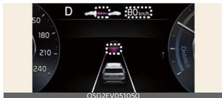
Se si desidera accelerare momentaneamente senza modificare la velocità impostata mentre la modalità SCC attiva, premere il pedale dell'acceleratore. Mentre viene premuto il pedale dell'acceleratore, la velocità, il livello di distanza e la distanza target impostati lampeggeranno sul quadro strumenti.
