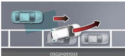
Se si esce da un parcheggio a marcia avanti, se Assistenza anticollisione punti ciechi ritiene che ci sia un rischio di collisione con un veicolo in avvicinamento nell'angolo cieco, la stessa può contribuire ad evitare la collisione frenando.
