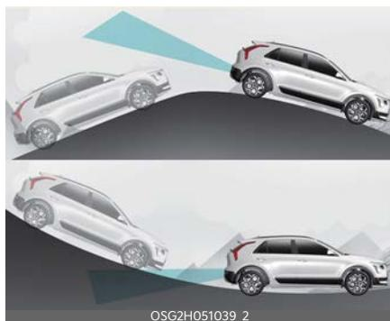
L'Assistenza anti collisione punti ciechi potrebbe non funzionare correttamente percorrendo una pendenza. La funzione potrebbe non rilevare il veicolo nella corsia adiacente o potrebbe rilevare in modo non corretto il suolo o una struttura.
