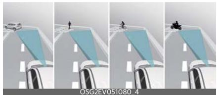
L'Assistenza anti-collisione anteriore potrebbe non rilevare gli altri veicoli, veicoli a due ruote a motore o pedoni che precedono il proprio veicolo quando si guida su strade in curva, compromettendo le prestazioni dei sensori. Questo potrebbe provocare l'assenza di avviso e dell'assistenza alla frenata quando necessario.
