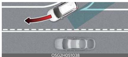
L'Assistenza anti collisione punti ciechi potrà non funzionare correttamente quando la strada confluisce in un'altra strada o si divide. La funzione potrebbe non rilevare il veicolo nella corsia adiacente.
