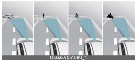
L'Assistenza anti-collisione anteriore potrebbe non rilevare gli altri veicoli, veicoli a due ruote a motore o pedoni che precedono il proprio veicolo quando si guida su strade in curva, compromettendo le prestazioni dei sensori. Questo potrebbe provocare l'assenza di avviso e dell'assistenza alla frenata quando necessario.
