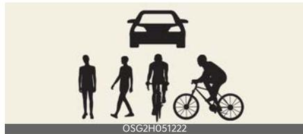
L'illustrazione sopra mostra l'immagine che la telecamera per la visione anteriore e il radar frontale sono in grado di rilevare come veicolo, pedone e ciclista.
