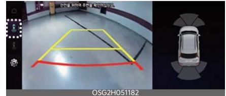
Se **Vista posteriore con guida al parcheggio** è selezionata, le linee guida per il parcheggio della vista posteriore verranno visualizzate sul lato sinistro dello schermo del sistema di infotainment.
