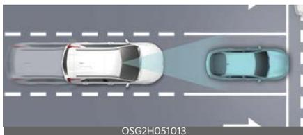
L'Assistenza anti-collisione anteriore è progettata per aiutare a rilevare e monitorare il veicolo che precede o per aiutare a rilevare la presenza di un pedone o di un ciclista sulla carreggiata e allertare il conducente dell'imminenza di una collisione tramite un messaggio di avviso e un segnale acustico e attivare la frenata di emergenza.
