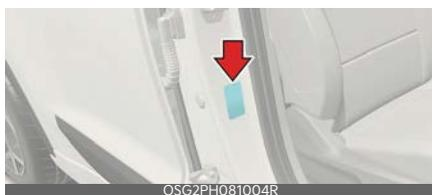
L'etichetta degli pneumatici applicata sul rivestimento esterno del montante centrale, come mostrato, riporta le pressioni di gonfiaggio consigliate per gli pneumatici. Gli pneumatici forniti con il vostro nuovo veicolo sono stati scelti per massimizzare le prestazioni in condizioni d'uso normali.
