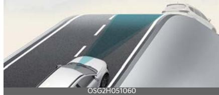
Durante la guida in salita o in discesa, lo Smart Cruise Control (Cruise Control intelligente) potrebbe non rilevare un veicolo in movimento nella vostra corsia e far accelerare il vostro veicolo per raggiungere la velocità impostata. Inoltre, la velocità si ridurrà rapidamente quando viene rilevato improvvisamente il veicolo che precede.
