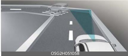
Nelle curve, lo Smart Cruise Control (Cruise Control intelligente) potrebbe non rilevare un veicolo nella stessa corsia, e potrebbe accelerare per raggiungere la velocità impostata. Inoltre, la velocità si riduce rapidamente quando viene rilevato improvvisamente il veicolo che precede.
