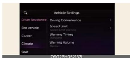
selezionare **Impostazioni** → **Veicolo** → **Assistenza conducente** sullo schermo del sistema infotainment per impostare la funzione di assistenza conducente.
