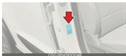
L'etichetta di certificazione/pneumatici si trova sul bordo anteriore del montante "B" destro (o sinistro). L'etichetta mostra le dimensioni degli pneumatici originali e le pressioni di gonfiaggio necessarie per ottenere la capacità di peso lordo del veicolo.
