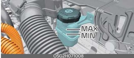
In condizioni di guida normali, il livello del fluido attuatore non diminuisce rapidamente. Tuttavia, il tasso di consumo di olio potrebbe aumentare con l'aumento del chilometraggio e le perdite nelle relative parti dell'attuatore potrebbero causare l'aumento del consumo dell'olio dell'attuatore della frizione del motore. Controllare regolarmente e accertarsi che il livello del fluido olio dell'attuatore della frizione del motore sia compreso tra i segni MIN e MAX.
