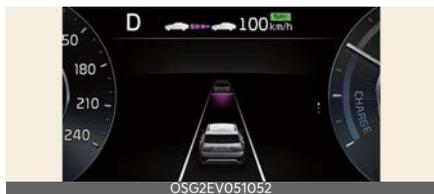
Se è necessaria una decelerazione temporanea nello stato di attesa e lo Smart Cruise Control basato sulla navigazione è in funzione, apparirà il simbolo verde (NAV) sul quadro comandi.
