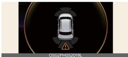
Quando Assistenza anti-collisione parcheggio o altre funzioni correlate non funzionano correttamente, viene visualizzato sul quadro strumenti il messaggio e Assistenza anti collisione parcheggio si disattiva automaticamente. Kia consiglia di rivolgersi a un concessionario/centro di assistenza partner autorizzato Kia.
