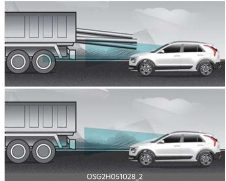
Nei seguenti casi, il sensore non può rilevare il veicolo di fronte. Prestare sempre attenzione alla strada e alle condizioni di guida e guidare in sicurezza. Se necessario, regolare la velocità del veicolo.
