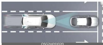
L'Assistenza anti-collisione anteriore è progettata per aiutare a rilevare e monitorare un veicolo che precede o per aiutare a rilevare la presenza di un pedone o di un ciclista sulla carreggiata e allertare il conducente dell'imminenza di una collisione tramite un messaggio di avviso, un segnale e l'attivazione della frenata di emergenza.
