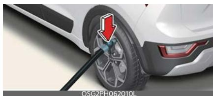
4. Svitare il tappo della valvola e avvitare il tubo di riempimento sulla valvola del pneumatico.
