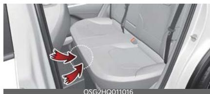
Il condotto di raffreddamento per batteria ibrida si trova sotto i sedili posteriori. Serve a raffreddare la batteria ibrida. Se l'ingresso aria di raffreddamento della batteria ibrida è bloccato, la batteria si potrebbe surriscaldare.
