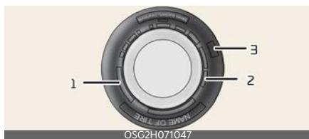
Queste informazioni identificano e descrivono le caratteristiche fondamentali dello pneumatico e forniscono, inoltre, il numero d'identificazione dello pneumatico (TIN) per la certificazione degli standard di sicurezza. Il TIN può essere usato per l'identificazione dello pneumatico in caso di richiamo.
