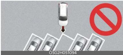
L'Assistenza al parcheggio intelligente a distanza non consente di parcheggiare in diagonale. Anche se il veicolo è stato in grado di entrare nello spazio di parcheggio, non utilizzare l'Assistenza parcheggio intelligente a distanza perché questo non può funzionare correttamente.
