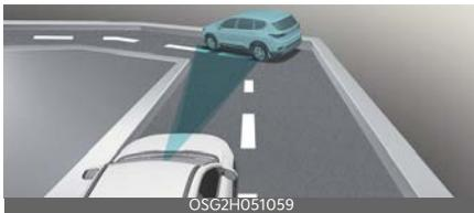
La velocità del vostro veicolo potrebbe diminuire a causa della presenza di un veicolo nella corsia adiacente.
