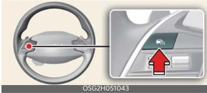
Premere il pulsante di Assistenza alla guida per attivare lo Smart Cruise Control (Cruise Control intelligente). La velocità sarà impostata alla velocità attuale sul quadro strumenti.
