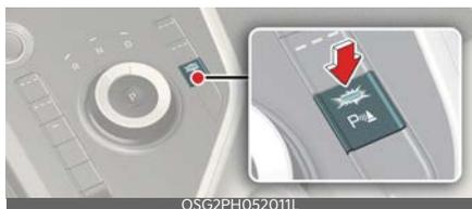
Premere il pulsante Sicurezza durante il parcheggio (P) per attivare o disattivare l'Avviso di distanza di parcheggio in retromarcia.
