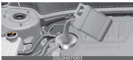
Utilizzare un imbuto per evitare la fuoriuscita di olio sui componenti del motore. Usare esclusivamente l'olio motore specificato. (Fare riferimento a "Lubrificanti raccomandati e capacità" a pagina 9-6).
