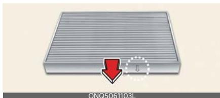
4. Sostituire il filtro aria climatizzatore (3).
