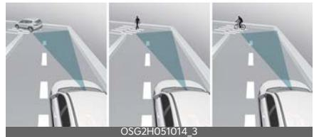
L'Assistenza anti-collisione anteriore potrebbe non rilevare gli altri veicoli o i pedoni che precedono il proprio veicolo quando si guida su strade in curva, compromettendo le prestazioni dei sensori. Questo potrebbe provocare l'assenza di avviso e dell'assistenza alla frenata quando necessario.
