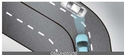
Il sistema di rigenerazione intelligente può riconoscere un veicolo in una corsia adiacente durante la guida su una strada curva. In questo caso il sistema aumenta il livello di frenata e rallenta il veicolo.
