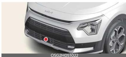
La telecamera anteriore e il radar anteriore vengono usati come sensore per individuare i veicoli di fronte.
