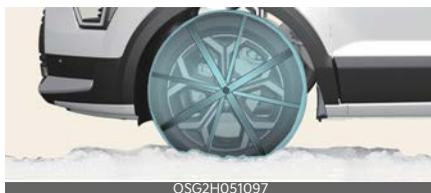
Dato che i fianchi degli pneumatici radiali sono più sottili, l'installazione di alcuni tipi di catene da neve potrebbe danneggiare gli pneumatici. Pertanto è preferibile usare pneumatici da neve anziché catene da neve. Non montare catene per pneumatici su veicoli equipaggiati con ruote in alluminio; le catene da neve potrebbero causare danni alle ruote. Se occorre montare le catene da neve, utilizzare catene di tipo in tessuto o a filo, con uno spessore sia inferiore a 12 mm (0,47 pollici).
