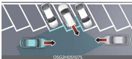
L'Assistenza anti-collisione attraversamento da dietro potrebbe essere limitata quando si arretra in diagonale e potrebbe non rilevare il veicolo in avvicinamento da sinistra o destra. Se questo si verifica, la funzione
