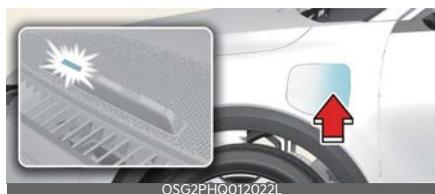
Durante la carica o l'utilizzo (non condizioni di guida) della batteria ad alta tensione è possibile verificarne lo stato di carica dall'esterno del veicolo.
