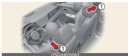
Il vostro veicolo è equipaggiato con cinture di sicurezza con pretensionatore per conducente e passeggero anteriore. Lo scopo del pretensionatore è quello di assicurare che le cinture di sicurezza si stringano saldamente contro il corpo dell'occupante in caso di determinate collisioni.
