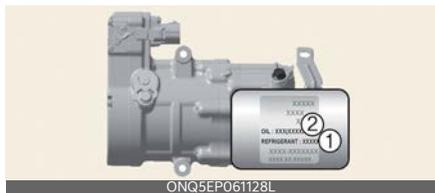
L'etichetta informa sul tipo di compressore installato, il modello, il codice fornitore, il numero di produzione, il refrigerante (1) e l'olio refrigerante (2).
