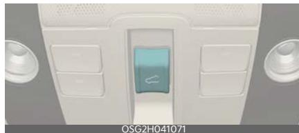
Il tetto apribile può essere utilizzato solo quando l'interruttore di accensione o il pulsante di AVVIAMENTO/ARRESTO MOTORE è in posizione ON o START.
