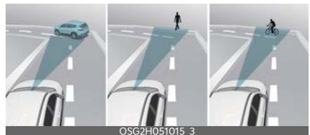
L'Assistenza anti-collisione anteriore può rilevare un veicolo, un pedone o un ciclista nella corsia accanto o fuori dalla corsia quando si percorre una strada in curva.
