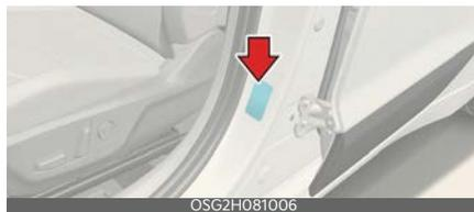
L'etichetta di omologazione del veicolo fissata sul montante centrale, come mostrato, riporta il numero di identificazione del veicolo (VIN).
