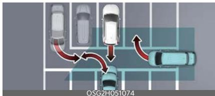
In alcuni casi, Assistenza anti collisione attraversamento posteriore potrebbe non essere in grado di rilevare veicoli che stanno entrando o uscendo dal parcheggio a fianco (ad es. un veicolo che parte dietro al proprio veicolo, un veicolo che entra o esce dal parcheggio nell'area posteriore, che si avvicina svoltando, ecc.).
