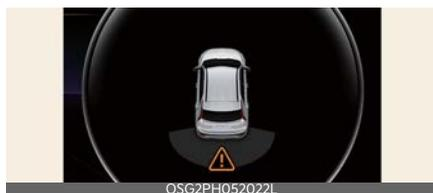
**A:Errore o blocco del sensore a ultrasuoni**
