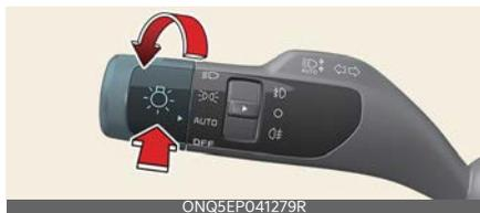
Il sistema di gestione automatica dei fari abbaglianti è una funzione che regola automaticamente la portata dei fari (commutazione tra abbaglianti e anabbaglianti) in base alla luminosità dei veicoli rilevati e a determinate condizioni della strada.
