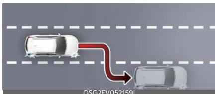
La funzione Assistenza al cambio di corsia in autostrada aiuta a cambiare corsia nella direzione in cui il conducente sposta leggermente l'interruttore dell'indicatore di direzione se la funzione giudica che il cambio di corsia è possibile.
