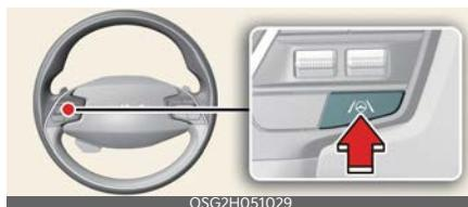
Ogni volta che viene acceso e spento il veicolo, l'Assistenza al mantenimento della corsia si attiverà sempre e sul quadro strumenti si accenderà una spia bianca (/).
