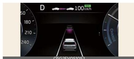
Se è richiesta una decelerazione temporanea nello stato di standby e lo Smart Cruise Control basato sulla navigazione è in funzione, il simbolo verde (**NAV**) si accenderà sul quadro strumenti.
