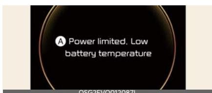
A: Potenza limitata. Bassa temperatura della batteria
