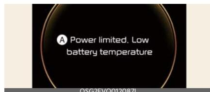
A: Potenza limitata. Bassa temperatura della batteria
