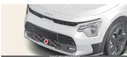
Sensore radar angolare anteriore (se in dotazione)
