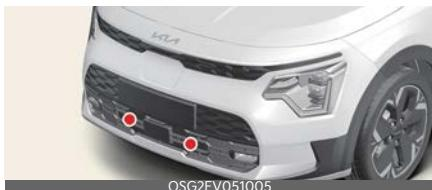
Il sistema aletta aria attiva controlla l'aletta al di sotto del paraurti anteriore per raffreddare le parti del veicolo e per migliorare l'efficienza energetica.
