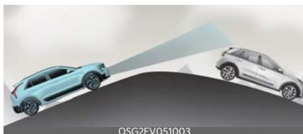
Quando si percorre una discesa o una salita, il sistema potrebbe non rilevare il veicolo nella corsia e il livello di frenata rigenerativa si ridurrebbe automaticamente dando la sensazione che il veicolo stia accelerando.
