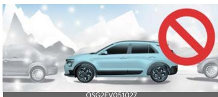
La neve può interferire con il funzionamento dei sensori, oppure il sistema Assistenza parcheggio intelligente a distanza può disattivarsi se la strada è scivolosa durante il parcheggio.
