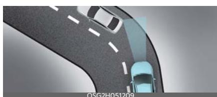
Quando si percorre una curva, il sistema potrebbe non rilevare il veicolo nella corsia e il livello di frenata rigenerativa si ridurrebbe automaticamente dando la sensazione che il veicolo stia accelerando.
