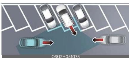
L'Assistenza anti-collisione attraversamento da dietro potrebbe essere limitata quando si arretra in diagonale e potrebbe non rilevare il veicolo in avvicinamento da sinistra o destra. Se questo si verifica, la funzione potrebbe non avvisare il conducente o controllare i freni quando necessario. Controllare sempre l'area circostante durante la retromarcia.
