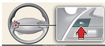
2. Premere il pulsante di Assistenza alla guida alla velocità desiderata. La velocità impostata e l'indicatore Cruise (CRUISE) appariranno sul quadro strumenti.
