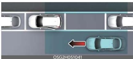
Dopo l'arresto del veicolo, quando viene rilevato un veicolo in avvicinamento dall'area posteriore non appena un passeggero apre una porta, l'Avviso per l'uscita sicura avvisa il conducente con un messaggio di avviso e con un messaggio acustico per contribuire a prevenire una collisione.
