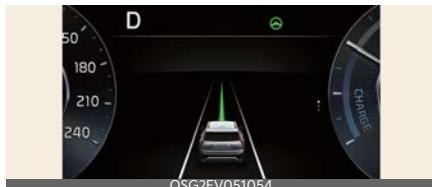
Se viene rilevato il veicolo che precede e/o entrambe le linee di demarcazione della corsia e la velocità di guida è inferiore a 160 km/h (100 mph), sul quadro strumenti viene visualizzata la spia verde (Ⓐ) e il sistema di assistenza centraggio corsia aiuta a centrare il veicolo nella corsia aiutando il volante.
