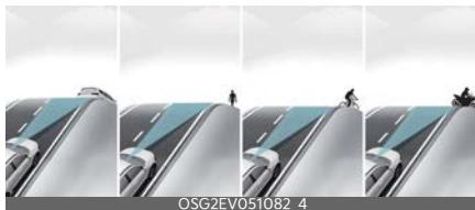
L'Assistenza anti-collisione anteriore potrebbe non rilevare altri veicoli, veicoli a due ruote a motore, pedoni o ciclisti che precedono il proprio veicolo mentre si guida in salita o in discesa, compromettendo le prestazioni dei sensori.
