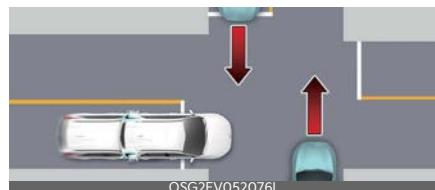
La funzione Attraversamento a incrocio contribuisce a evitare una collisione con veicoli in arrivo sulla sinistra o sulla destra quando si attraversa un incrocio, applicando la frenata di emergenza.
