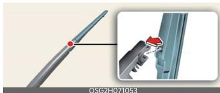
Se la sostituzione è completa, abbassare il braccio del tergilucido per posizionarlo sul lunotto posteriore e portare il veicolo su ON e azionare i tergilucidi per verificare che la lama sia installata correttamente.
