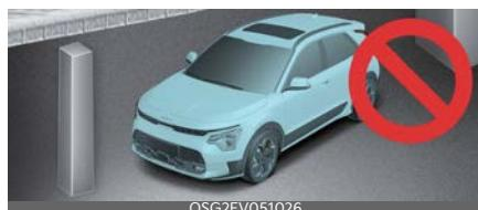
Le prestazioni dell'Assistenza al parcheggio intelligente a distanza possono ridursi o possono verificarsi urti contro un ostacolo in presenza di un oggetto stretto, di un pilastro circolare, quadrato o di un pilastro circondato da oggetti come un estintore, ecc. in prossimità del parcheggio. Il conducente deve parcheggiare il veicolo in modo corretto.
