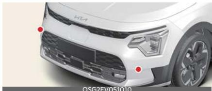
La telecamera anteriore, il radar anteriore e i radar degli angoli anteriori (se in dotazione) sono utilizzati come sensori di rilevamento dei veicoli che si trovano di fronte.
