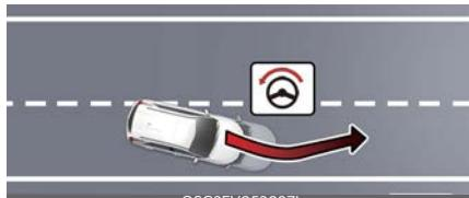
L'Assistenza al mantenimento della corsia è progettata per aiutare a rilevare demarcazioni di corsia (o margini della strada) quando si guida al di sopra di una determinata velocità. Assistenza mantenimento corsia avviserà il conducente se il veicolo abbandona la corsia senza usare l'indicatore di direzione, oppure assisterà automaticamente la sterzata per contribuire a impedire l'uscita del veicolo dalla corsia.
