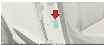
L'etichetta degli pneumatici applicata sul rivestimento esterno del montante centrale, come mostrato, riporta le pressioni di gonfiaggio consigliate per gli pneumatici. Gli pneumatici forniti con il vostro nuovo veicolo sono stati scelti per massimizzare le prestazioni in condizioni d'uso normali.
