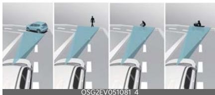
L'Assistenza anti-collisione anteriore può rilevare un veicolo, un veicolo a due ruote a motore, un pedone o un ciclista nella corsia accanto o fuori dalla corsia quando si percorre una strada in curva.
