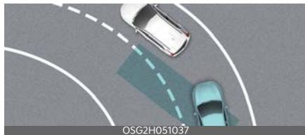
L'Assistenza anti collisione punti ciechi potrebbe non funzionare correttamente percorrendo una strada tortuosa. Il sistema di Assistenza anti collisione punti ciechi potrebbe rilevare il veicolo nella stessa corsia.
