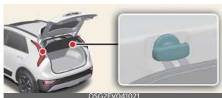
3. Dopo aver tenuto fermo il cavo del copribagagliaio, inserirlo nel gancio superiore situato sotto il finestrino posteriore e utilizzarlo per fissarlo.
