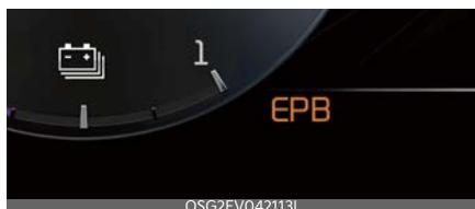
Se la spia di malfunzionamento EPB rimane accesa, si accende durante la guida o non si accende quando il veicolo è in posizione ON, ciò indica che l'EPB potrebbe essere malfunzionante.
