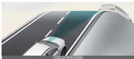
Durante la guida in salita o in discesa, lo Smart Cruise Control (Cruise Control intelligente) potrebbe non rilevare un veicolo in movimento nella vostra corsia e far accelerare il vostro veicolo per raggiungere la velocità impostata. Inoltre, la velocità si ridurrà rapidamente quando viene rilevato improvvisamente il veicolo che precede.
