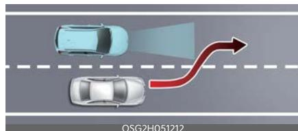
Quando un veicolo che precede cambia corsia, il sistema di rigenerazione intelligente può non rilevare immediatamente tale veicolo, specialmente se il cambio corsia viene effettuato in modo brusco. In questo caso, occorre mantenere uno spazio di frenata sicuro e, se necessario, premere il pedale del freno per ridurre la velocità, al fine di mantenere la distanza di sicurezza.
