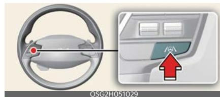
Con il veicolo acceso, premere brevemente il pulsante dell'Assistenza alla guida in corsia sul volante per attivare l'Assistenza al centraggio della corsia. La spia grigia o verde (Ⓐ) apparirà sul quadro strumenti.
