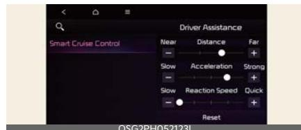
Con il veicolo acceso, selezionare **Impostazioni** → **Assistenza conducente** → **Comfort di guida** → **Smart Cruise Control** sul quadro strumenti o **Impostazioni** → **Veicolo** → **Assistenza conducente** → **Comfort di guida** → **Smart Cruise Control** sul sistema di infotainment per impostare la distanza, l'accelerazione e la velocità di reazione.
