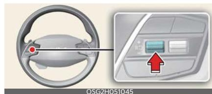
Premere il pulsante (ii○) per mettere temporaneamente in pausa il limite di velocità impostato. Il limite di velocità impostato si disattiverà, ma l'indicatore del limite di velocità (LIMIT) rimarrà acceso.
