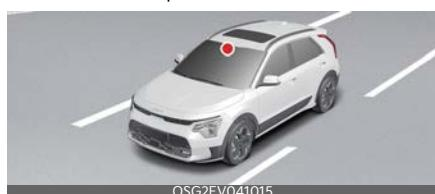
La telecamera anteriore è utilizzata come sensore di rilevamento per individuare gli schemi di guida e la partenza del veicolo di fronte, con il veicolo in marcia.
