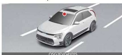
La camera per la visione anteriore viene utilizzata come un sensore di rilevamento per rilevare la luce e la luminosità dell'ambiente durante la guida. Si rimanda all'immagine precedente per la posizione precisa del sensore di rilevamento.
