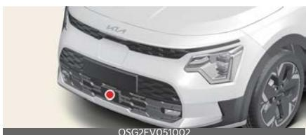
Sensore radar angolare anteriore (se in dotazione)
