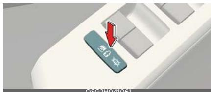
Quando il pulsante del blocco elettronico di sicurezza bambini è in posizione LOCK e viene rilevato un veicolo in avvicinamento dalla zona posteriore, il pulsante del blocco elettronico di sicurezza bambini (👶) non si sblocca anche se il conducente preme il pulsante per impedire l'apertura delle porte posteriori.
