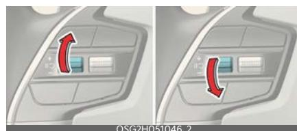
Per riattivare l'Assistente limite di velocità manuale dopo che la funzione è stata messa in pausa, azionare l'interruttore (+), (-), (ii○).
