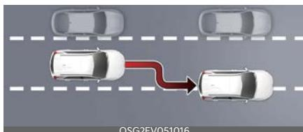
Quando la velocità del veicolo è superiore a 60 km/h (40 mph), se un veicolo circostante si trova a una distanza ravvicinata, il veicolo controllerà lo sterzo nella direzione opposta a quella del veicolo per facilitare una guida sicura. Se su entrambi i lati della corsia sono presenti veicoli che guidano in prossimità, la funzione non devierà sul lato opposto della corsia.
