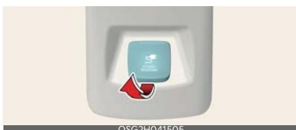
L'inverter CA fornisce 220V/200W di potenza elettrica per azionare i dispositivi o gli accessori elettrici. Se volete uti-
