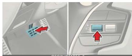
Premere l'interruttore (●) o premere il pedale del freno per disattivare temporaneamente lo Smart Cruise Control.
