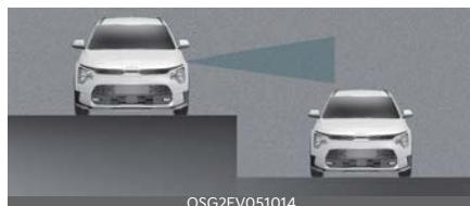
L'Assistenza anti collisione punti ciechi potrebbe non funzionare correttamente quando si guida dove l'altezza delle corsie è diversa. La funzione potrebbe non rilevare il veicolo su una strada con altezze di corsia differenti (giunzioni di sottopassaggi, intersezioni separate in pendenza, ecc.).
