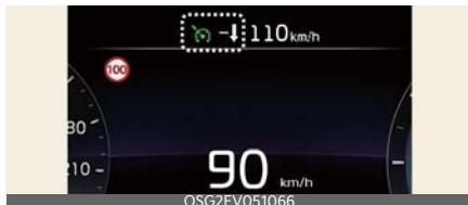
Se il limite di velocità della strada cambia mentre è attivo l'Assistente limite di velocità manuale o lo Smart Cruise Control (Cruise Control intelligente), viene visualizzata una freccia verso l'alto o verso il basso per informare il conducente che la velocità impostata deve essere modificata. Il conducente può quindi modificare la velocità impostata in conformità al limite di velocità utilizzando i pulsanti (+) o (-) sul volante.
