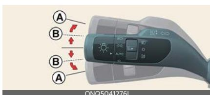
La funzione di Assistenza al cambio di corsia in autostrada sarà operativa quando viene premuta la leva dell'indicatore in posizione A o B, mentre la funzione è in stato "Pronto" (l'indicatore (↗↖) è verde) e sono soddisfatte tutte le seguenti condizioni:
