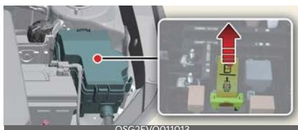
In caso di emergenza, abbassare la leva gialla dell'interruttore di spegnimento ad alta tensione per spegnere la batteria.
