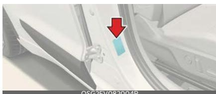
L'etichetta di omologazione del veicolo fissata sul montante centrale, come mostrato, riporta il numero di identificazione del veicolo (VIN).
