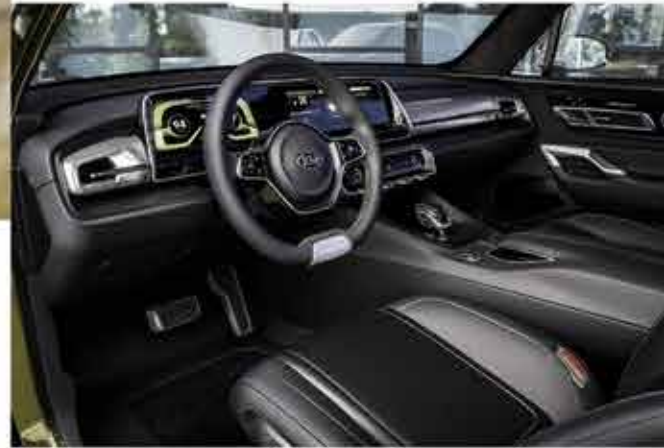
3D nyomtatóval készült a kormány, a műszerfal és az összes ajtópanel. A műszereknél grafikusán és számokkal is informál a vetített kijelző, a légkondicionáló a szellőzőkbe épített érintőfelületen is beállítható, nem csak a középkonzolon. A kormány gombjai szintén érintésre működnek
