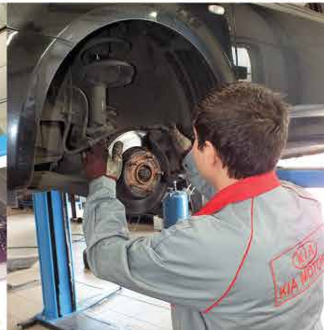
A futómű ellenőrzése kiemelten fontos feladat, a rossz magyar utak miatt egy újszerű autónál is előfordulhatnak nem várt elállítódások, kopások; ha ezekkel nem foglalkozunk, komolyan romolhat a menetbiztonság
