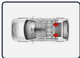
Turvaistuimen kiinnittäminen "ISOFIX-järjestelmällä" ja "ylähihna-kiinnitysjärjestelmällä" [3]
