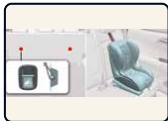
Lasten turvaistuimen kiinnittäminen "ylähihna-kiinnike"-järjestelmällä [4]
