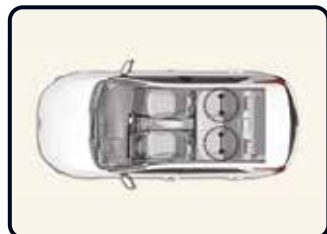
ISOFIX-kiinnityspiste ja yläkiinnityspiste (ISOFIX-kiinnitysjärjestelmä) lapsille [4]
