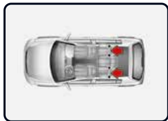
"ISOFIX"-kiinnityspisteet ja varmistus yläkiinnityshihnalla [3]
