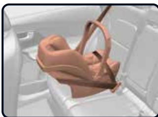
Selkä menosuuntaan asennettava lapsen turvaistuin [3]
