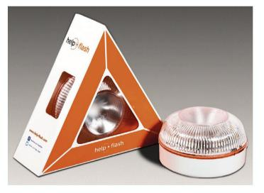
Luz de emergencia Help Flash. Dispositivo de señalización luminosa de emergencia que se enciende de forma automática al adherirse magnéticamente sobre las partes metálicas de la carrocería. También se puede activar de forma manual girando su base. Visibilidad hasta 1 km y además sirve de linterna.
