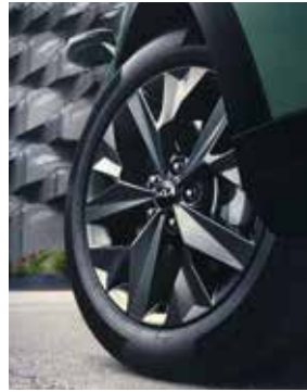
Llanta de aleación de 18", tipo B. Grafito, 7.5Jx18, adecuada para neumáticos 235/55 R18. 52910R2260PAC (Exclusiva para GT-line)
