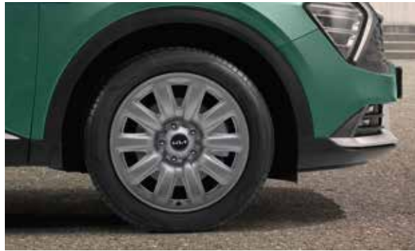
Llanta de acero de 17". Grafito claro, 7.0Jx17, adecuada para neumáticos 215/65 R17. Idónea para el invierno. Tapa incluida. Se pueden usar las tuercas originales. R2401ADE07
