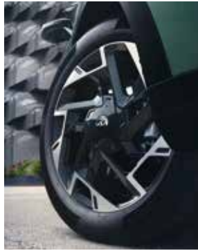
Llanta de aleación de 19", tipo A. Bicolor, 7.5Jx19, adecuada para neumáticos 235/50 R19. 52910R2300PAC (Exclusiva para GT-line)
