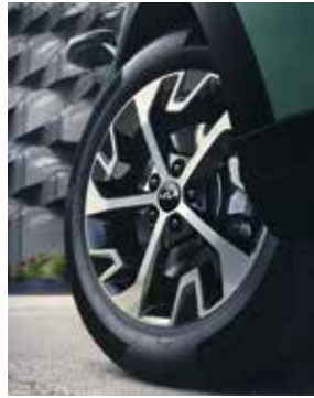
Llanta de aleación de 18", tipo A. Bicolor, 7.5Jx18, adecuada para neumáticos 235/55 R18. 52910R2200PAC
