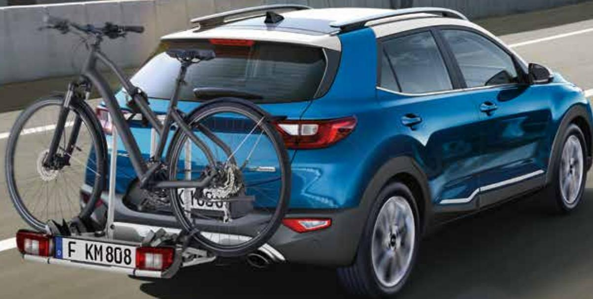
**Enganche de remolque desmontable.** Este enganche de remolque de gran calidad, fabricado en acero resistente a la corrosión, es ideal si necesitas transportar mucha carga. Gracias al sistema bloqueo de 3 bolas es fácil de desmontar, seguro y discreto. Consulta en tu concesionario la capacidad máxima de remolque de tu vehículo.
