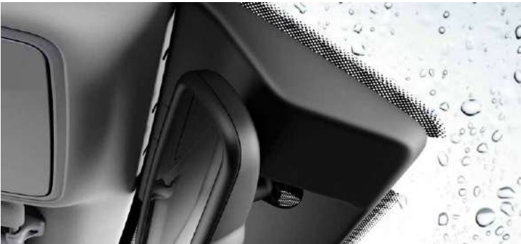
Sensor de lluvia. Cuando detecta gotas en el cristal, el sensor de lluvia activa los limpiaparabrisas según corresponda. (según versiones).
