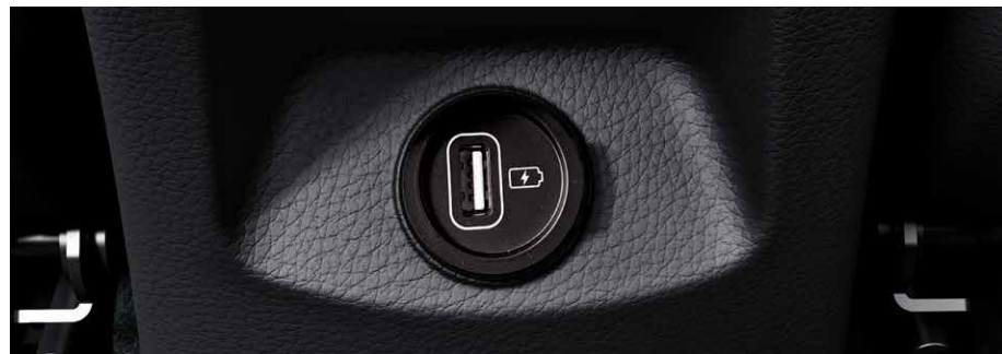
Cargador USB en las plazas traseras. Una clavija USB en la parte posterior del reposabrazos central permite también a los pasajeros de la parte trasera cargar sus dispositivos (según versiones).
