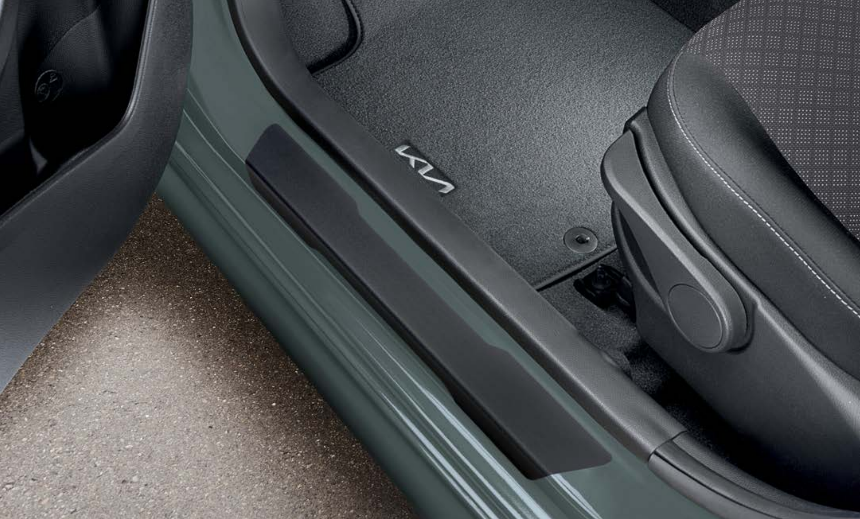
Lámina adhesiva de protección para umbrales de puerta, negra. 1Y451ADE00BL
