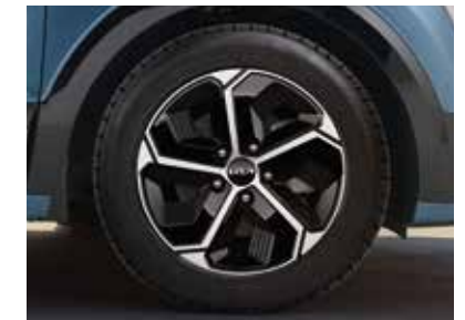
Llanta de aleación de 16", Tipo A. 6.5Jx16, adecuada para neumáticos 205/60 R16. Incluye una tapa y cinco tuercas. ATF40AK000 (bicolor, HEV/PHEV)
