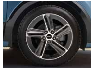
Llanta de aleación de 18", Gasan. 7.5Jx18, adecuada para neumáticos 225/45 R18. Tapa incluida. Se pueden usar las tuercas originales. AT400ADE08BC (bicolor, HEV/PHEV)
