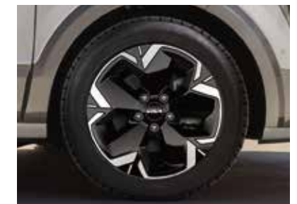
Llanta de aleación de 17", Tipo A. 7.0Jx17, adecuada para neumáticos 215/55 R17. Incluye una tapa y cinco tuercas. AOF40AK000 (bicolor, EV)
