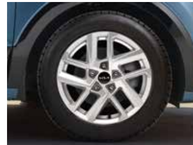
Llanta de aleación de 16", Gaya. 6.5Jx16, adecuada para neumáticos 205/60 R16. Tapa incluida. Se pueden usar las tuercas originales. AT400ADE06 (color plata, HEV/PHEV)
