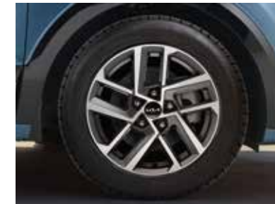
Llanta de aleación de 16", Gaya. 6.5Jx16, adecuada para neumáticos 205/60 R16. Tapa incluida. Se pueden usar las tuercas originales. AT400ADE06BC (bicolor, HEV/PHEV)
