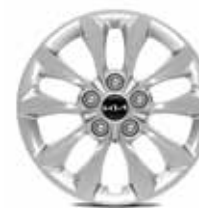
Llanta de acero y tapacubos de 15". 6.0Jx15, adecuada para neumáticos 195/65 R15. Idónea para usar con neumáticos de invierno. 52910G4000PAC (llanta de acero, solo para vehículos con medida original en 15", no se muestra). 52970J7000 (tapacubos, pieza individual).
