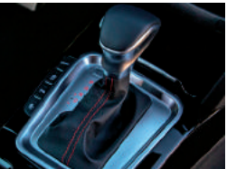
Das DKG verwaltet sieben Gänge (sechs im Plug-in-Hybrid) mit recht viel Gefühl
