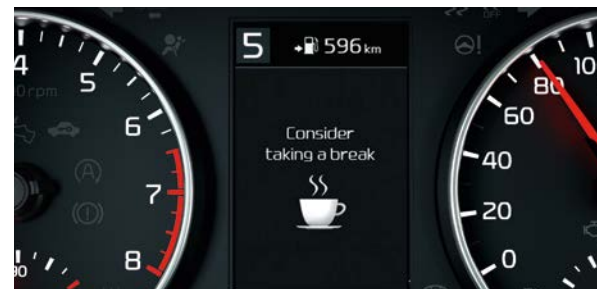
Müdigkeitswarner AA . Der Müdigkeitswarner (Driver Attention Warning, DAW) analysiert ständig verschiedene Fahrzeugparameter wie die Betätigung von Lenkrad und Blinker. Erkennt das System bei dir Zeichen von Erschöpfung, weist es dich durch einen Warnton und eine Anzeige in der Instrumenteneinheit darauf hin.
