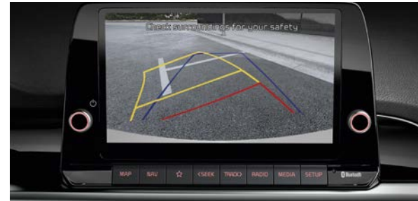
Rückfahrkamera mit dynamischen Hilfslinien A . Beim Rückwärtsfahren erscheinen auf dem Touchscreen* des Audio- oder Navigationssystems die Kamerabilder inklusive Hilfslinien, die dir das Manövrieren erleichtern.
