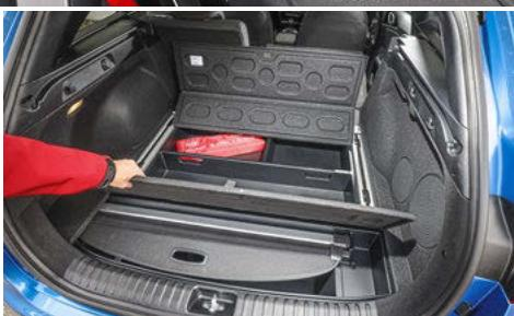
**DAS SCHIENENSYSTEM** dient der Arretierung von Gepäckstücken. Der Kofferraumboden ist zwar nicht in der Höhe verstellbar, lässt sich aber aufstellen. Darunter stecken recht tiefe, voneinander abgetrennte Ablagefächer. Auch im Kia gibt es noch einige Tasten, etwa um Assistenzsysteme abzuschalten oder die elektrische Kofferraumklappe zu steuern. Auch hier gilt: Eine Durchlade wäre schön ...
