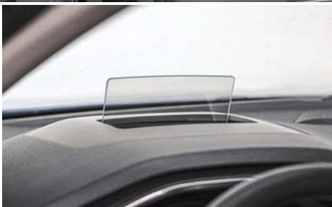
**DIE TÜRKANTENSCHONER** fahren beim Öffnen mechanisch aus, die Kunststoffscheibe des Head-up-Displays elektrisch. Die Infos darauf sind dank guter Positionierung leicht ablesbar – wenn auch nicht so komfortabel wie bei Windschutzscheiben-Projektion. Die Bedienung erfolgt läblicherweise noch an vielen Stellen über echte Tasten. Was fehlt? Eine Durchladeöffnung in der Mitte der Rücklehne
