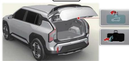
Abdeckung unten an der Heckklappe abnehmen und Riegel in Pfeilrichtung schieben, um die Heckklappe zu entriegeln.
