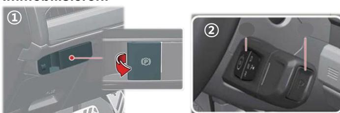
① Räder verkeilen und elektronische Parkbremse betätigen, um die Feststellbremse einzulegen.
