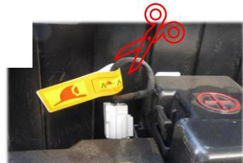
Kabel des Wartungsverriegelungssteckers durchtrennen, um das Hochvoltsystem zu deaktivieren.
