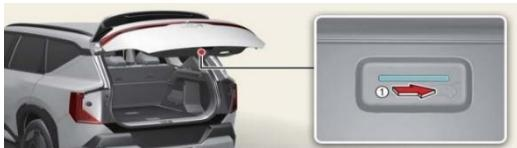
1. Einen langen, flachen Gegenstand (z. B. einen Schraubenzieher) in die Öffnung an der Unterseite der Heckklappe einführen.
