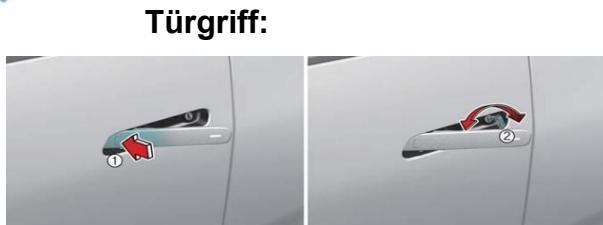
Vorderen Teil des Türgriffs drücken, um den hinteren Teil herauszuziehen. Mit dem Schlüssel entriegeln und dann am Griff ziehen, um die Heckklappe zu öffnen.
