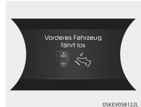
Wenn der Fahrer nach dem Losfahren des vor ihm stehenden Fahrzeugs nicht innerhalb einer bestimmten Zeit reagiert, wird die Meldung auf dem Kombiinstrument angezeigt.
