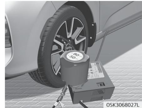
Mit dem Reifen-Mobilität-Kit (TMK, Tire Mobility Kit) bleiben Sie auch nach einer punktuellen Reifenpanne mobil. Das aus einem Kompressor und Dichtmittel bestehende System dichtet effektiv und bequem die meisten punktuellen Undichtigkeiten von PKW-Reifen ab, die durch Nägel oder ähnliche Gegenstände hervorgerufen wurden, und es pumpt den Reifen auf.
