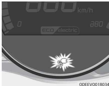
7. Überprüfen Sie, ob die Kontrollleuchte für den Anschluss des Ladekabels der Hochvolt-Batterie im Kombiinstrument leuchtet. Der Ladevorgang beginnt erst, wenn die Ladekontrollleuchte leuchtet. Wenn der Ladestecker nicht richtig angeschlossen ist, schließen Sie das Ladekabel zur Aufladung erneut an.
