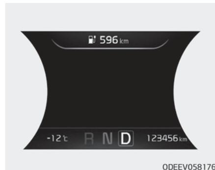
Wenn sich der Knopf **START/STOPP** (Motorstart/-stopp) in der Stellung **ON** (Ein) befindet, zeigen die Kontrollleuchten im Kombiinstrument die Stellung des Wählhebels an.
