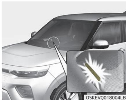
Beim Laden der Hochvolt-Batterie kann der Ladestatus von der Fahrzeugaußenseite aus geprüft werden.
