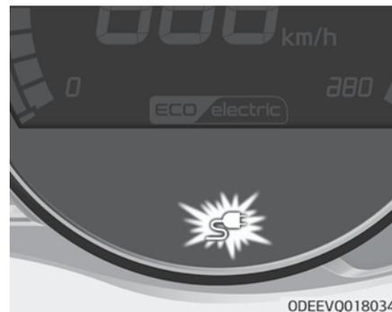
8. Überprüfen Sie, ob die Kontrollleuchte für den Anschluss des Ladekabels der Hochvolt-Batterie im Kombiinstrument leuchtet. Die Auf-
