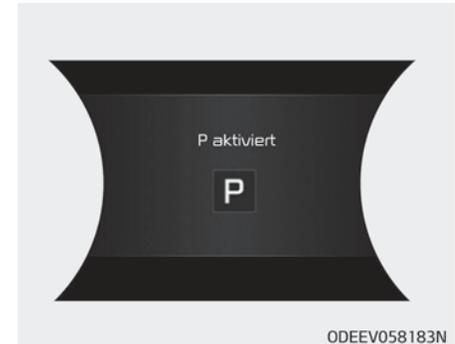
Die Meldung erscheint auf dem LCD-Display, wenn der Wahlhebel in die Position P (Parkstufe) gebracht wird.
