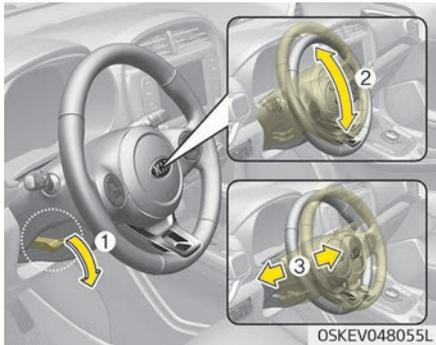
Um die Lenkradstellung zu verändern, ziehen Sie den Sicherungshebel (1) nach unten, bringen Sie das Lenkrad in den gewünschten Winkel (2) und in die gewünschte Höhe (3) und klappen Sie danach den Sicherungshebel (4) wieder nach oben, um die Lenksäule zu fixieren. Bringen Sie die Lenksäule immer vor Fahrtantritt in die gewünschte Stellung.
