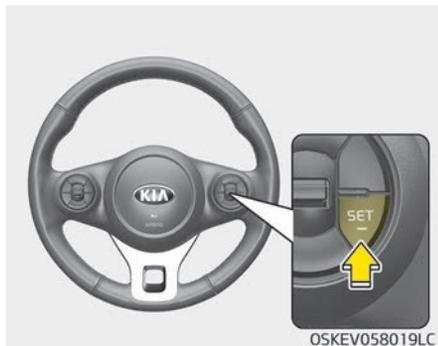
3. Drücken Sie den Hebel nach unten (in Richtung SET-) und lassen Sie ihn bei Erreichen der gewünschten Geschwindigkeit los. Die eingestell-
