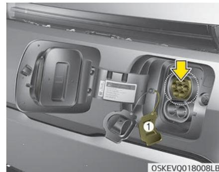
7. Öffnen Sie die Schutzabdeckung des Ladesteckers und prüfen Sie, ob der Ladestecker und die Ladebuchse eingestaubt sind.
