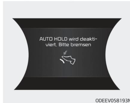
Wenn der Wechsel von Auto Hold (automatisches halten) zu EPB nicht ordnungsgemäß funktioniert, ertönt ein Warnsignal, und es erscheint eine Meldung.
