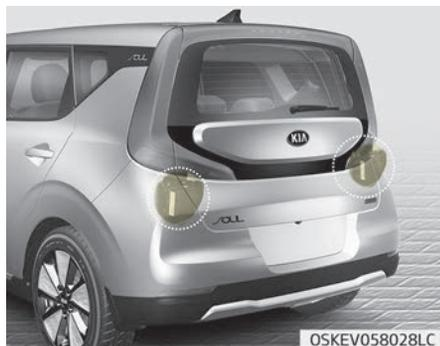
Zum Heckradar gehören die Sensoren in der hinteren Stoßstange, die die Seiten und den Heckbereich überwachen. Halten Sie die hintere Stoßstange immer sauber, damit das System einwandfrei funktioniert.
