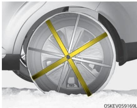
Reifenflanken können durch einige Arten von Schneeketten beschädigt werden. Deshalb empfehlen wir die Verwendung von Winterreifen anstelle von Schneeketten. Ziehen Sie keine Schneeketten auf Räder mit Leichtmetallfelgen, da Leichtmetallfelgen von den Schneeketten beschädigt werden können. Wenn Schneeketten benötigt werden, verwenden Sie AutoSock (textile Schneeketten). Fahrzeugschäden durch unsachgemäße Montage von Schneeketten unterliegen nicht der Fahrzeuggarantie des Herstellers.
