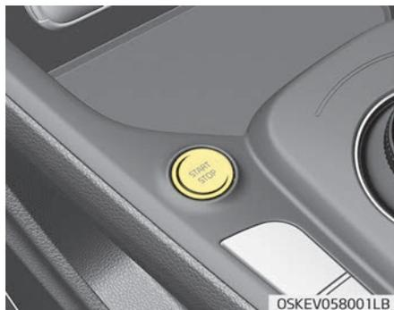
Sobald die vordere Tür geöffnet wird, wird die Beleuchtung des Knopfes START/STOP (Motorstart/-stopp) automatisch aktiviert. Das Licht erlischt etwa 30 Sekunden nach dem Schließen der Tür. Sie erlischt sofort, wenn der START/STOP-Knopf in die Stellung ON gedrückt wird.
