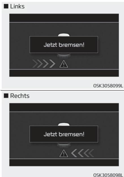
Bei Erkennung einer Kollisionsgefahr und aktiviertem RCCW werden die Bremsen über die Bremsanlage betätigt. Auf dem Kombiinstrument wird dem Fahrer die Betätigung der Bremse angezeigt. Wenn die Hecküberwachung aktiviert ist, erscheint außerdem eine Meldung auf dem Audio- bzw. AVN-Display.
