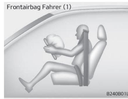
Die beiden Airbagmodule befinden sich in der Mitte des Lenkrads und im Armaturenbrett über dem Handschuhfach. Wenn das SRS-Steuermodul einen ausreichend schweren Aufprall an der Fahrzeugfront erkennt, löst es automatisch die Frontairbags aus.
