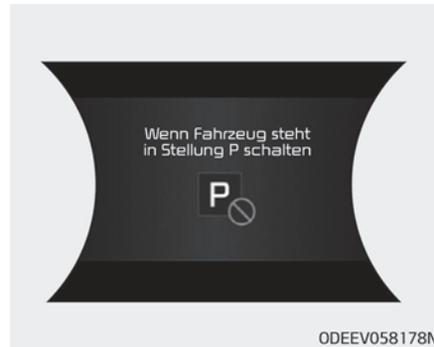
Diese Meldung wird auf dem LCD-Display angezeigt, wenn der Wahlhebel in die Stellung P (Parkstufe) gebracht wird und sich das Fahrzeug noch bewegt. Halten Sie das Fahrzeug an, bevor Sie den Wahlhebel in die Stellung P (Parkstufe) bringen.
