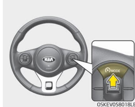
1. Drücken Sie zweimal die Taste CRUISE & SPEED LIMIT MODE (MODE) am Lenkrad, um das System einzuschalten.
