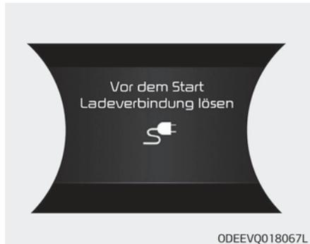
Diese Meldung wird angezeigt, wenn Sie das Fahrzeug starten, ohne das Ladekabel abzuziehen. Entfernen Sie das Ladekabel und schalten Sie dann das Fahrzeug ein.
