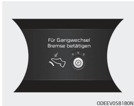
Die Mitteilung erscheint auf dem LCD-Display, wenn beim Einlegen des Gangs das Bremspedal nicht betätigt wird. Treten Sie das Bremspedal durch und legen Sie dann den Gang ein.
