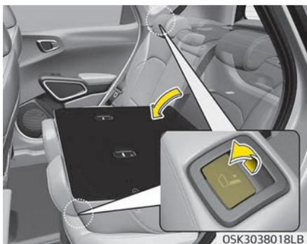
4. Ziehen Sie den Hebel zum Umlegen der Sitzlehne und klappen Sie den Sitz nach vorn. Wenn Sie die Sitzlehne wieder aufstellen, vergewissern Sie sich immer, dass die Lehne in ihrer Stellung eingerastet ist, indem Sie oben gegen die Sitzlehne drücken.
