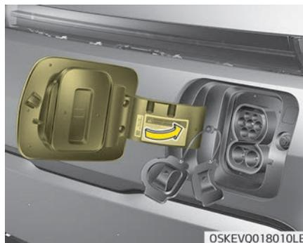
2. Achten Sie darauf, dass Sie die Klappe für die Gleichstromladebuchse wieder komplett schließen.
