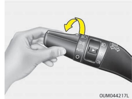
In der Schalterstellung "Scheinwerfer" (4. Stufe) sind die Scheinwerfer, das Standlicht, das Rücklicht, die Kennzeichenbeleuchtung und die Armaturenbeleuchtung eingeschaltet.
