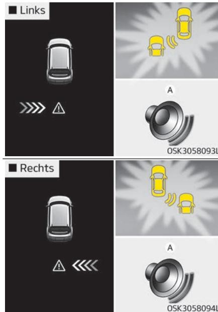
Wenn die Sensoren des Fahrzeugs erkennen, dass sich ein Fahrzeug Ihrem Fahrzeug von links hinten/rechts hinten nähert, ertönt ein akustisches Warnsignal, die Warnleuchte am Außenspiegel blinkt, und es erscheint eine entsprechende Meldung auf dem LCD-Display. Wenn die Hecküberwachung aktiviert ist, erscheint außerdem eine Meldung auf dem Audio- bzw. AVN-Display. Die Warnung wird in folgenden Fällen gestoppt:
