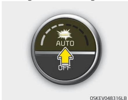
1. Drücken Sie die AUTO-Taste. Lüftungsmodi, Gebläsedrehzahl, Frischluft-/Umluftschaltung und die Klimaanlage werden automatisch von der eingestellten Temperatur gesteuert.
