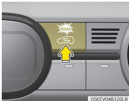
Mit dieser Schaltung können Sie zwischen der Zufuhr von Umgebungsluft (Frischluft) und der Umwälzung der im Fahrzeug befindlichen Luft (Umluft) wählen.
