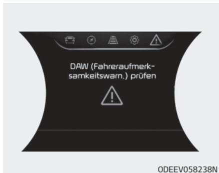
Wenn die Warnmeldung „Check Driver Attention Warning (DAW) system“ (Fahreraufmerksamkeits-Warnsystem prüfen) angezeigt wird, funktioniert das System nicht ordnungsgemäß. Lassen Sie die Anlage in diesem Fall von einer Fachwerkstatt überprüfen. Kia empfiehlt, sich an einen Kia-Vertragshändler/Servicepartner zu wenden.
