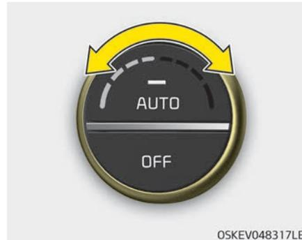
Durch Drehen des Temperaturreglers bis in die äußerste rechte Reglerstellung wird die maximale Temperatur erreicht.
