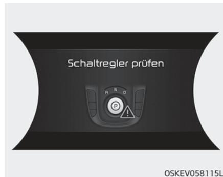
Diese Meldung wird auf dem LCD-Display angezeigt, wenn ein Problem mit den Tasten am Wählhebel vorliegt.
