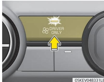
Wenn Sie die NUR-FAHRER-Taste drücken und die Kontrollleuchte aufleuchtet, wird kalte Luft vorrangig in Richtung des Fahrersitzes geblasen. Ein Teil der kalten Luft tritt jedoch auch aus den Kanälen der anderen Sitze aus, um eine komfortable Lüftung des Innenraums zu gewährleisten. Wenn Sie die Taste drücken und sich keine Person auf dem Beifahrersitz befindet, wird der Energieverbrauch reduziert.
