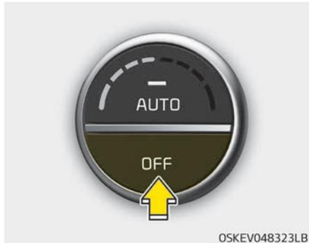
Drücken Sie die vordere Taste zum Ausschalten des Gebläses, um die vordere Klimaanlage auszuschalten. Die Modustasten und die Frischluft/Umluft-Taste können jedoch weiterhin bedient werden, solange der Knopf START/STOP eingeschaltet ist.
