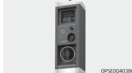
1. Entfernen Sie nach Abschluss der Aufladung den Ladestecker aus der Steckdose 220 V.
