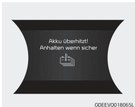
Diese Warnmeldung soll die Batterie und das Elektrofahrzeug schützen, wenn die Temperatur der Hochvolt-Batterie zu hoch ist.
