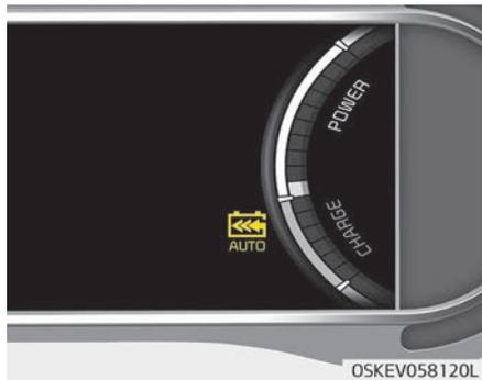
Wenn der Frontradarsensor das vorausfahrende Fahrzeug erkennt, wird die Meldung „AUTO“ blau angezeigt. Die Stufe der Regenerativbremse wird automatisch je nach dem Fahrverhalten des vorausfahrenden Fahrzeuges geregelt. Die Stufe wird durch Pfeile angezeigt.
