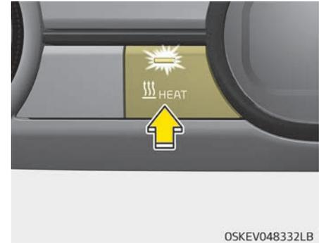
Drücken Sie die Taste HEAT (Heizung), um die Heizung einzuschalten (die Kontrollleuchte leuchtet auf). Drücken Sie die Taste erneut, um die Heizung auszuschalten. Die Klimaanlage und die Heizung verbrauchen Energie aus der Batterie. Wenn Sie die Heizung bzw. die Klimaanlage zu lange verwenden, kann die Restreichweite aufgrund des erhöhten Energieverbrauchs verkürzt werden. Schalten Sie Heizung und Klimaanlage ab, wenn Sie diese nicht benötigen.
