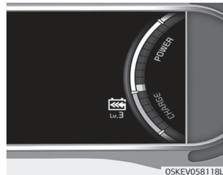
Die ausgewählte Stufe der Regenerativbremse wird auf dem Kombiinstrument angezeigt.
