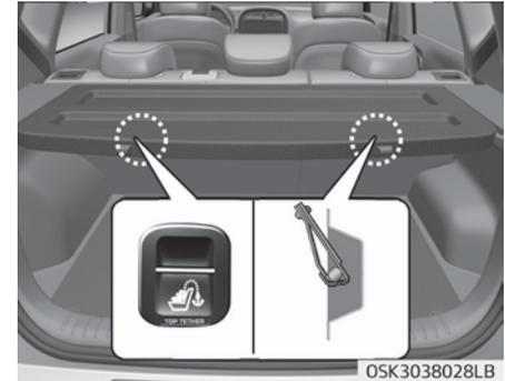
Die oberen Ankerpunkte für das Kinderrückhaltesystem befinden sich auf der Rückseite der Rücksitzlehnen.
