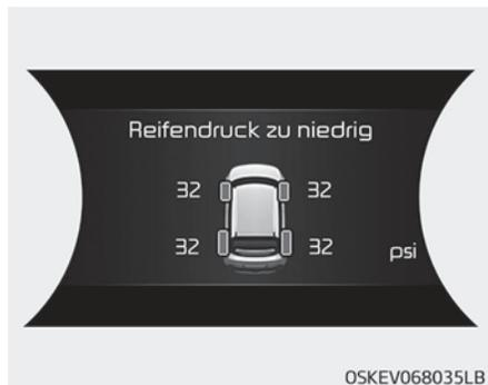
Wenn die Kontrollleuchten des Reifendruck-Überwachungssystems leuchten und eine Warnmeldung auf dem LCD-Display des Kombiinstruments angezeigt wird, ist der Reifendruck in mindestens einem Reifen zu niedrig. Die Positionskontrollleuchte für Reifen mit geringem Reifendruck zeigt an, in welchem Reifen der Reifendruck erheblich zu gering ist. Dazu wird die Position des Reifens durch eine Warnleuchte signalisiert.
