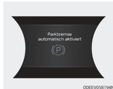
Bei Betätigung der EPB während die Auto Hold-Funktion aufgrund eines ESC-Signals aktiviert ist, ertönt ein akustisches Warnsignal, und es wird eine Meldung angezeigt.
