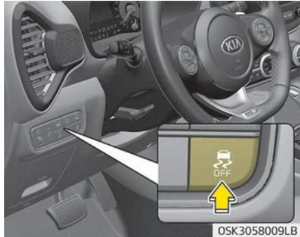
Die elektronische Stabilitätskontrolle (ESC) dient dazu, das Fahrzeug bei Kurvenfahrten bzw. Ausweichmanövern in einem stabilen Zustand zu halten. Die ESC vergleicht den Lenkradeinschlag mit der tatsächlichen Bewegung des Fahrzeugs. Die ESC kann einzelne Räder abbremsen und greift in die Fahrzeugsteuerung ein, wenn das Fahrzeug stabilisiert werden muss.
