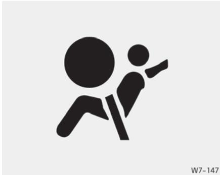
Die Airbag-Warnleuchte im Kombiinstrument soll Sie warnen, wenn mögliche Probleme mit Ihrem Airbag - SRS-System (ergänzendes Rückhaltesystem) - auftreten.
