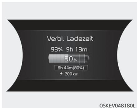
11. Nach dem Start des Ladevorgangs wird die voraussichtliche Ladezeit für 1 Minute im Kombiinstrument angezeigt.
