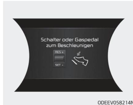
Wenn die intelligente Tempomatsteuerung (SCC) in Betrieb ist, stoppt Ihr Fahrzeug hinter dem vorausfahrenden Fahrzeug, wenn dieses anhält. Die Meldung wird auf dem Kombiinstrument innerhalb von 3 Sekunden nach dem Stopp angezeigt, das System bleibt danach im Standby-Betrieb.
