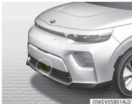
Der Sensor erkennt den Abstand zum Fahrzeug in Fahrtrichtung. Wenn der Sensor durch Schmutz oder andere Fremdkörper verdeckt ist, kann die Fahrzeugabstandskontrolle nicht einwandfrei funktionieren. Halten Sie den Bereich vor dem Sensor immer sauber.
