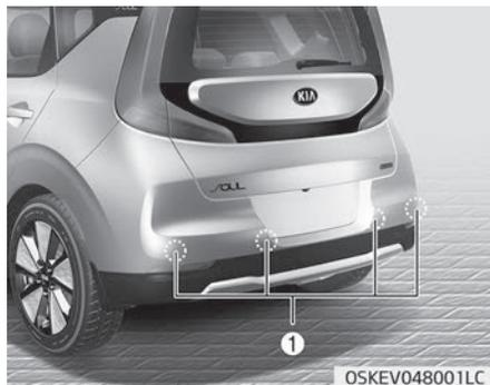
Das Einparkwarnsystem hinten warnt den Fahrer beim Zurücksetzen des Fahrzeugs durch ein akustisches Signal, wenn sich ein Gegenstand im Abstand von bis zu 120 cm hinter dem Fahrzeug befindet.
