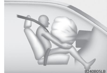
Bei der Auslösung trennen sich Sollrinnähte, die direkt in die Verkleidungen eingearbeitet sind, unter dem Druck der Airbagausdehnung. Die daraufhin entstehenden Öffnungen in den Abdeckungen erlauben die vollständige Ausdehnung der Airbags.
