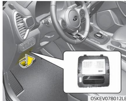
Auf der Unterseite der Sicherungs-/Relaiskastendeckel befindet sich je eine Aufstellung der enthaltenen Sicherungen/Relais inkl. ihrer Bezeichnungen und der zugehörigen Amperezahlen.
