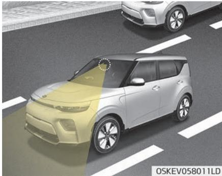
Der Spurhalteassistent soll das Fahrzeug mittels einer oben an der Windschutzscheibe angebrachten Kamera in der Mitte der gewählten Spur halten. Das System kann nur zusammen mit der intelligenten Tempomatsteuerung (SCC) aktiviert werden und unterstützt den Fahrer bei der Einhaltung der Spurtreue des Fahrzeugs.
