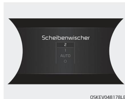
Diese Kontrollleuchte zeigt an, welche Wischergeschwindigkeit über die Wischersteuerung ausgewählt ist.
