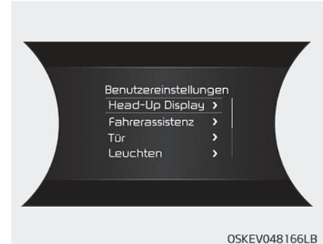
In diesem Modus können Sie die Einstellungen des Kombiinstrumentes der Türen, Lampen usw. ändern.
