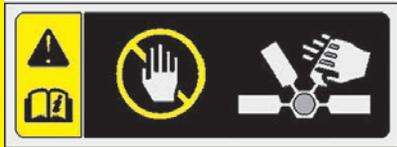
Der Elektromotor (Kühlergebläse) wird durch Motorkühlmitteltemperatur, Kältemitteldruck und Fahrgeschwindigkeit geregelt. Manchmal ist der Elektromotor in Betrieb, selbst wenn das Fahrzeug nicht fährt. Seien Sie sehr vorsichtig bei der Arbeit in der Nähe der Gebläseflügel, damit Sie nicht durch drehende Gebläseflügel verletzt werden. Ist das Motorkühlmittel ausreichend abgekühlt, schaltet sich der Elektromotor automatisch ab. Dies ist ein normaler Zustand.
