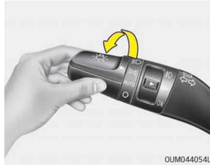
In der Schalterstellung "Standlichtposition" (3. Position) werden das Rücklicht, die Kennzeichenbeleuchtung und die Armaturenbeleuchtung eingeschaltet.
