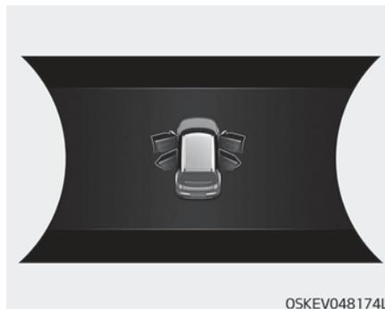
Diese Warnung wird angezeigt, wenn eine Tür oder die Motor- oder Heckklappe offen ist. Die Warnung zeigt auch an, welche Tür offen ist.
