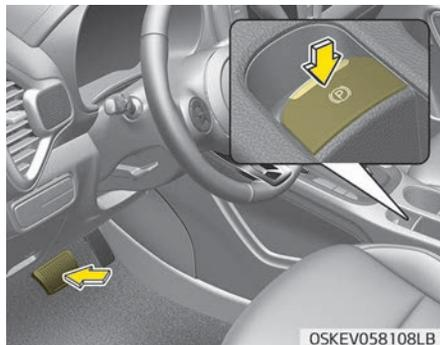
Zum Lösen der elektronischen Feststellbremse (EPB) drücken Sie den EPB-Schalter unter folgender Bedingung:
