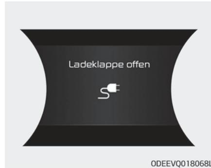
Diese Meldung wird angezeigt, wenn das Fahrzeug mit geöffneter Ladeklappe gefahren wird. Schließen Sie die Ladeklappe und beginnen Sie erst dann mit der Fahrt.
