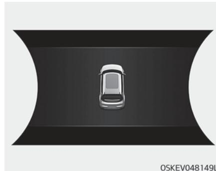
Wenn der Fahrer den Knopf START/STOP (Motorstart/-stopp) löst und das Schiebedach nicht voll geschlossen ist, ertönt einige Sekunden lang ein Warnton, und es erscheint eine Warnmeldung auf dem LCD-Display.
