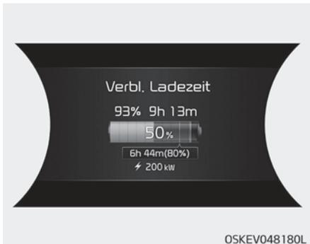
8. Nach dem Start des Ladevorgangs wird die voraussichtliche Ladezeit für 1 Minute im Kombiinstrument angezeigt.
