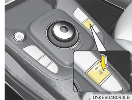
Wenn Sie bei eingeschaltetem Knopf START/STOP (Motorstart/-stopp) die Taste für die Lenkradheizung drücken, wird das Lenkrad erwärmt. Daraufhin leuchtet die Kontrollleuchte der Taste auf. Zum Ausschalten der Lenkradheizung drücken Sie die Taste erneut. Daraufhin erlischt die Kontrollleuchte der Taste.
