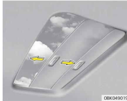
Der Sonnenschutz wird automatisch mit dem Schiebedach geöffnet.
