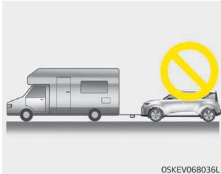
Ihr Fahrzeug ist nicht zum Abschleppen (mit 4 Rädern auf der Fahrbahn) hinter einem Caravan geeignet. Um schwere Schäden am Fahrzeug zu vermeiden, dürfen Sie Ihr Fahrzeug nicht mit vier Rädern auf der Fahrbahn abschleppen.
