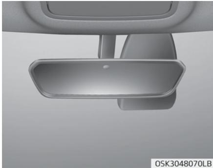
Der elektrische Innenspiegel regelt nachts oder im Halbdunkel automatisch das Blendlicht hinter Ihnen fahrender Fahrzeuge. Der im Spiegel angebrachte Sensor erkennt die Lichtstärke im Umfeld des Fahrzeugs und regelt die Blendwirkung von den Scheinwerfern nachfahrender Fahrzeuge automatisch. Wenn das Fahrzeug fährt, wird das Blendlicht automatisch von dem Sensor im Innenspiegel geregelt.
