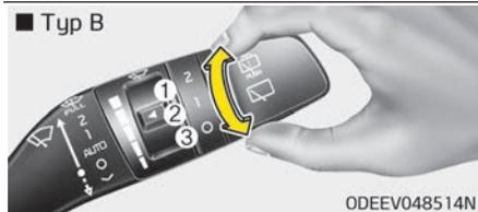
Der Heckscheibenwischer- und Waschanlagenschalter befindet sich am äußeren Ende des Scheibenwischerschalters. Drehen Sie den Schalter in die gewünschte Position, um den Heckscheibenwischer und die Heckscheibenwaschanlage in Betrieb zu setzen.
