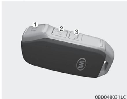
Wenn die Verriegelungstaste gedrückt wird, werden alle Türen (und die Heckklappe) verriegelt.
