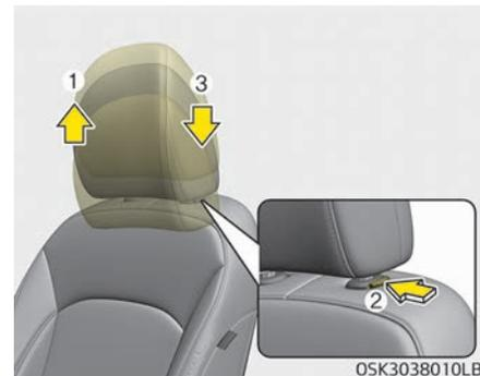
Um die Kopfstütze in eine höhere Stellung zu bringen, ziehen Sie bis in die gewünschte Stellung nach oben (1). Um die Kopfstütze in eine tiefere Stellung zu bringen, drücken Sie die Sperrtaste (2) an der Kopfstützenaufnahme, halten Sie die Taster gedrückt und drücken Sie dabei die Kopfstütze bis in die gewünschte Stellung nach unten (3).
