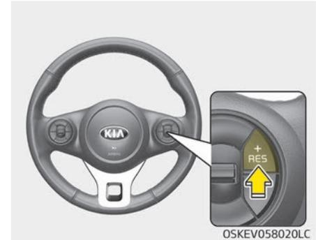
Wenn die automatische Geschwindigkeitsregelung deaktiviert wurde, ohne dass die Taste CRUISE/Ⓢ betätigt wurde (und wenn das System weiterhin eingeschaltet ist), wird die Regelung der zuletzt eingestellten Dauergeschwindigkeit automatisch dadurch aktiviert, wenn der RES+ Schalter gedrückt wird.
