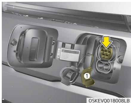
4. Drücken Sie den Freigabeknopf für die Klappe zur Wechselstrom-Aufladung (1), um diese zu öffnen und öffnen Sie die Ladeklappe.
