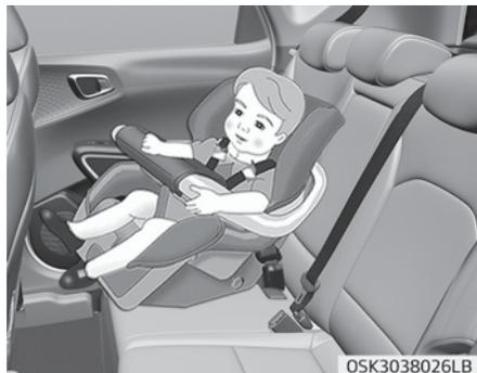
Ein Kinderrückhaltesystem mit Sicht in Fahrtrichtung hält den Körper des Kindes durch ein Gurtsystem. Transportieren Sie Kinder in einem Kinderrückhaltesystem mit Sicht in Fahrtrichtung und einem Gurtsystem, bis sie schwerer bzw. größer sind, als der Hersteller Ihres Kinderrückhaltesystems erlaubt. Sobald Ihr Kind so groß ist, dass es nicht mehr in ein Kinderrückhaltesystem mit Sicht in Fahrtrichtung passt, kann Ihr Kind eine Sitzerrhöhung verwenden.
