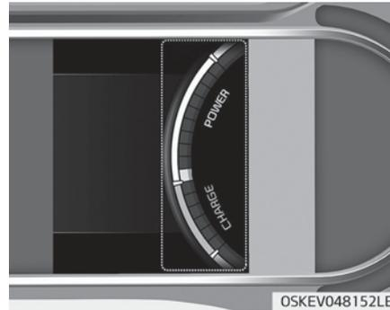
Die Leistungs-/Ladeanzeige zeigt den Energieverbrauch des Fahrzeugs sowie den Lade-/Entladestatus der regenerativen Bremsen.
