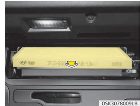
5. Ersetzen Sie den Luftfilter der Klimaanlage.
