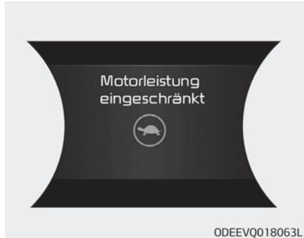
In folgenden Fällen wird diese Warnmeldung angezeigt, wenn die Leistung des Fahrzeugs aus Sicherheitsgründen begrenzt wird.
