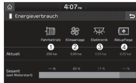
1. „Fahrt“ zeigt die Gesamtleistung und den Gesamtenergieverbrauch des Fahrmotors, die Fahrerenergie und die zurückgewonnene Energie.
