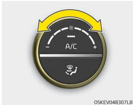
Durch den Gebäsedrehzahlregler kann die gewünschte Gebäsedrehzahl eingestellt werden. Je höher die Gebäsedrehzahl ist, desto größer ist das zugeführte Luftvolumen.
