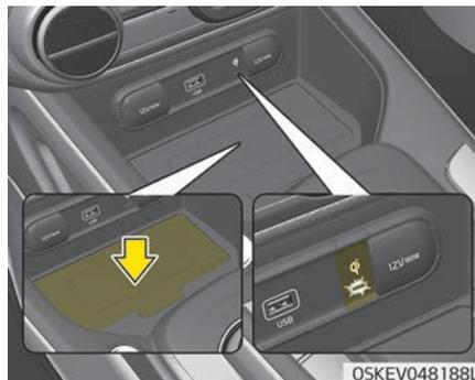
Vor der Mittelkonsole befindet sich ein Drahtlos-Ladesystem für Mobiltelefone.
