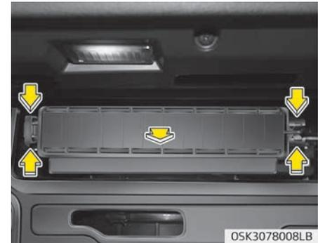
4. Bauen Sie das Filtergehäuse aus, indem Sie an beiden Seiten des Filtergehäuses ziehen.
