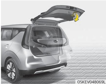
Drücken Sie die Heckklappe fest nach unten. Vergewissern Sie sich, dass die Heckklappe vollständig im Schloss eingearastet ist.
