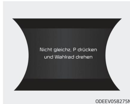
Die Meldung erscheint auf dem LCD-Display, wenn das Einstellrädchen am Wählhebel beim Drücken der Taste P nicht gedreht wird.
