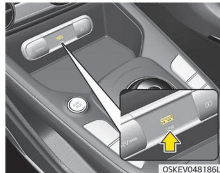
Sie können über einen USB-Anschluss ein USB-Gerät oder einen iPod® anschließen.
