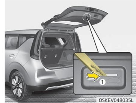
Ihr Fahrzeug ist mit einem Hebel für die Notentriegelung der Heckklappe ausgerüstet. Der Hebel befindet sich unten an der Heckklappe. Wenn eine Person versehentlich im Laderaum eingeschlossen wurde, kann die Heckklappe wie folgt entriegelt werden:
