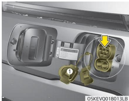
4. Öffnen Sie die Ladeklappe und dann die Abdeckung für die Ladebuchse.
