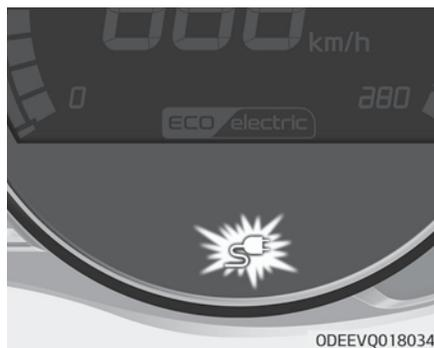
10. Überprüfen Sie, ob die Kontrollleuchte für den Anschluss des Ladekabels der Hochvolt-Batterie im Kombiinstrument leuchtet. Die Aufladung beginnt erst, wenn die Ladekontrollleuchte leuchtet. Wenn der Ladestecker nicht richtig angeschlossen ist, schließen Sie das Ladekabel zur Aufladung erneut an.
