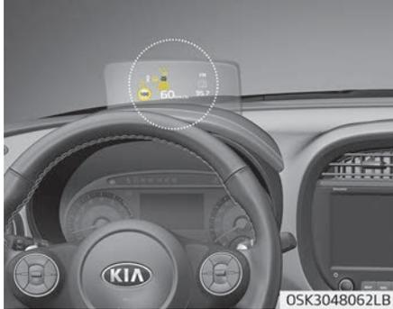
Das Head-Up-Display ist ein transparentes Display, das einige Informationen des Kombiinstruments sowie Navigationsinformationen anzeigt.
