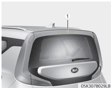
Wenn die dritte Bremsleuchte (LED) (1) nicht funktioniert, lassen Sie das Fahrzeug von einer Fachwerkstatt überprüfen.
