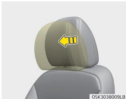
Die Kopfstütze kann nach vorn in 4 verschiedene Stellungen gebracht werden, indem Sie die Kopfstütze in die gewünschte Stellung nach vorn ziehen. Um die Kopfstütze in die hinterste Position zu bringen, ziehen Sie diese zunächst ganz nach vorn und lassen Sie dann los. Stellen Sie die Kopfstütze so ein, dass Kopf und Nacken in geeigneter Weise abgestützt werden.
