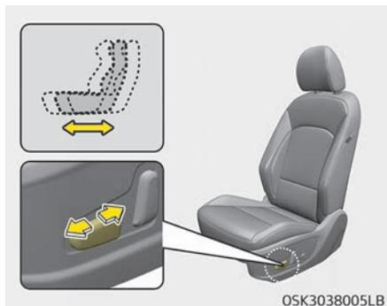
1. Drücken Sie den Steuerschalter nach vorn oder nach hinten, um den Sitz in die gewünschte Position zu bewegen.
