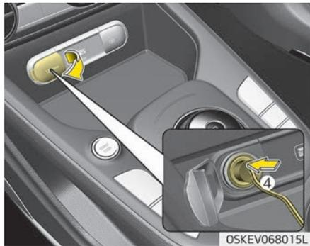
7. Schließen Sie den Kompressor mit dem Kabel und den Verbindern (4) an die Fahrzeug-Steckdose an.
