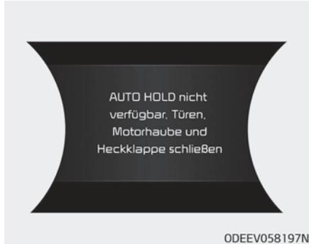
Wenn Sie den Schalter [AUTO HOLD] drücken, und die Fahrertür, Motorraumklappe oder Heckklappe nicht geschlossen ist, ertönt ein akustisches Warnsignal, und es erscheint eine entsprechende Meldung auf dem LCD-Display. Drücken Sie in diesem Moment die Taste [AUTO HOLD], nachdem Sie die Fahrertür, Motorhaube oder Heckklappe geschlossen haben.
