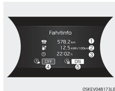
Nach Ende jedes Fahrzyklus werden die Fahrinformationen angezeigt. Angezeigt werden die Tageskilometer (1), der durchschnittliche Energieverbrauch (2), die Fahrzeit (3), der Ladezeitstatus (4) und die Zeit für die Aktivierung der Klimaanlage (5).
