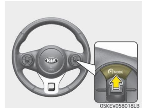
1. Drücken Sie die Taste
