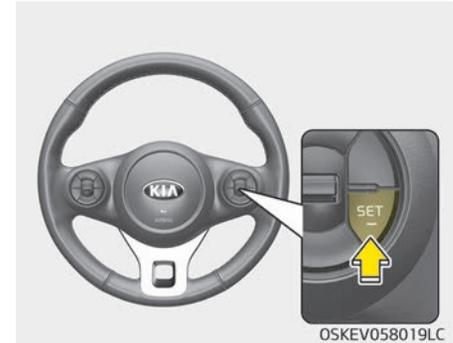
3. Drücken Sie den Hebel nach unten (in Richtung SET-) und lassen Sie ihn bei Erreichen der gewünschten Geschwindigkeit los. Die eingestellte Geschwindigkeit und der Abstand zum vorausfahrenden Fahrzeug erscheinen auf dem LCD-Bildschirm.
