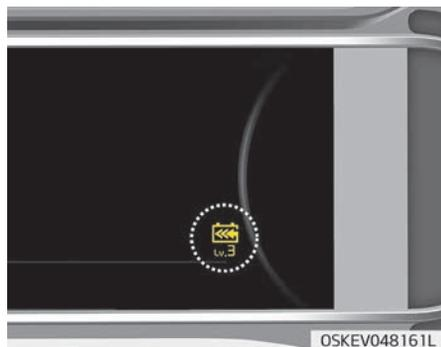
Bei Verwendung der Regenerativbremse können Sie durch Ziehen der Schaltwippe eine Regenerativbremsstufe zwischen 0 und 3 einstellen.
