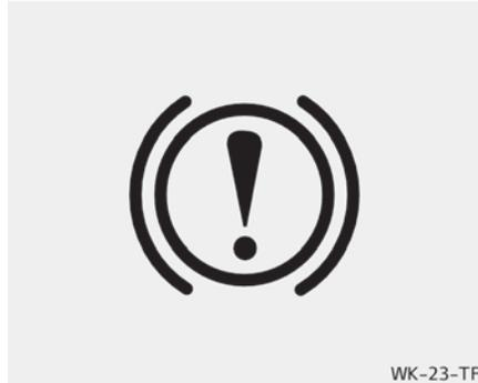
Prüfen Sie die Bremswarnleuchte, indem Sie den Knopf START/STOP (Motorstart/-stopp) des Fahrzeugs in Stellung ON drücken (ohne das Fahrzeug zu starten). Diese Leuchte wird eingeschaltet, wenn der Knopf START/STOP (Motorstart/-stopp) bei betätigter Feststellbremse in die Stellung ON oder START gedreht wird.
