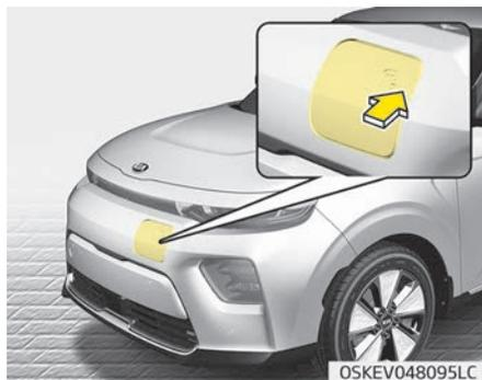
5. Öffnen Sie die Ladeklappe, indem Sie (▶) der Ladeklappe berühren. Die Ladeklappe öffnet sich nicht, wenn die Fahrzeugtür verriegelt ist.
