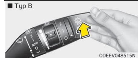
Drücken Sie den Hebel von Ihnen weg, um Waschwasser auf die Heckscheibe zu sprühen und die Heckscheibenwischer 1~3 Mal wischen zu lassen. Der Sprüh- und Wischvorgang wird fortgesetzt, bis Sie den Hebel freigeben.
