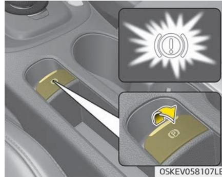
So ziehen Sie die elektronische Feststellbremse (EPB) an.
