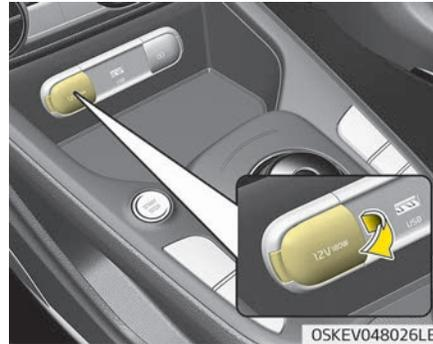
Die 12-V-Steckdosen sind für die Stromversorgung von Mobiltelefonen und anderen Geräten, die mit der Bordspannung des Fahrzeugs betrieben werden können, vorgesehen. Die Geräte sollten bei laufendem Motor weniger als 10 A benötigen.
