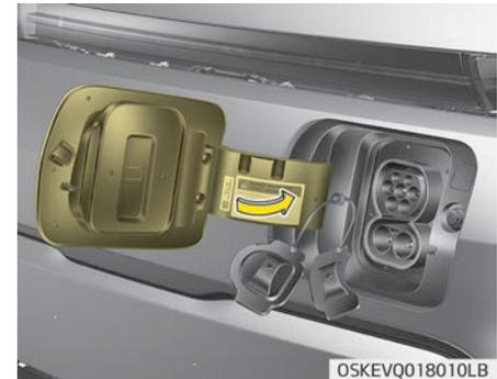
2. Achten Sie darauf, dass Sie die Klappe für die Wechselstrom-Ladebuchse wieder komplett schließen.
