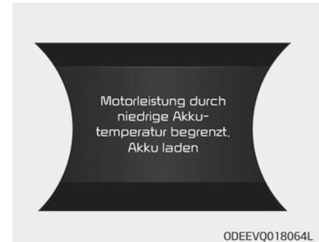
Die Warnmeldung wird angezeigt, um das Elektrofahrzeug zu schützen, wenn Sie es ausschalten oder einschalten und die Außentemperatur niedrig ist. Wenn die Hochvolt-Batterie entladen ist und Sie bei niedriger Temperatur längere Zeit im Freien parken, kann die Fahrzeugleistung eingeschränkt sein. Laden Sie die Batterie vor dem Losfahren auf, um die Leistung zu erhöhen.
