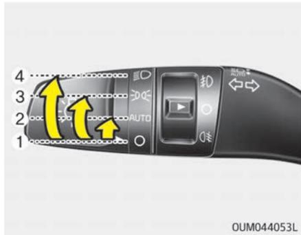
Der Lichtschalter hat eine Scheinwerfer- und eine Parklichtposition. Zur Steuerung der Beleuchtung stellen Sie den Drehknopf am Blinkerhebel auf eine der folgenden Positionen:
