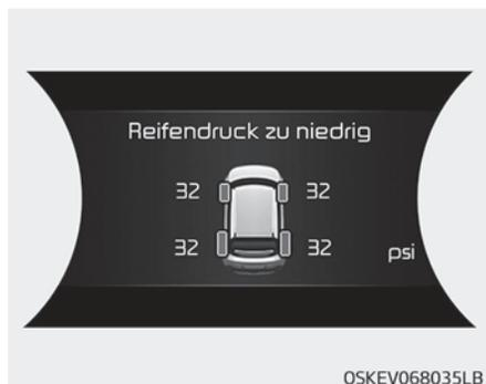
Diese Warnmeldung wird angezeigt, wenn der Reifendruck zu niedrig ist. Der entsprechende Reifen am Fahrzeug wird angezeigt.
