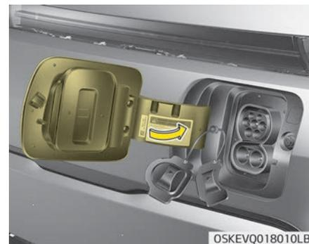
3. Achten Sie darauf, dass Sie die Klappe für die Wechselstrom-Ladebuchse wieder komplett schließen.
