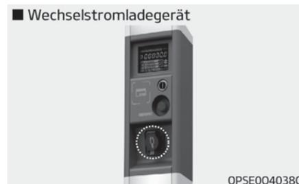
7. Verbinden Sie den Ladestecker mit einer Steckdose (220 V) einer Wechselstrom-Ladestation, um die Aufladung zu beginnen.
