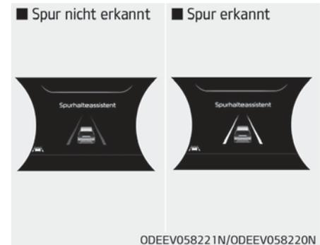
Wenn die Geschwindigkeit des Fahrzeugs über 60 km/h liegt und das System die Fahrspurmarkierung erkennt, ändert sich die Farbe von grau in weiß.
