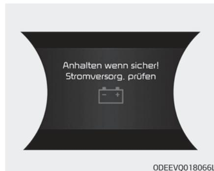
Diese Warnmeldung wird angezeigt, wenn in der Stromversorgung ein Fehler aufgetreten ist. Parken Sie in diesem Fall das Fahrzeug an einem sicheren Ort, lassen Sie das Fahrzeug zum nächsten Kia-Vertragshändler/Servicepartner schleppen und durchsehen.
