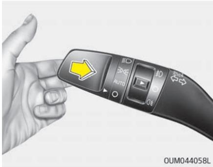
Um die Lichtlupe zu betätigen, ziehen Sie den Lichtschalterhebel zu sich hin. Wenn Sie ihn loslassen, kehrt er in seine ursprüngliche Stellung (Fahrlicht) zurück. Um die Lichtlupe bedienen zu können, muss das Licht nicht eingeschaltet sein.
