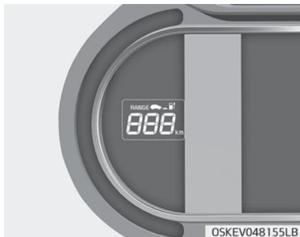
Sie können die Restreichweite des Fahrzeuges mit der aktuellen Batterieladung überprüfen.
