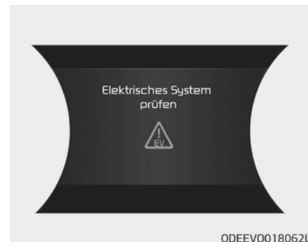
Diese Warnmeldung wird angezeigt, wenn ein Problem mit der elektrischen Steuerung des Fahrzeugs vorliegt.
