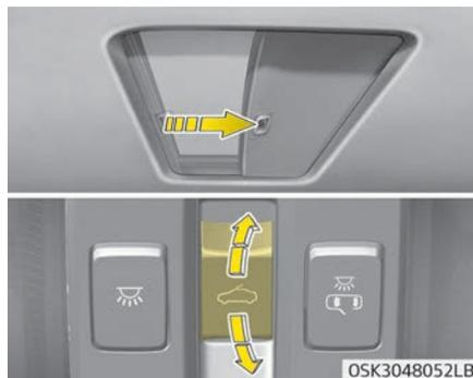
Drücken Sie den Hebel des Schiebedachs nach vorn oder hinten bis in die erste Rastposition um das Schiebedach (manuell) zu öffnen oder zu schließen. Um das Schiebedach zu öffnen (automatisches Öffnen), drücken Sie den Schiebedachscharter nach hinten in die zweite Rastposition.
