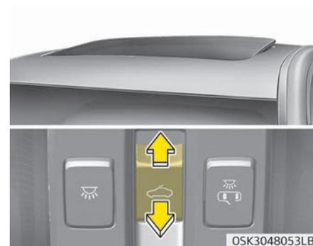
Drücken Sie zum Öffnen des Schiebedachs den Hebel des Schiebedachs nach oben, bis das Schiebedach sich in der gewünschten Position befindet. Drücken Sie zum Schließen des Schiebedachs den Hebel des Schiebedachs nach vorne, bis das Schiebedach sich in der gewünschten Position befindet.
