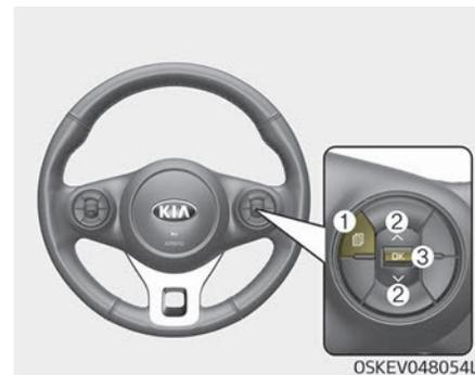
Die LCD-Display-Modi können mit den Tasten am Lenkrad verändert werden.
