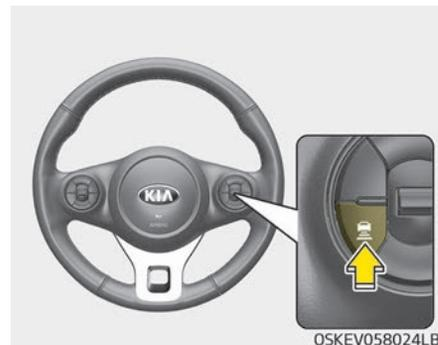
Mit dieser Funktion können Sie den Abstand zum vorausfahrenden Fahrzeug programmieren, den Ihr Fahrzeug einhalten soll, ohne dass Sie das Gas- oder Bremspedal betätigen müssen. Der Abstand zwischen Fahrzeugen wird automatisch aktiviert, wenn der intelligente Tempomat eingeschaltet ist. Wählen Sie den entsprechenden Abstand gemäß den Straßenbedingungen und der Fahrgeschwindigkeit.
