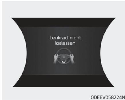
Wenn Sie während der Fahrt mit dem LFA-System zur Lenkassistentz die Hände vom Lenkrad nehmen, wird das Warnsignal für handlosen Betrieb ausgelöst.
