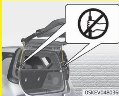
**Erfassen Sie nicht das Teil, das die Heckklappe abstützt (Gasstütze), da es dadurch zu schweren Verletzungen kommen kann.**
