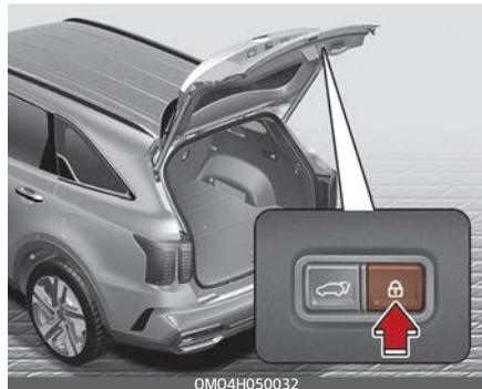
Die Heckklappe schließt sich und alle Türen verriegeln automatisch.
