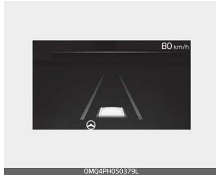
Wenn das vorausfahrende Fahrzeug oder beide Fahrbahnmarkierungen erkannt werden und Ihre Fahrzeuggeschwindigkeit unter 200 km/h liegt, leuchtet die grüne Anzeige (🚗) des Kombiinstruments auf, und die Funktion hält das Fahrzeug in der Spur, indem sie das Lenkrad steuert.
