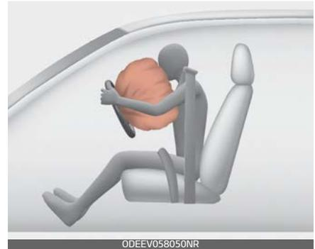
Ein vollständig aufgeblasener Airbag, in Verbindung mit einem ordnungsgemäß angelegten Sicherheitsgurt, verlangsamt die Vorwärtsbewegung des Fahrers oder Beifahrers und reduziert das Risiko von Kopf- und Brustverletzungen.
