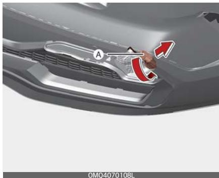
6. Entnehmen Sie die Glühlampe aus der Fassung, indem Sie die Glühlampe niederdrücken und gegen den Uhrzeigersinn drehen, bis ihre Rastnasen auf die Ausparungen in der Lampenfassung ausgerichtet sind. Ziehen Sie die Glühlampe aus der Fassung.
