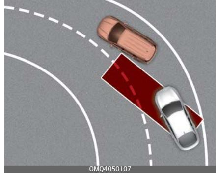
Das Totwinkel-Erkennungssystem funktioniert nicht ordnungsgemäß, wenn Sie auf einer kurvenförmigen Straße fahren. Das System kann ein Fahrzeug in der gleichen Fahrspur erkennen. Achten Sie während der Fahrt immer auf die Straßen- und Fahrbedingungen.
