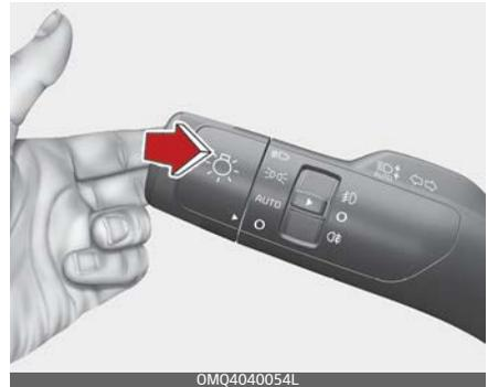
Wenn Sie ihn loslassen, kehrt er in seine ursprüngliche Stellung (Fahrlicht) zurück. Um die Lichtlupe zu bedienen, muss das Licht nicht eingeschaltet sein.
