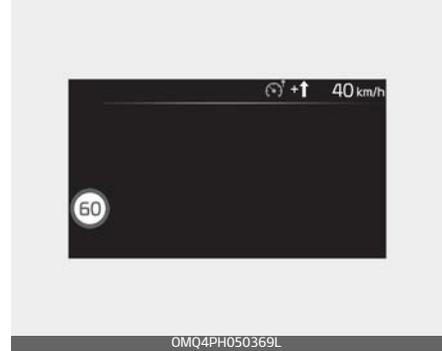
Wenn sich das Tempolimit der Straße während des Betriebs des manuellen Tempolimitassistenten oder der intelligenten Tempomatsteuerung ändert, wird ein nach oben oder unten zeigender Pfeil angezeigt, um den Fahrer zu informieren, dass die eingestellte Geschwindigkeit geändert werden muss. Zu diesem Zeitpunkt kann der Fahrer die eingestellte Geschwindigkeit entsprechend der Geschwindigkeitsbegrenzung ändern, indem er den Schalter + oder - am Lenkrad betätigt.
