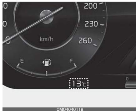
Dieses Messgerät zeigt die aktuelle Außenlufttemperatur in Schritten von 1 °C an.
