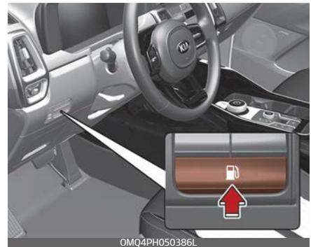
2. Warten Sie, bis die Druckentlastung des Kraftstofftanks abgeschlossen ist. Diese Meldung wird angezeigt, wenn die Tankklappe nach der Druckentlastung des Kraftstofftanks entriegelt wird.
