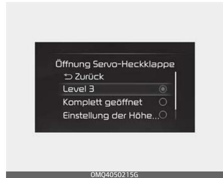
Die Öffnungshöhe der Heckklappe kann in den Einstellungen des Kombiinstrumentes oder im Infotainmentsystem eingestellt werden.
