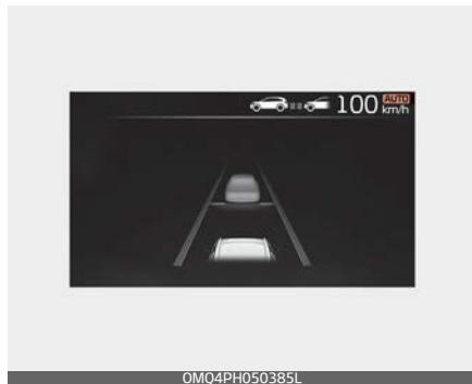
Wenn im Standby-Modus eine vorübergehende Verzögerung erforderlich ist und die navigationsgestützte intelligente Tempomatsteuerung aktiv ist, leuchtet das grüne Symbol (AUTO) auf dem Kombiinstrument auf.
