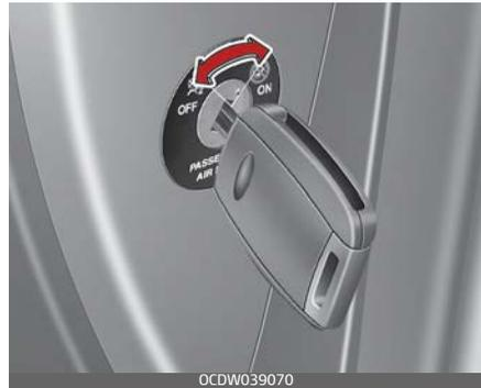
Wenn ein Kinderrückhaltesystem auf dem Beifahrersitz installiert ist oder dieser Sitz nicht besetzt ist, kann der Beifahrerairbag mit dem Schalter „Beifahrer-Frontairbag ON/OFF“ deaktiviert werden.
