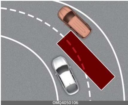
Das Totwinkel-Erkennungssystem funktioniert nicht ordnungsgemäß, wenn Sie auf einer kurvenförmigen Straße fahren. In bestimmten Fällen erkennt das System das Fahrzeug in der Nachbarspur nicht. Achten Sie während der Fahrt immer auf die Straßen- und Fahrbedingungen.
