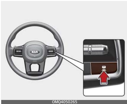
Bei jedem Drücken der Fahrzeugabstandstaste wechselt der Abstand zwischen Fahrzeugen wie folgt:
