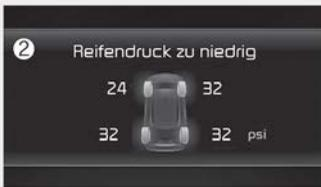
1. Positionsanzeige - geringer Reifendruck/Kontrollleuchte für eine TPMS-Fehlfunktion
