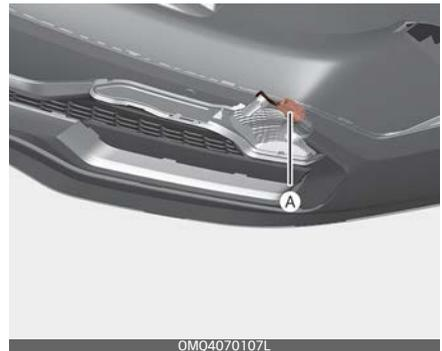
5. Bauen Sie die Lampenfassung (A) aus dem Leuchtengehäuse aus, indem Sie die Fassung gegen den Uhrzeigersinn drehen, bis ihre
