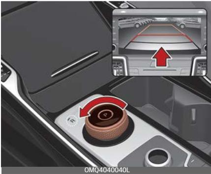
Der Rückfahrmonitor zeigt den Bereich hinter dem Fahrzeug an, um Ihnen beim Einparken oder Rückwärtsfahren zu helfen.
