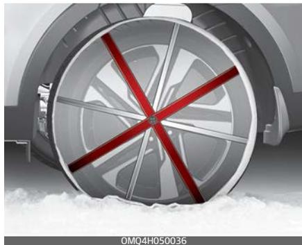
Reifenflanken von Radialreifen können durch einige Schneeketten beschädigt werden, da die Seitenwände von Radialreifen dünner sind. Deshalb empfehlen wir die Verwendung von Winterreifen anstelle von Schneeketten. Ziehen Sie keine Schneeketten auf Räder mit Leichtmetallfelgen, da Leichtmetallfelgen von den Schneeketten beschädigt werden können. Wenn Schneeketten aufgezogen werden müssen, verwenden Sie Textilketten oder Draht-
