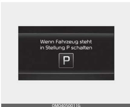
Diese Meldung wird auf dem LCD-Display angezeigt, wenn der Wahlhebel in Position P (Parkstufe) gebracht wird und sich das Fahrzeug noch bewegt.
