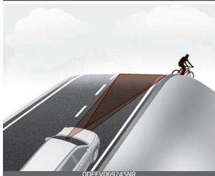
Der Frontkollisions-Vermeidungsassistent (FCA) erkennt bei der Fahrt auf einer kurvenreichen Straße möglicherweise ein Fahrzeug, einen Fußgänger oder einen Radfahrer in der benachbarten Spur oder außerhalb der Spur.
