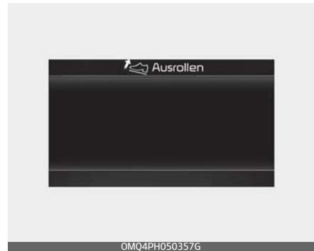
Es ertönt ein akustisches Signal, die Anzeige des Leerlaufassistenten erscheint und weist den Fahrer darauf hin, wann er den Fuß vom Gaspedal nehmen sollte, wenn aufgrund der Analyse von Fahrstrecken und Straßenverhältnissen der im Navigationssystem gespeicherten Route ein Abbremsereignis\* bevorsteht. So wird der Fahrer dazu angehalten, den Fuß vom Gaspedal zu nehmen und im Leerlauf nur mit dem Elektromotor zu fahren. Dies vermeidet unnötigen Kraftstoffverbrauchs bei und steigert die Effizienz.
