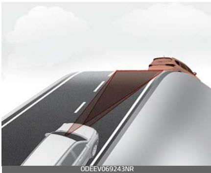
Bei Bergauf- oder Bergabfahrten kann die intelligente Tempomatsteuerung möglicherweise ein fahrendes Fahrzeug auf Ihrer Fahrbahn nicht erkennen, sodass Ihr Fahrzeug auf die Sollgeschwindigkeit beschleunigt. Außerdem wird die Fahrzeuggeschwindigkeit stark reduziert, wenn plötzlich das vorausfahrende Fahrzeug erkannt wird.
