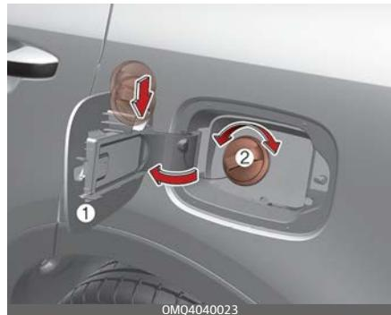
5. Um den Tankdeckel (2) abzunehmen, drehen Sie ihn gegen den Uhrzeigersinn. Möglicherweise hören Sie ein zischendes Geräusch, weil sich der Druck im Tank ausgleicht.
