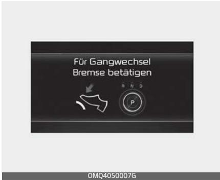
Die Mitteilung erscheint auf dem LCD-Display, wenn beim Einlegen des Gangs das Bremspedal nicht betätigt wird.
