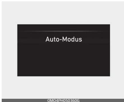
Der Fahrmodus wird vom System automatisch entsprechend den Fahrbedingungen unter dem elektrischen Modus (CD) oder dem Hybridmodus (CS) gewählt.
