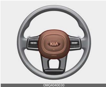
Die Hupe ertönt nur, wenn Sie den gekennzeichneten Lenkradbereich drücken. Prüfen Sie die Hupe regelmäßig, damit Sie sicher sein können, dass die Hupe in Ordnung ist.
