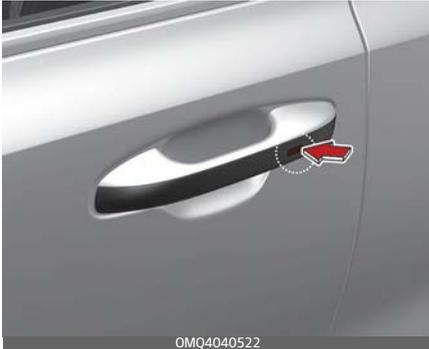
Wenn Sie den Smart-Key bei sich haben, können Sie die Fahrzeugtüren (und die Heckklappe) ent- und verriegeln. Sie können auch den Motor starten. Weitere Details finden Sie unten.
