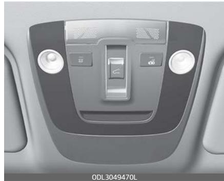
Das Schiebedach kann nur geöffnet, geschlossen oder angekippt werden, wenn der Zündschalter oder der Start-/Stopp-Knopf in Position ON steht.
