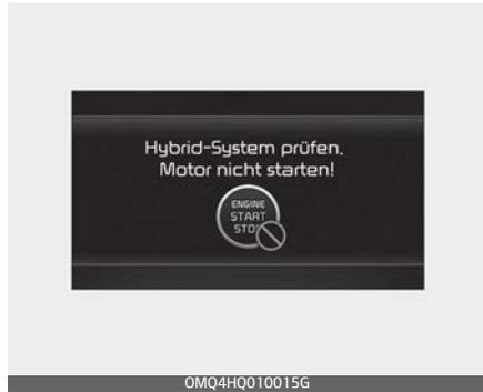
Diese Meldung wird angezeigt, wenn der Ladestand der Hybridbatterie (SOC) niedrig ist. Es ertönt ein akustisches Warnsignal, bis das Problem behoben ist. Fahren Sie nicht, wenn diese Warnmeldung angezeigt wird.
