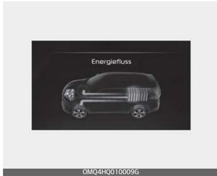
Der Verbrennungsmotor lädt die Hochvoltbatterie auf. Das Fahrzeug wird mit dem Elektromotor angetrieben.
