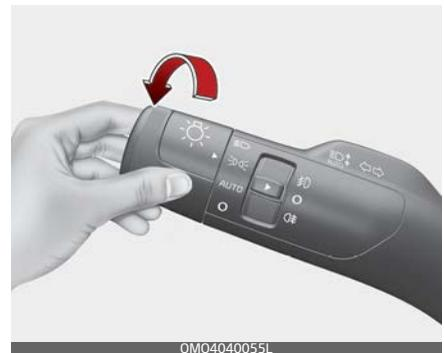
Wenn sich der Lichtschalter in der Stellung Positionsleuchte befindet, schalten sich die vordere Positionsleuchte, die Rückleuchte und die Kennzeichenbeleuchtung ein.
