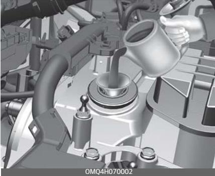
**Verwenden Sie einen Trichter, um zu vermeiden, dass Öl vergossen wird und auf Motorteile läuft.**
