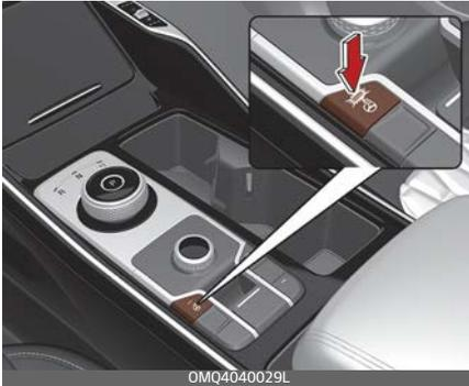
Zum Ausschalten der Lenkradheizung drücken Sie die Taste erneut. Daraufhin erlischt die Kontrollleuchte der Taste.
