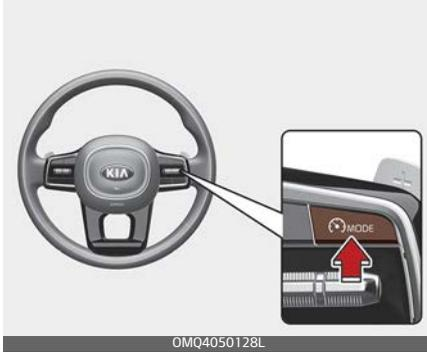
Drücken Sie die Fahrassistenten-Taste (MODE), um den manuellen Geschwindigkeitsbegrenzungsassistenten auszuschalten. Die Kontrollleuchte für die Geschwindigkeitsbegrenzung erlischt.
