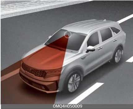
Die Frontkamera wird als Erkennungssensor verwendet, um während der Fahrt Umgebungslicht und Helligkeit zu erkennen. Die genaue Position des Detektors ist im Bild oben zu sehen.
