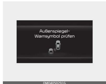
Wenn die Warnleuchte des Seitenspiegels nicht richtig funktioniert, erscheint die Warnmeldung „Außenspiegel-Warnleuchte prüfen“ auf dem Kombiinstrument. Lassen Sie die Funktion von einem Kia-Vertragshändler überprüfen.
