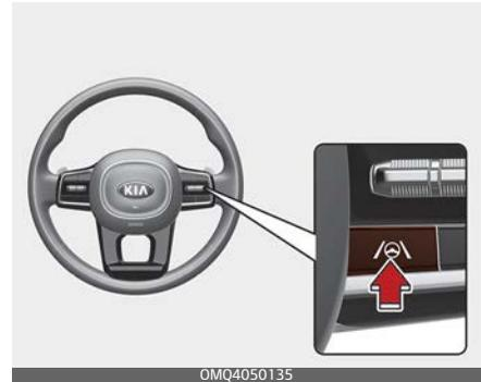
Drücken Sie, wenn der Engine Start/Stop-Knopf in Position ON steht, kurz auf die Taste für den Spurhalteassistenten am Lenkrad, um den Spurhalteassistenten einzuschalten. Die weiße oder grüne Kontrollleuchte (🚗) auf dem Kombiinstrument leuchtet auf.
