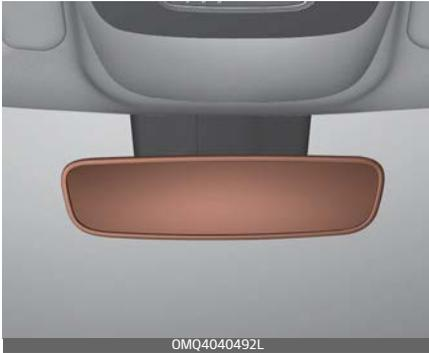
Der im Spiegel angebrachte Sensor erkennt die Lichtstärke im Umfeld des Fahrzeugs und regelt die Blendwirkung von den Scheinwerfern nachfahrender Fahrzeuge automatisch.
