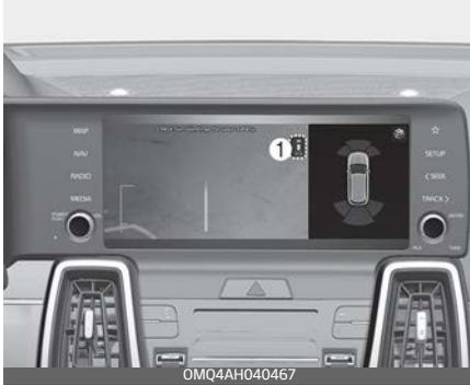
Wenn Sie das Symbol (1) berühren, wird das Fahrzeug mit Sicht von oben auf dem Bildschirm und die Entfernung zum Fahrzeug hinter Ihnen während des Parkvorgangs angezeigt.
