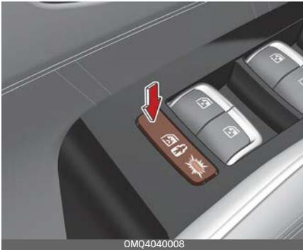
Um die elektronische Kindersicherung zu entriegeln, drücken Sie den Schalter der elektronischen Kindersicherung erneut. Die Anzeigeleuchte erlischt dann.
