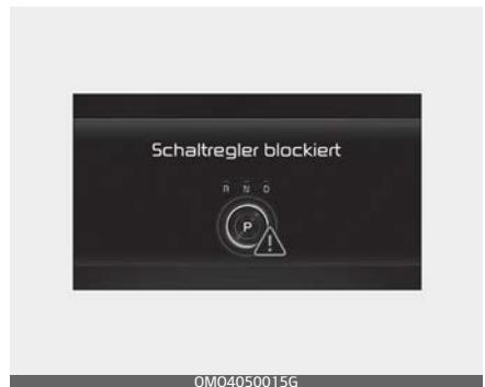
Diese Meldung erscheint auf dem LCD-Display, wenn der SBW-Schalter dauerhaft klemmt oder nicht richtig funktioniert.
