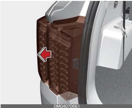
5. Bauen Sie die hintere Kombi- lampe aus der Fahrzeugkarosserie aus.
