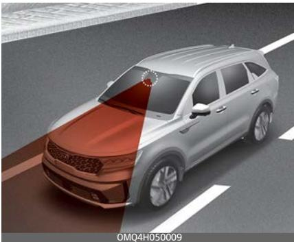
Die Frontkamera dient als Erkennungssensor. Sie erkennt während der Fahrt den Fahrstil und den Start eines vorfahrenden Fahrzeugs.
