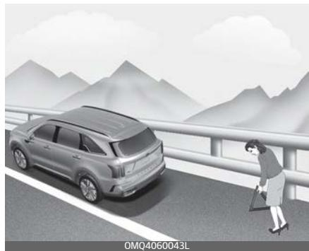
1. Stellen Sie das Fahrzeug auf ebenem Untergrund ab und betätigen Sie kräftig die Feststellbremse.
