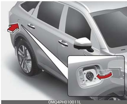
\* Die Ladeklappe verfügt nicht über ein Verriegelungssystem.
