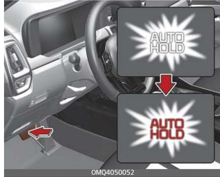
Wenn Sie das Fahrzeug vollständig mit dem Bremspedal anhalten, wechselt die Farbe der AUTO HOLD-Kontrollleuchte von Weiß zu Grün, was die Aktivierung der AUTO HOLD-Funktion anzeigt. Das Fahrzeug bleibt stehen, selbst wenn Sie das Bremspedal freigegeben.
