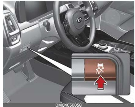
Die ESC kann einzelne Räder abbremsen und greift in die Fahrzeugsteuerung ein, wenn das Fahrzeug stabilisiert werden muss.
