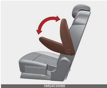
Die verstellbare Armlehne befindet sich auf jeder Seite der Rückenlehne der 2. Sitzreihe. Um die Armlehne zu verwenden, ziehen Sie sie von der Rückenlehne nach vorne und stellen den gewünschten Winkel ein. Ziehen Sie diese nach hinten, um die Armlehne zu verschieben.
