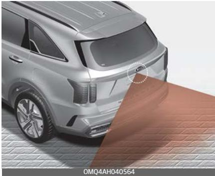
Die Rückfahrkamera wird als Erkennungssensor für Fußgänger verwendet. Wenn das Kameraobjektiv durch Fremdkörper wie Schnee oder Regen verdeckt ist, kann die Erkennungsleistung der Kamera beeinträchtigt werden, und der Heckkollisionsvermeidungsassistent funktioniert möglicherweise nicht richtig. Halten Sie das Kameraobjektiv immer sauber.
