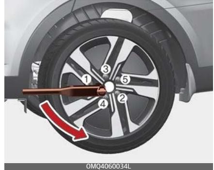
6. Lösen Sie alle Radmuttern um eine Umdrehung gegen den Uhrzeigersinn. Schrauben Sie Radmuttern erst ab, wenn das Rad soweit angehoben wurde, dass es den Boden nicht mehr berührt.
