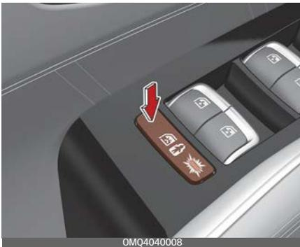
Wenn sich die elektronische Kindersicherungstaste in der Position LOCK befindet und ein sich von hinten annäherndes Fahrzeug erkannt wird, wird die elektronische Kindersicherungstaste auch dann nicht entriegelt, wenn der Fahrer die
