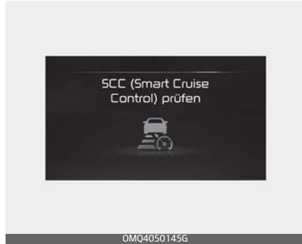
Wenn die intelligente Tempomatsteuerung nicht richtig funktioniert, erscheint die Warnmeldung „Intelligente Tempomatsteuerung prüfen“ und die Kontrollleuchte (⚠️) leuchtet auf dem Kombiinstrument auf. Lassen Sie die Funktion von einem Kia-Vertragshändler überprüfen.
