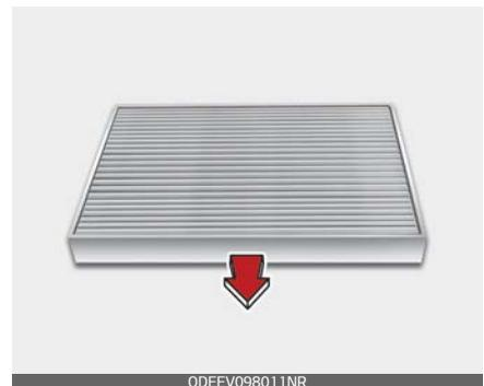
5. Bauen Sie den Filter in umgekehrter Reihenfolge des Ausbaus ein.
