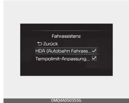
Wählen Sie, wenn der Engine Start/Stop-Knopf in Position ON steht, die Option „Fahrerassistenz → Fahrhilfe → Automatische Geschwindigkeitsänderung auf der Autobahn“ aus dem Einstellungs Menü, um die navigationsbasierte intelligente Tempomatsteuerung zu aktivieren, und wählen Sie sie ab, um die Funktion auszuschalten.
