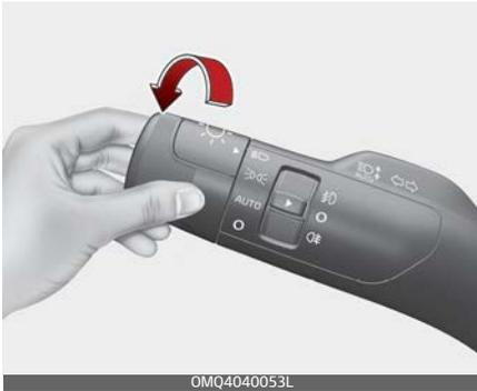
In der Schalterstellung „Scheinwerfer“ sind die Scheinwerfer, das Rücklicht und die Kennzeichenbeleuchtung eingeschaltet.
