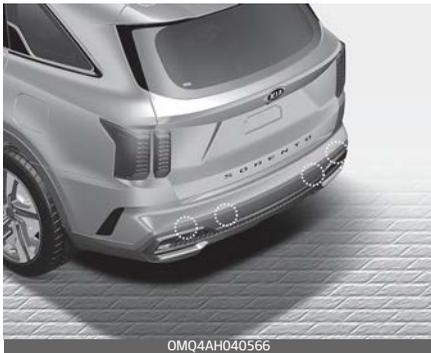
Die hinteren Ultraschallsensoren befinden sich innerhalb des hinteren Stoßfängers, um Gegenstände im rückwärtigen Bereich zu erfassen.
