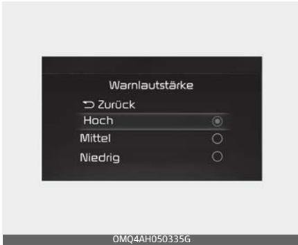
Wählen Sie, wenn der Engine Start/ Stop-Knopf in Position ON steht, im Einstellungsmenü die Option „Fahrerassistenz → Warnungslautstärke“, um die Warnlautstärke für den Spurhalteassistenten auf „Hoch“, „Mittel“, „Niedrig“ oder „Aus“ zu ändern.
