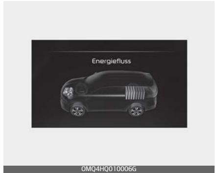
Wenn das Fahrzeug angehalten wurde, wird die Hochvoltbatterie vom Verbrennungsmotor aufgeladen. (Verbrennungsmotor → Batterie)
