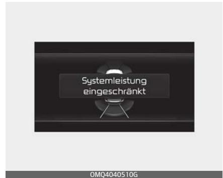
Wenn der Kollisionsvermeidungsassistent beim Rückwärtseinparken oder andere verwandte Systeme nicht ordnungsgemäß funktionieren, erscheint die Warnmeldung „Kollisionsvermeidungsassistent beim Parken prüfen“ auf dem Kombiinstrument, und die Funktion schaltet sich automatisch aus. Lassen Sie Ihr Fahrzeug von einem Kia-Vertragshändler inspizieren.
