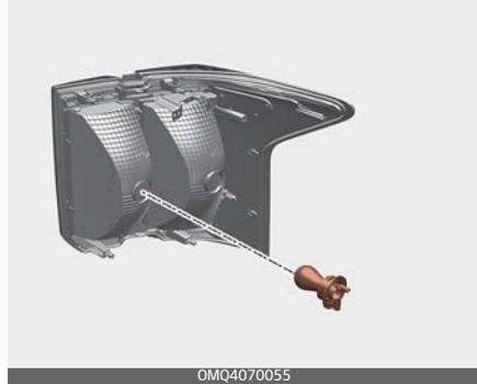
8. Entnehmen Sie die Glühlampe aus der Fassung, indem Sie die Glühlampe niederdrücken und gegen den Uhrzeigersinn drehen, bis ihre Rastnasen auf die Aussparungen in der Lampenfassung ausgerichtet sind. Ziehen Sie die Glühlampe aus der Fassung.
