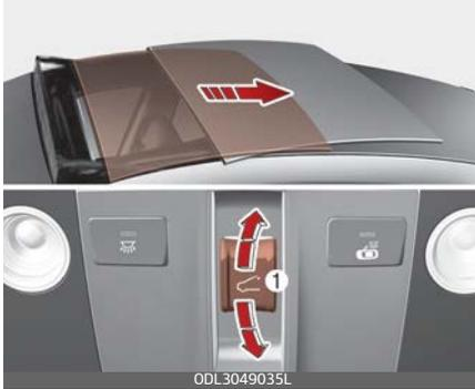
Wenn Sie den Hebel zur Bedienung des Schiebedachs (1) nach hinten in die zweite Rastung ziehen, wird der Sonnenschutz vollständig geöffnet, und das Schiebedach öffnet sich vollständig. Um die Schiebedachbewegung anzuhalten, ziehen oder drücken Sie kurz am Hebel zur Bedienung des Schiebedachs (1).
