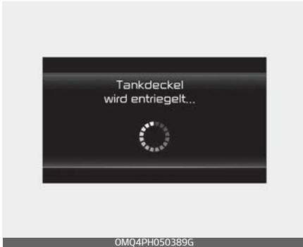
3. Die Tankklappe ist entriegelt, wenn die Meldung angezeigt wird.
