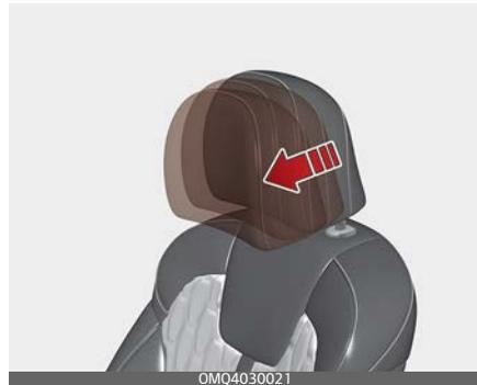
Die Kopfstütze kann nach vorn in 3 verschiedene Stellungen gebracht werden, indem Sie die Kopfstütze in die gewünschte Stellung nach vorn ziehen.
