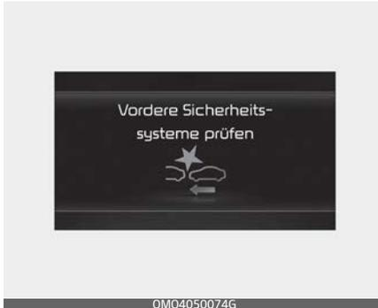
Wenn der Frontalkollisionsvermeidungsassistent nicht richtig funktioniert, erscheint die Warnmeldung „Kollisionssicherheitssystem in Fahrtrichtung prüfen“, und die Warnleuchten (⚠) und (🚗) am Kombiinstrument leuchten auf. Lassen Sie die Funktion von einem Kia-Vertragshändler überprüfen.
