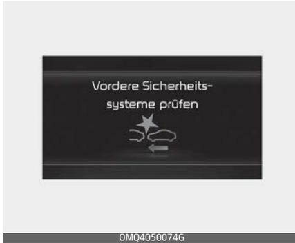
Wenn der Frontkollisionsvermeidungsassistent nicht richtig funktioniert, erscheint die Warnmeldung „Kollisionssicherheitssystem in Fahrtrichtung prüfen“, und die Warnleuchten (⚠️) und (🚗) am Kombiinstrument leuchten auf. Lassen Sie die Funktion von einem Kia-Vertragshändler überprüfen.
