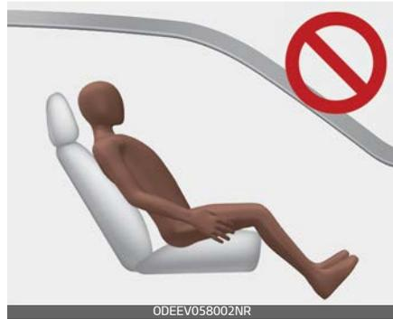
Wenn eine Rückenlehne bei einem Unfall weit nach hinten geneigt ist, können die Hüften des Insassen unter dem Beckengurtband durchrutschen, so dass eine große Kraft auf den ungeschützten Unterleib einwirken kann. Dies könnte zu schweren oder tödlichen Verletzungen führen. Der Fahrer muss die Insassen anweisen, die Rückenlehne während der Fahrt in aufrechter Stellung zu halten.
