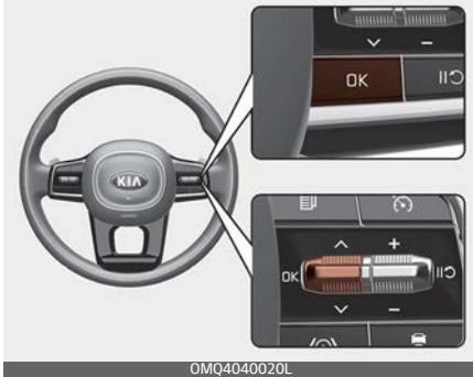
1. Deaktivieren Sie AUTO HOLD und lösen Sie die Feststellbremse, wenn der Start-/Stopp-Knopf auf ON steht.
