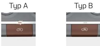
Wenn die Frischlufftposition ausgewählt ist, tritt Luft von außen in das Fahrzeug ein und wird gemäß der ausgewählten Funktion erwärmt oder gekühlt.
