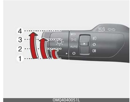
Zur Steuerung der Beleuchtung stellen Sie den Drehknopf am Blinkerhebel auf eine der folgenden Positionen:
