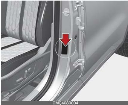
Alle Spezifikationen (Größen und Druckwerte) finden Sie auf einem Aufkleber am Fahrzeug.
