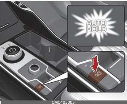
Bevor Auto Hold eingreift, müssen die Fahrertür, die Heckklappe und die Motorhaube geschlossen sein.
