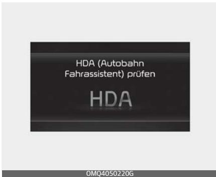
Wenn der Autobahn-Fahrassistent nicht richtig funktioniert, erscheint die Warnmeldung „Autobahn-Fahrassistent (HDA) prüfen“ und die Warnleuchte (⚠️) am Kombiinstrument leuchtet auf. Lassen Sie die Funktion von einem Kia-Vertrags-händler überprüfen.
