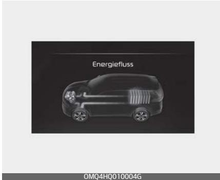
Das Hybridsystem informiert den Fahrer über den Energiefluss in den verschiedenen Betriebsarten. Während der Fahrt wird der aktuelle Energiefluss in 11 Modi angegeben.
