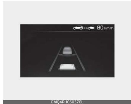
Wenn Sie bei eingeschalteter intelligenter Tempomatsteuerung zwi- schendurch beschleunigen möchten, treten Sie das Gaspedal. Während die Geschwindigkeit steigt, blinken die eingestellte Geschwindigkeit, der Abstand und die Zielgeschwindigkeit am Kombiinstrument.
