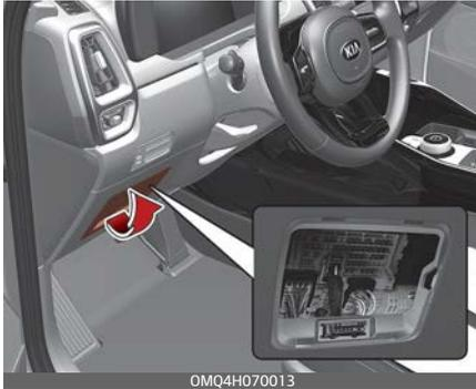
3. Ziehen Sie die vermutlich schadhafte Sicherung gerade aus ihrem Sockel. Verwenden Sie das Ausbauwerkzeug aus dem Hauptsicherungskasten im Motorraum.
