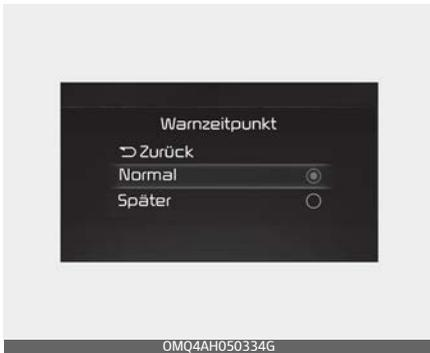
Wählen Sie, wenn der Start-/Stopp-Knopf in Position ON steht, im Einstellungsmenü die Option „Fahrerassistenz → Warnzeit“ aus, um die erste Warnaktivierung für das Querverkehrssicherheitssystem zu ändern.
