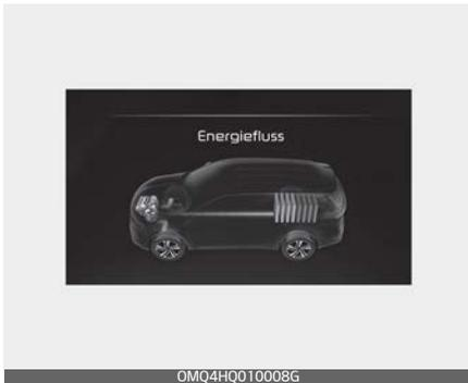
Der Verbrennungsmotor dient gleichzeitig als Antrieb des Fahrzeugs und zum Aufladen der Hochvoltbatterie.
