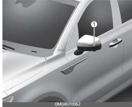
Wenn die seitliche Blinkleuchte (LED) (1) nicht funktioniert, lassen Sie das Fahrzeug von einer Fachwerkstatt überprüfen.
