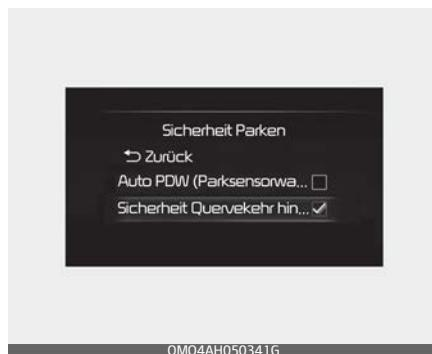
Wählen Sie, wenn der Start-/Stopp-Knopf in Position ON steht, im Einstellungsmenü die Option „Fahrerassistenz → Parksicherheit → Sicherheit Querverkehr hinten“, um das Querverkehrsicherheitssystem einzuschalten bzw. zu deaktivieren.
