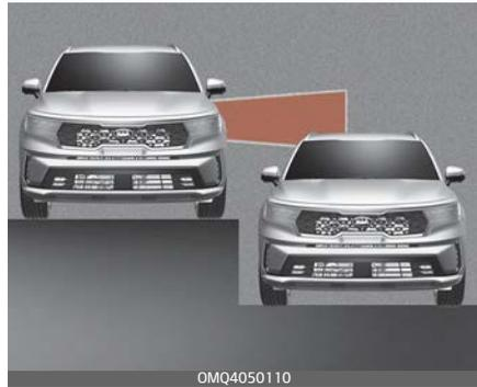
Das Totwinkel-Sicherheitssystem funktioniert möglicherweise nicht richtig, wenn die Spuren während der Fahrt abweichende Höhen haben. In manchen Fällen kann das System ein Fahrzeug auf einer Straße mit unterschiedlichen Fahrspurhöhen nicht erkennen (an Unterführungs-Verbindungsabschnitten, kreuzungsfreien Abschnitten usw.). Achten Sie während der Fahrt immer auf die Straßen- und Fahrbedingungen.
