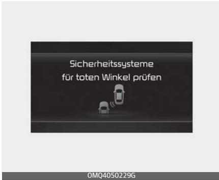
Wenn das Totwinkel-Sicherheitssystem nicht richtig funktioniert, erscheint die Warnmeldung „Totwinkel-Sicherheitssystem prüfen“ auf dem Kombiinstrument, und das System schaltet sich automatisch aus oder wird in der Funktionalität eingeschränkt. Lassen Sie die Funktion von einem Kia-Vertragshändler überprüfen.
