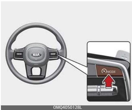
2. Drücken Sie bei der gewünschten Geschwindigkeit die Fahrassistenz-Taste (MODE). Die Sollgeschwindigkeit und die Tempomatanzeige (CRUISE)
