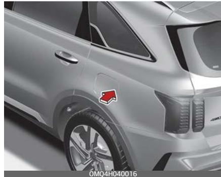
4. Ziehen Sie an der Tankklappe (1), um diese ganz zu öffnen.
