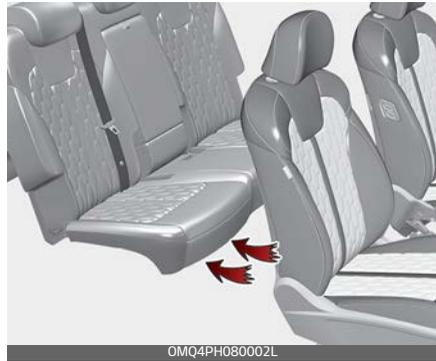
Der Kühlkanal für die Hybridbatterie befindet sich rechts unter den Vordersitzen. Der Kühlkanal kühlt die Hybridbatterie. Wenn der Kühlkanal der Hybridbatterie blockiert ist, kann die Hybridbatterie überhitzt werden.
