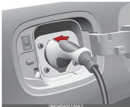
Stecken Sie dann das Ladegerät in die Ladebuchse, bis Sie ein Klickgeräusch hören. Wenn das Kabel nicht richtig angeschlossen ist, kann ein schlechter Kontakt zwischen dem Ladestecker und den Ladekontakten zu einem Brand führen.
