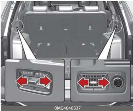
Zusätzlich können Sie an diesen Düsen die Richtung des Luftstroms durch Betätigung des Einstellhebels verändern (siehe Abbildung).
