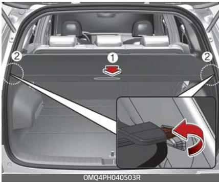
1. Ziehen Sie die Kofferraumabdeckung mit dem Griff (1) in Richtung Fahrzeugheck.
