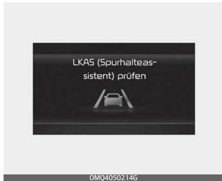
Wenn der Spurhalteassistent nicht richtig funktioniert, erscheint die Warnmeldung „Spurhalteassistent (LKA) überprüfen“, und die gelbe Kontrollleuchte (🚗) am Kombiinstrument leuchtet auf. Wenn dieser Fall auftritt, lassen Sie die Funktion von einer Kia-Vertragswerkstatt überprüfen.
