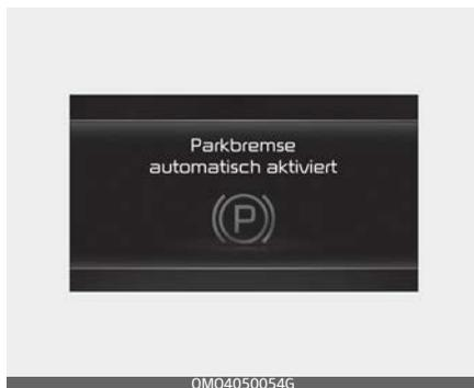
Wenn der Wechsel von Auto Hold (automatisches halten) zu EPB nicht ordnungsgemäß funktioniert, ertönt ein Warnsignal, und es erscheint eine Meldung.
