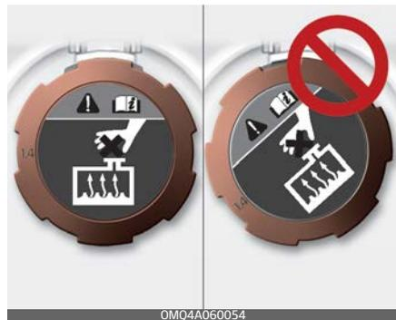
2. Stellen Sie sicher, dass die kleinen Nasen im Motorkühlerdeckel sicher eingerastet sind.
