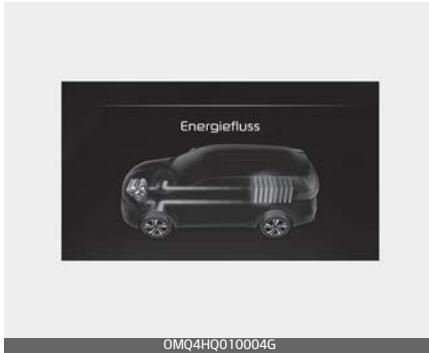
Strom vom Elektromotor und Verbrennungsmotor werden für den Antrieb des Fahrzeugs verwendet. (Batterie & Verbrennungsmotor → Rad)
