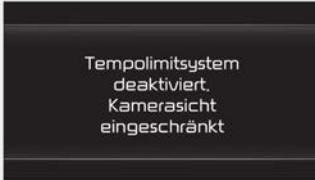
Wenn die vordere Windschutzscheibe dort, wo sich die Frontkamera befindet, mit Fremdkörpern wie Schnee oder Regen bedeckt ist, kann sich die Erkennungsleistung verschlechtern und die Funktion des intelligenten Geschwindigkeitsbegrenzungsassistenten vorübergehend eingeschränkt oder deaktiviert werden.
