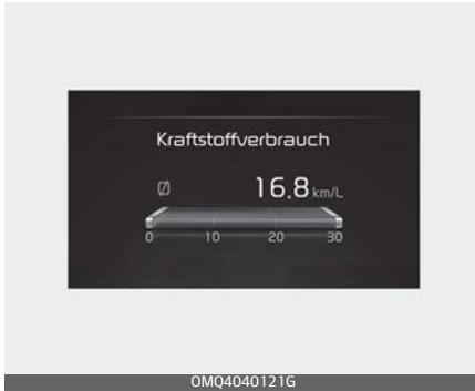
Der Trip-Computer zeigt Fahrdaten des Fahrzeugs an, zum Beispiel den Kraftstoffverbrauch, die Fahrkilometer und die Fahrzeuggeschwindigkeit.
