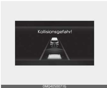
Bei aktiver intelligenter Tempomatsteuerung erscheint bei hohem Kollisionsrisiko mit dem vorausfahrenden Fahrzeug die Warnmeldung „Kollisionswarnung“ auf dem Kombiinstrument und der Fahrer wird durch einen Warnton gewarnt. Achten Sie immer auf die Straßen- und Verkehrsverhältnisse und betätigen Sie ggf. das Bremspedal, um die Fahrgeschwindigkeit zu verringern und einen Sicherheitsabstand einzuhalten.
