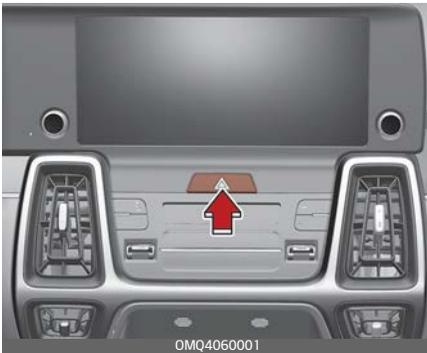
Sie sollte verwendet werden, wenn Notreparaturen durchgeführt werden oder wenn das Fahrzeug am Straßenrand angehalten wurde.
