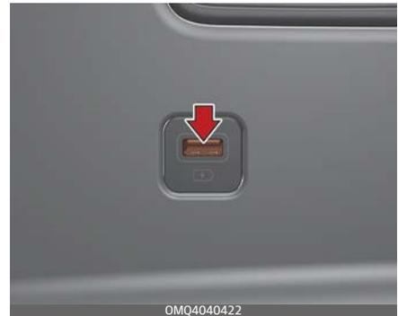
Der Ladevorgang beginnt, sobald Sie das Kabel mit dem USB-Anschluss verbinden.
