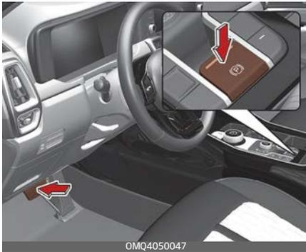
Feststellbremse mit dem EPB-Schalter lösen
