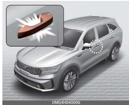
Wenn alle Türen (und der Kofferraum) geschlossen und verriegelt sind, leuchtet die Türgriffleuchte ca. 15 Sekunden auf, wenn eine der folgenden Aktionen durchgeführt wird:
