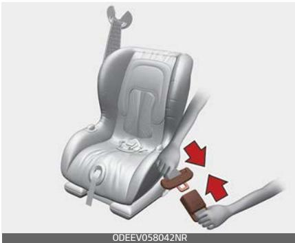
3. Sorgen Sie für eine möglichst hohe Gurtspannung, indem Sie das Kinderrückhaltesystem beim Aufrollen des Schultergurtes hinunterdrücken.
