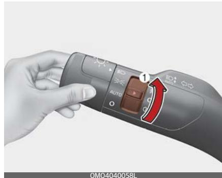
Die Nebelscheinwerfer leuchten auf, wenn der Nebelscheinwerferschalter (1) bei eingeschalteten Scheinwerfern in die Position ON gedreht wird.
