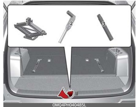
Wagenheber, Wagenheberkurbel und Radmutternschlüssel befinden sich im Kofferraum.
