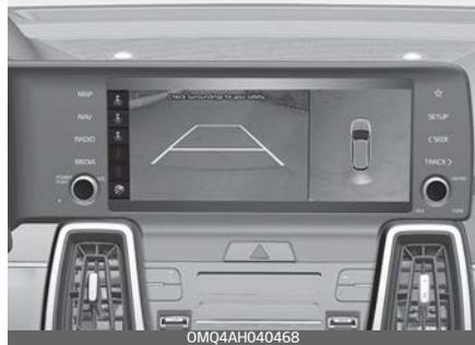
Der Umgebungsüberwachungs-Monitor soll beim Einparken helfen, indem er dem Fahrer den Bereich um das Fahrzeug herum anzeigt.
