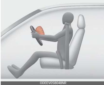
Die beiden Airbagmodule befinden sich in der Mitte des Lenkrads und im Armaturenbrett über dem Handschuhfach. Wenn das SRS-Steuermodul einen ausreichend schweren Aufprall an der Fahrzeugfront erkennt, löst es automatisch die Frontairbags aus.
