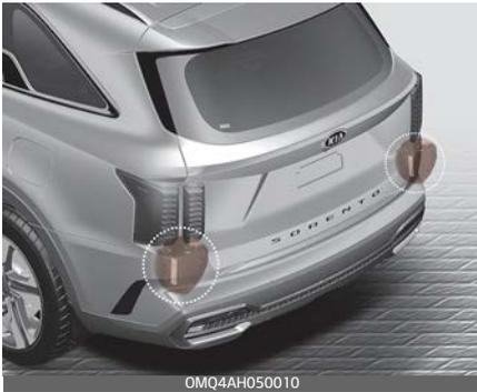
Die genaue Position des Detektors ist im Bild oben zu sehen.
