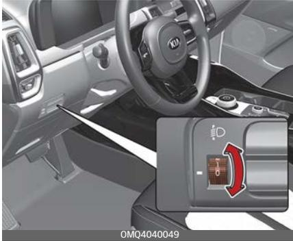
Um die Leuchtwerte entsprechend der Anzahl der Insassen und dem zugelassenen Gewicht im Kofferraum einzustellen, drehen Sie das Stellrad.
