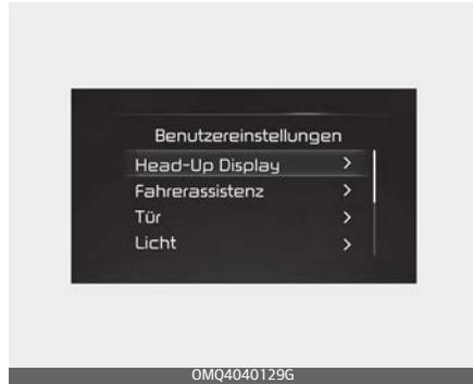
In diesem Modus können Sie die Einstellungen des Kombiinstruments der Türen, Lampen usw. ändern.
