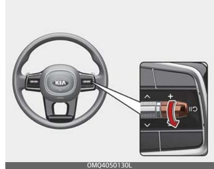
3. Die eingestellte Geschwindigkeitsbegrenzung wird auf dem Kombiinstrument angezeigt. Dann blinkt die eingestellte Höchstgeschwindigkeit und es ertönt ein Warnsignal, bis Sie wieder die Höchstgeschwindigkeit einhalten.
