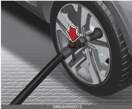
4. Drehen Sie die Ventilkappe vom Ventil des defekten Reifens ab und schrauben Sie den Füllschlauch der Dichtmittelflasche auf das Ventil.
