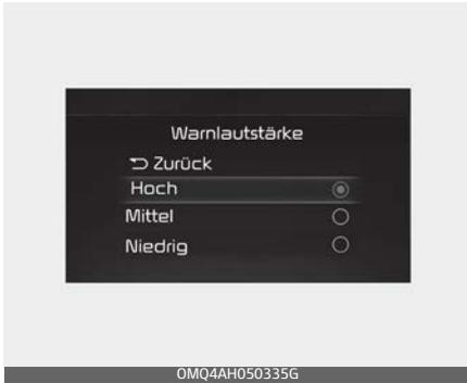
Wählen Sie, wenn der Engine Start/ Stop-Knopf in Position ON steht, im Einstellungsmenü die Option „Fahrerassistenz → Warntonlautstärke“, um die Warntonlautstärke für das Totwinkel-Sicherheitssystem auf „Hoch“, „Mittel“, „Niedrig“ oder „Aus“ zu ändern.
