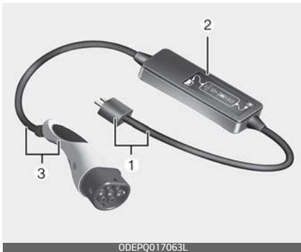
Das Erhaltungsladegerät kann verwendet werden, wenn das Wechselstromladegerät nicht verfügbar ist.
