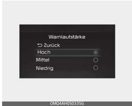
Wenn der Engine Start/Stop-Knopf in der Position ON ist, wählen Sie „Fahrerassistenz → Warntonlautstärke“ aus dem Einstellungsmenü, um die Lautstärke der Warnung für den Frontalkollisionsvermeidungsassistenten auf „Hoch“, „Mittel“, „Niedrig“ oder „Aus“ zu ändern.
