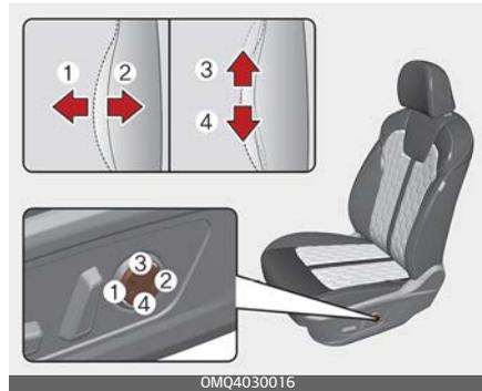
Die Lordosenstütze kann durch Drücken des Schalters für die Lordosenstütze an der Seite des Sitzes eingestellt werden.
