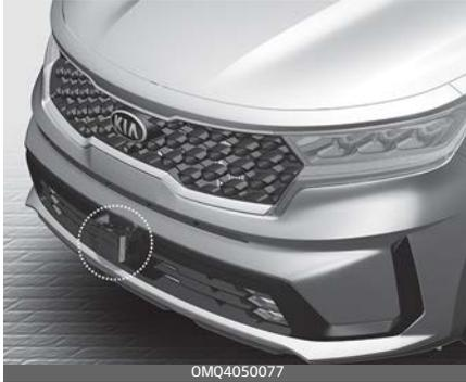
Frontkamera und Frontradar werden als -Erkennungssensor zur Erkennung von vorausfahrenden Fahrzeugen eingesetzt.
