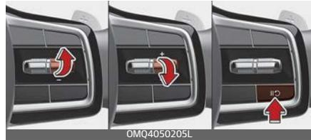
Um den manuellen Geschwindigkeitsbegrenzungsassistenten nach Deaktivierung des Systems wieder zu aktivieren, drücken Sie den Schalter +, -, (|| C).
