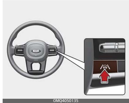
Drücken Sie, wenn der Engine Start/Stop-Knopf in Position ON steht, die Spursicherheitstaste auf der Instrumententafel, um den Spurhalteassistenten einzuschalten. Die weiße Kontrollleuchte (🚗) leuchtet auf dem Kombiinstrument auf.
