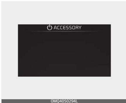
Drücken Sie den Start-/Stopp-Knopf, wenn er sich in der Position OFF befindet, ohne das Bremspedal zu betätigen.
