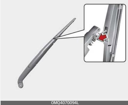
Wenn der Austausch abgeschlossen ist, setzen Sie den Wischerarm wieder auf die Heckscheibe und schalten Sie die Fahrzeugzündung ein. Betätigen Sie den Wischer, um zu prüfen, dass das Blatt ordnungsgemäß montiert ist.
