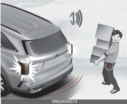
Die Warnblinker leuchten, das akustische Signal ertönt sechsmal, dann öffnet sich langsam die Heckklappe.
