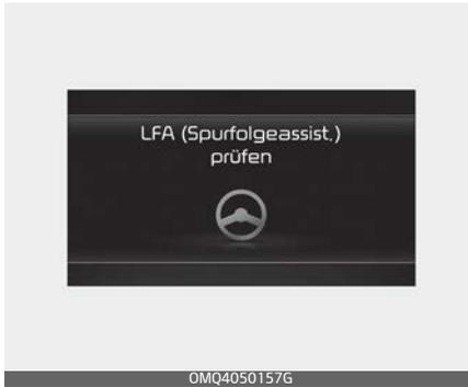
Wenn der Spurhalteassistent nicht richtig funktioniert, erscheint die Warnmeldung „Spurhalteassistent (LFA) überprüfen“ auf dem Kombiinstrument. Wenn dieser Fall auftritt, lassen Sie die Funktion von einer Kia-Vertragswerkstatt überprüfen.
