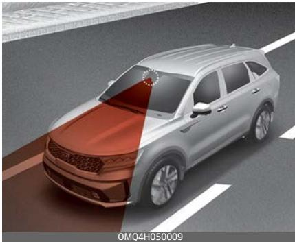
Die Frontkamera wird als Erkennungssensor für Fahrbahnmarkierungen (oder Straßenränder) und vorausfahrende Fahrzeuge verwendet.
