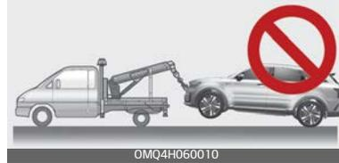
Es ist möglich, ein Fahrzeug mit Vorderachsantrieb auf mitrollenden Hinterrädern (ohne Nachläufer) abzuschleppen, wenn die Vorderräder angehoben sind.
