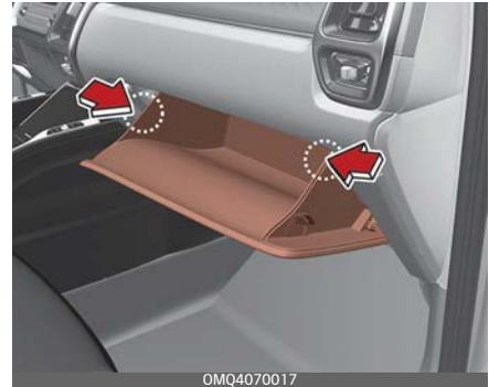
3. Bauen Sie das Filtergehäuse aus, indem Sie an beiden Seiten des Filtergehäuses ziehen.
