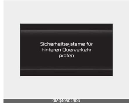
Wenn das hintere Querverkehr-Erkennungssystem nicht richtig funktioniert, erscheint die Warnmeldung „Hinteres Querverkehr-Erkennungssystem prüfen“ auf dem Kombiinstrument, und die Funktion schaltet sich automatisch aus oder wird in ihrer Funktionalität eingeschränkt. Lassen Sie die Funktion von einem Kia-Vertragshändler überprüfen.
