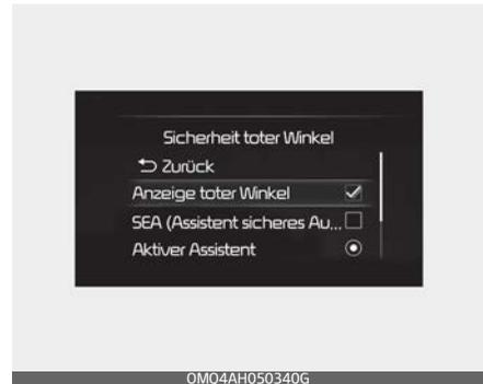
Wählen Sie, wenn der Start/Stop-Knopf in Position ON steht, im Einstellungs Menü die Option „Fahrerassistenz → Totwinkel-Sicherheit → Totwinkel-Erkennung“ aus, um den Totwinkel-Monitor einzuschalten, oder wählen Sie sie ab, um das System auszuschalten.
