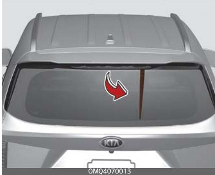
Fahren Sie den Heckscheibenwischer zum unteren mittleren Bereich und heben Sie den Wischerarm an. Ziehen Sie am Wischerblatt, um es auszubauen.
