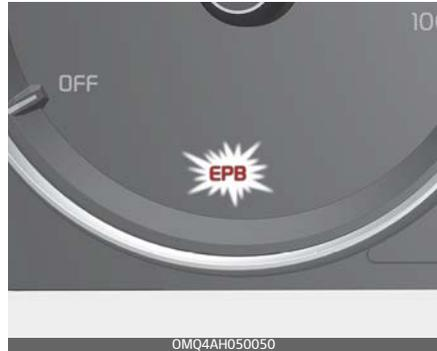
Wenn die EPB-Störungsleuchte weiter leuchtet oder beim Fahren aufleuchtet oder beim Einschalten des Start-/Stopp-Knopfes nicht erlischt, liegt ein Problem mit der elektrischen Feststellbremse vor.
