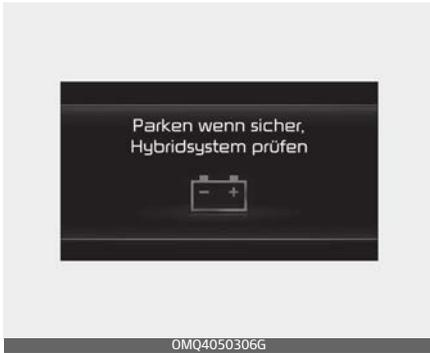
Diese Meldung wird angezeigt, wenn ein Problem mit dem Hybridkontrollsystem besteht. Die Kontrollleuchte "🔋" blinkt und es ertönt ein akustisches Warnsignal, bis das Problem behoben ist. Fahren Sie nicht, wenn diese Warnmeldung angezeigt wird.
