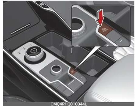
Jedes Mal, wenn Sie die Taste [EV/HEV] drücken, wird der Plug-in-Hybridsystem-Fahrmodus in folgender Reihenfolge geändert:
