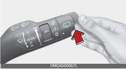
Der Sprüh- und Wischvorgang wird fortgesetzt, bis Sie den Hebel freigeben.
