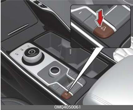
Die Bergab-Bremskontrolle (DBC) unterstützt den Fahrer bei Herabfahren einer steilen Neigung, ohne dass er dabei das Bremspedal betätigen muss.
