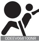
Die Airbag-Warnleuchte im Kombiinstrument soll Sie warnen, wenn mögliche Probleme mit Ihrem Airbag – SRS-System (ergänzendes Rückhaltesystem) auftreten.
