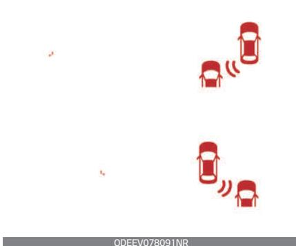
Wenn ein Fahrzeug innerhalb der Grenzen des Systems erkannt wird, leuchtet eine Warnleuchte an den Außenspiegeln.
