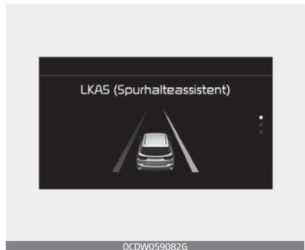
Wenn die Geschwindigkeit des Fahrzeugs über 60 km/h liegt und das System die Fahrspurmarkierung erkennt, ändert sich die Farbe von grau in weiß.
