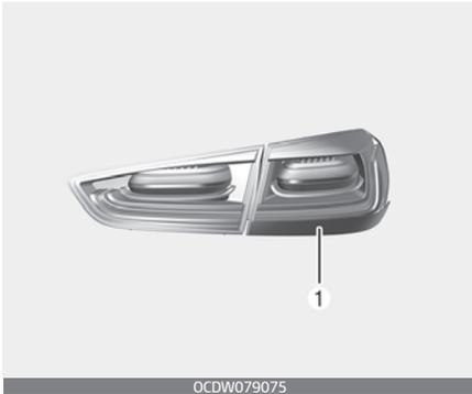
**Nebelschlussleuchte (LED-Typ) Glühlampenwechsel - Heckkombileuchte für 5-Türer (Typ B), Shooting Brake**
