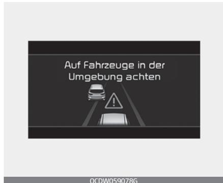
Wenn das vorausfahrende Fahrzeug (Fahrgeschwindigkeit: weniger als 30 km/h) in die Nachbarspur wechselt, ertönt das akustische Warnsignal und eine Meldung wird angezeigt. Passen Sie die Fahrzeuggeschwindigkeit an die Fahrzeuge oder Objekte an, die plötzlich vor Ihnen auftauchen können, indem Sie das Bremspedal entsprechend den Straßen- und Fahrbedingungen betätigen.
