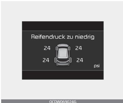
Wenn die Kontrollleuchten des Reifendruck-Überwachungssystems leuchten und eine Warnmeldung auf dem LCD-Display des Kombiinstruments angezeigt wird, ist der Reifendruck in mindestens einem Reifen zu niedrig. Die Positionskontrollleuchte für Reifen mit geringem Reifendruck zeigt an, in welchem Reifen der Reifendruck erheblich zu gering ist. Dazu wird die Position des Reifens durch eine Warnleuchte signalisiert.
