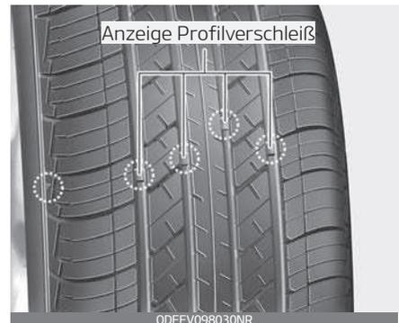
Sie zeigt an, dass die verbleibende Profiltiefe weniger als 1,6 mm beträgt. Ersetzen Sie den Reifen, sobald dies der Fall ist.
