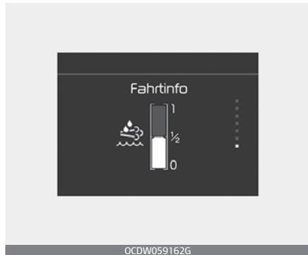
In diesem Modus wird die Restmenge des Harnstoffs im Harnstofftank angezeigt.
