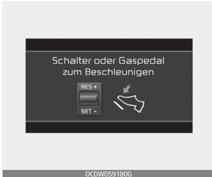
Benutzen Sie zur Beschleunigung den Schalter bzw. das Pedal.
