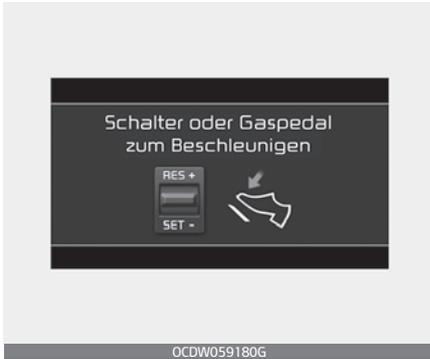
Wenn die intelligente Tempomatsteuerung in Betrieb ist, stoppt Ihr Fahrzeug hinter dem vorausfahrenden Fahrzeug, wenn dieses anhält. Die Meldung wird nach dem Stopp auf dem Kombiinstrument 3 Sekunden lang angezeigt; das System schaltet in den Standby-Betrieb.
