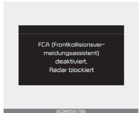
Wenn die Sensorabdeckung durch Schmutz, Schnee oder Schmutz blockiert ist, kann der FCA-Betrieb vorübergehend unterbrochen werden. In diesem Fall wird der Fahrer durch eine entsprechende Warnmeldung informiert.
