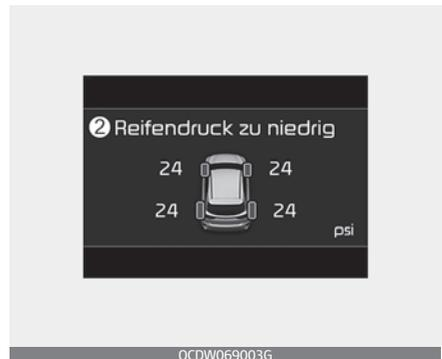
1. Positionsanzeige - zu geringer Reifendruck/Kontrollleuchte für TPMS-Fehlfunktion
