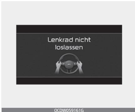
Wenn der Fahrer das Lenkrad mehrere Sekunden lang loslässt, während das LKAS aktiviert ist, warnt das System den Fahrer.
