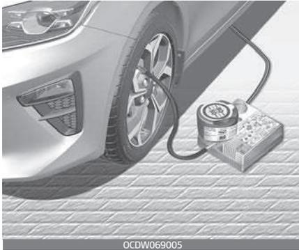
8. Achten Sie darauf, dass der Kompressor ausgeschaltet ist (Position 0).
