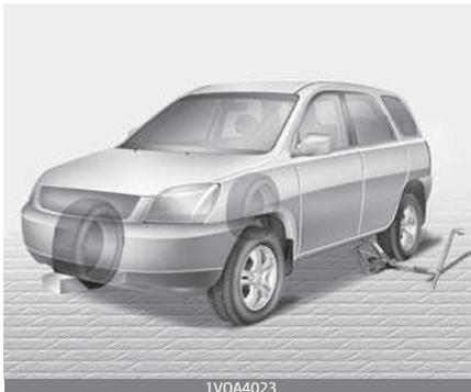
4. Nehmen Sie den Radmutterenschlüssel, den Wagenheber, die Wagenheberkurbel und das Ersatzrad aus dem Fahrzeug.
