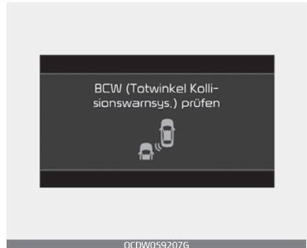
Wenn das System nicht ordnungsgemäß funktioniert, erscheint eine Warnmeldung und das Licht auf dem Schalter erlischt. Das System schaltet sich automatisch aus.
