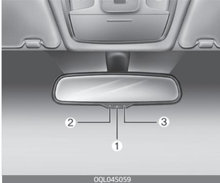
Der elektrische Innenspiegel regelt nachts oder im Halbdunkel automatisch das Blendlicht hinter Ihnen fahrender Fahrzeuge. Der Sensor (3) im Spiegelglas stellt die vorhandene Lichtintensität im Bereich Ihres Fahrzeugs fest und er regelt automatisch das Blendlicht hinter Ihnen fahrender Fahrzeuge.
