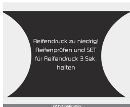
Wenn die Kontrollleuchten des Reifendruck-Überwachungssystems leuchten und eine Warnmeldung auf dem LCD-Display des Kombiinstrumentes angezeigt wird, ist der Reifendruck in mindestens einem Reifen zu niedrig. Die Anzeige für niedrigen Reifendruck zeigt an, bei welchem Reifen der Reifendruck deutlich niedrig ist.
