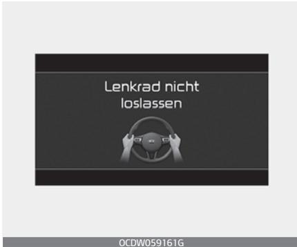
Wenn Sie während der Fahrt mit dem LFA-System zur Lenkassistentz die Hände vom Lenkrad nehmen, wird das Warnsignal für handlosen Betrieb ausgelöst.
