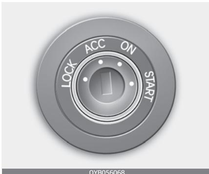
Das Lenkradschloss wird in dieser Stellung verriegelt (Diebstahlschutz). Der Zündschlüssel kann nur in der Stellung LOCK abgezogen werden.
