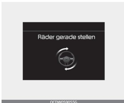
Beenden Sie das Einparken entsprechend den Anweisungen auf dem LCD-Display. Bedienen Sie gegebenenfalls manuell das Lenkrad und bringen Sie den Parkvorgang des Fahrzeugs zu Ende.
