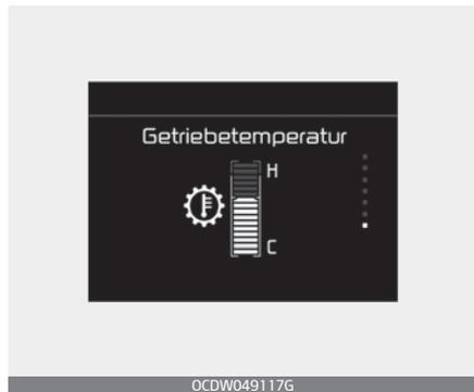
In diesem Modus wird die Getriebetemperatur angezeigt.
