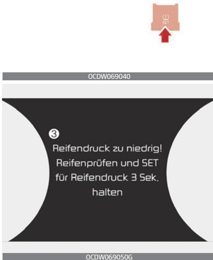
1. Positionsanzeige - zu geringer Reifendruck/Kontrollleuchte für TPMS-Fehlfunktion
