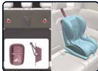
Sicherung mit oberem Halteband [4]
