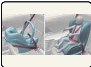
In Fahrrichtung/entgegen der Fahrrichtung befestigtes Kinderrückhaltesystem [4]
