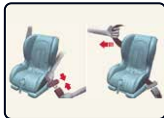
Befestigung eines Kinderrückhaltesystems mit Dreipunktgurt [4]
