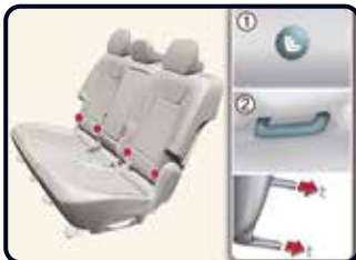
In Fahrrichtung/entgegen der Fahrrichtung befestigtes Kinderrückhaltesystem [4]
