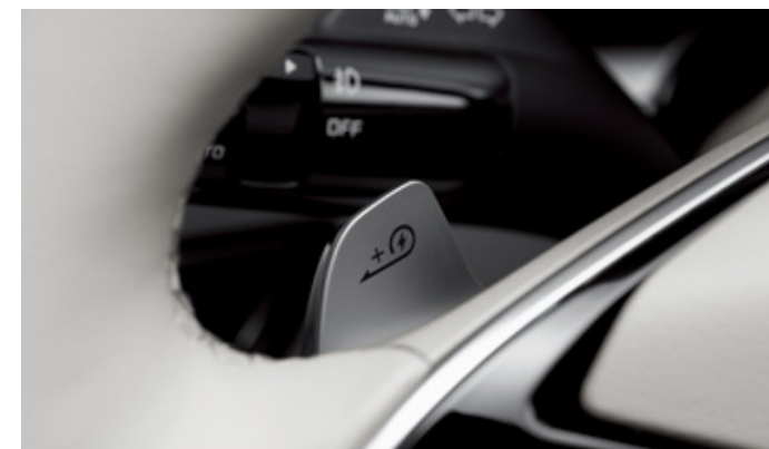
i-PEDAL 모드 가속페달만으로 가속과 감속, 정차까지 가능한 원 페달 모드입니다.
