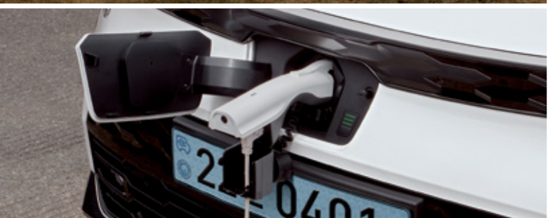
실외 V2L 커넥터 차량 충전구에 연결할 수 있는 커넥터를 통해 220V 전원을 연결, 야외활동 시에도 다양한 전자기기를 편리하게 사용할 수 있습니다.
