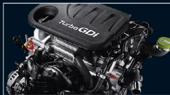
74kW, 172Nm 1.0L Petrol Turbo
