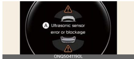
A: Ultrasonic sensor error or blockage
